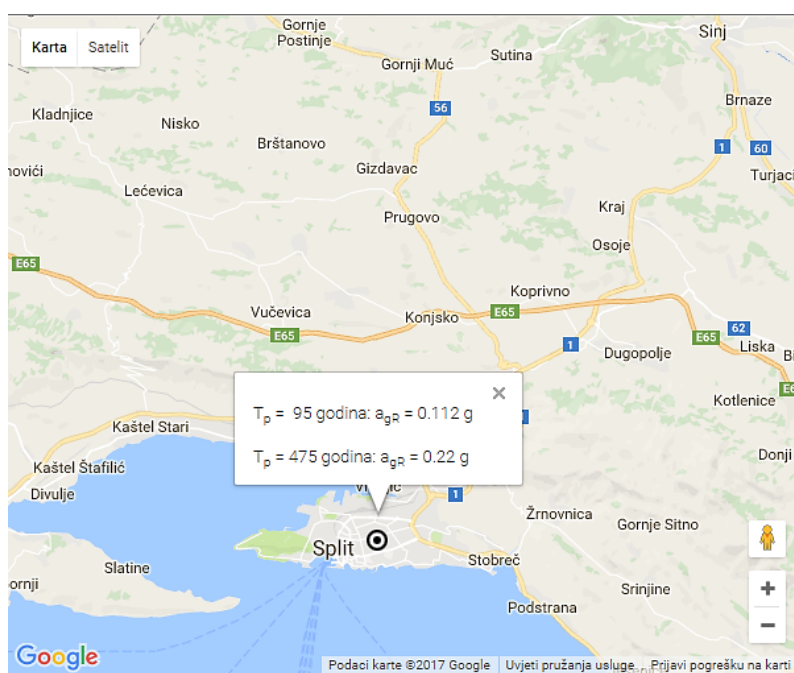
Slika 8.13 Parametar vršnog ubrzanja tla za promatranu lokaciju
