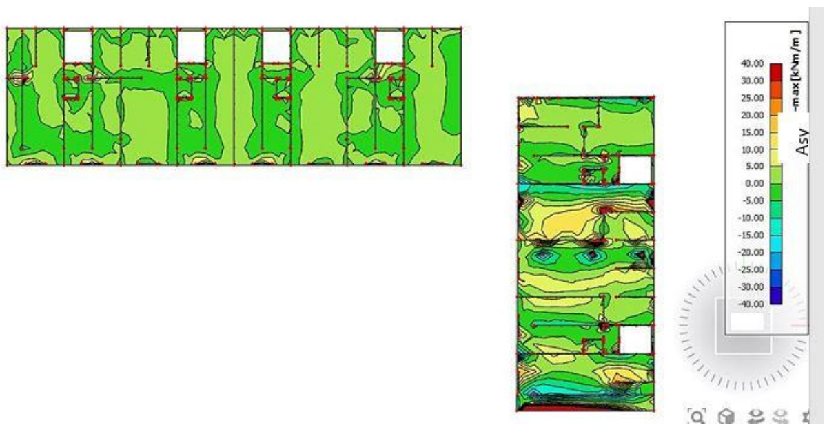
Slika 10.12. Prikaz potrebne armature A_{sy}
