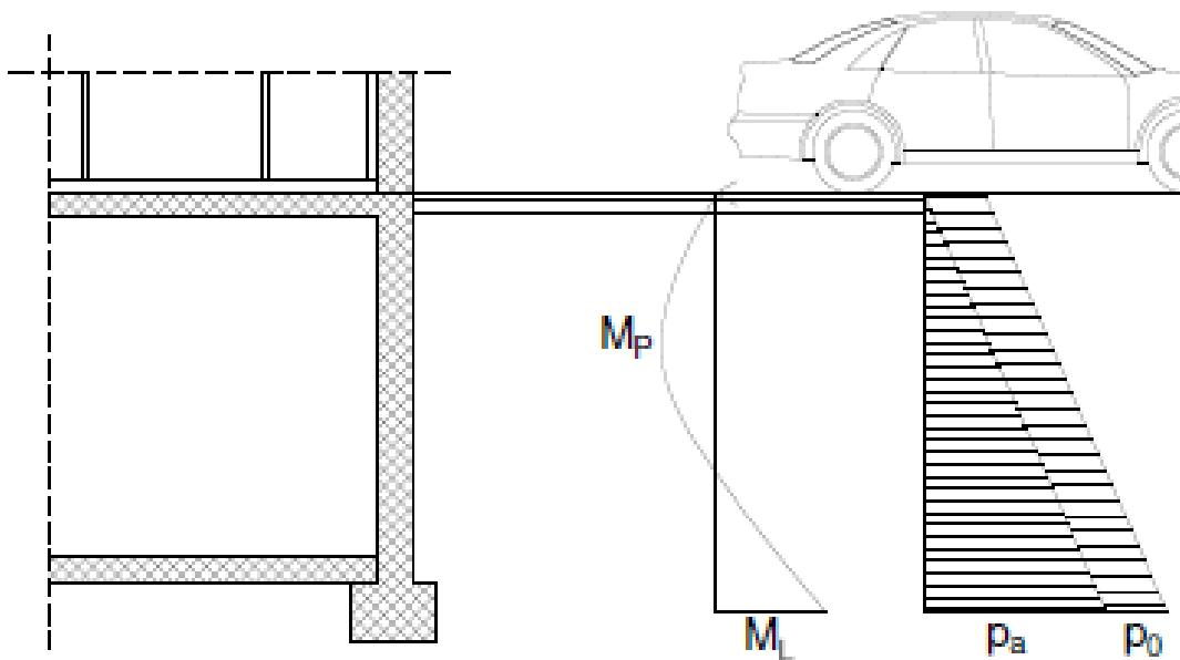
Slika 15.1. Prikaz opterećenja na obodni zid garaže
