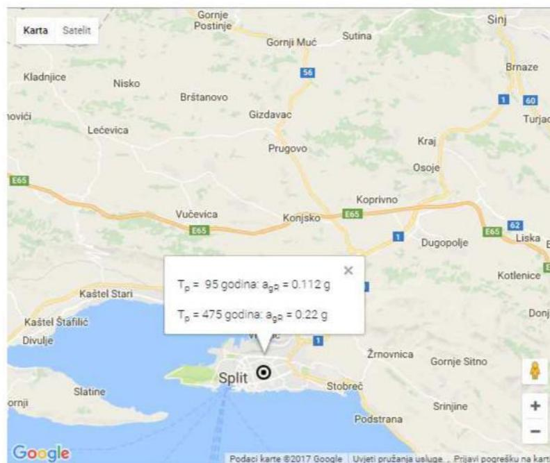
Slika 8.36. Očitano ubrzanje za područje grada Splita
