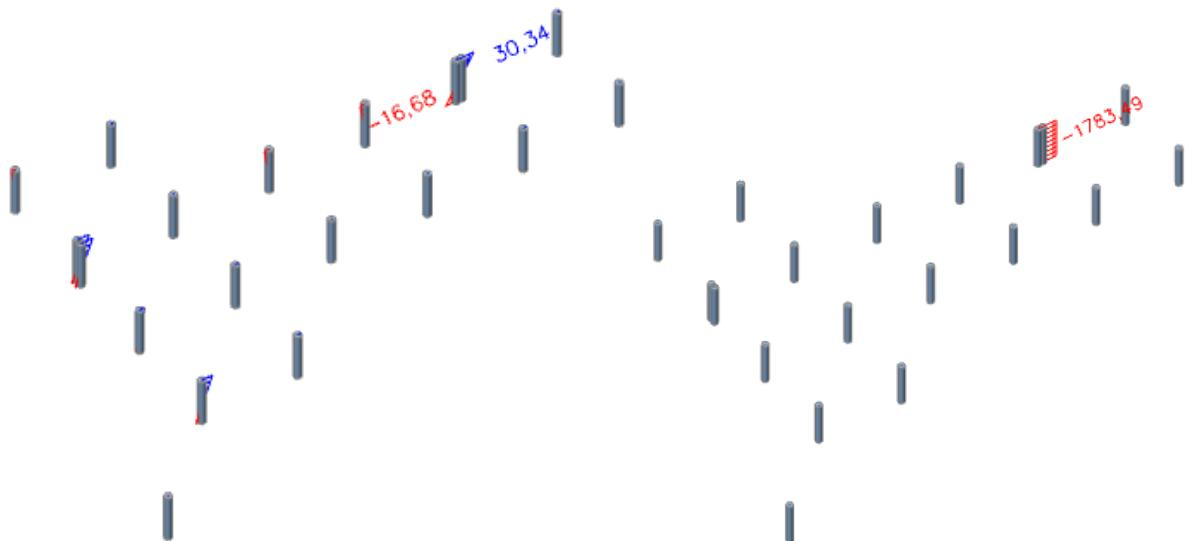
*12.1.1.2. Dimenzioniranje stupova na savijanje i uzdužnu silu*
