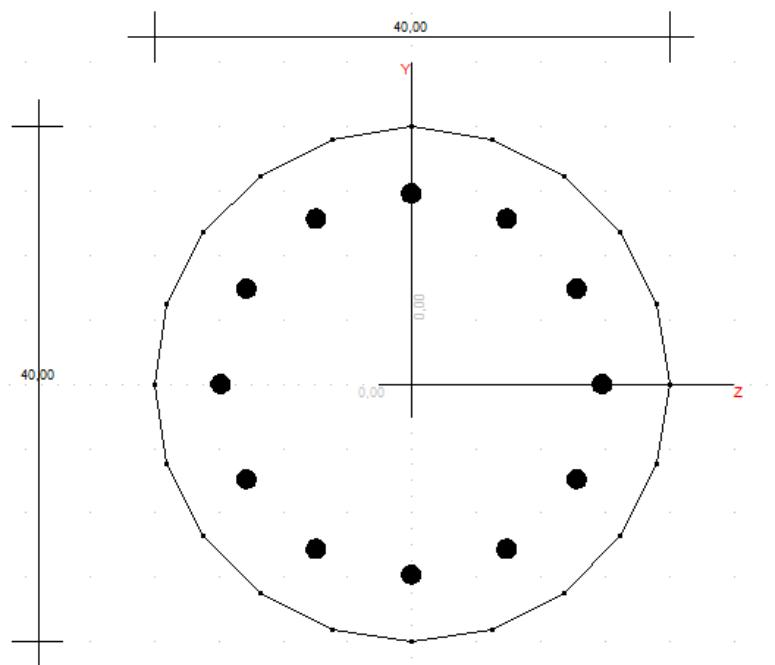
Slika 12.5. Poprečni presjek stupa
