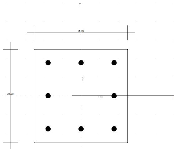
Slika 12.31. Poprečni presjek stupu
