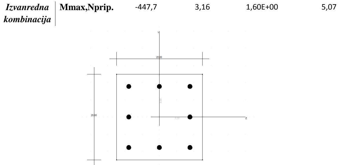
Slika 12.18. Poprečni presjek stupa
