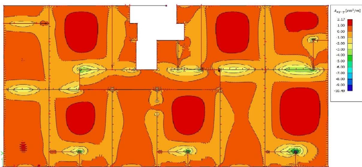
Slika 4.4. Armatura u ploči smjer y-y [ $\text{cm}^2/\text{m}$ ] za kombinaciju GSN
