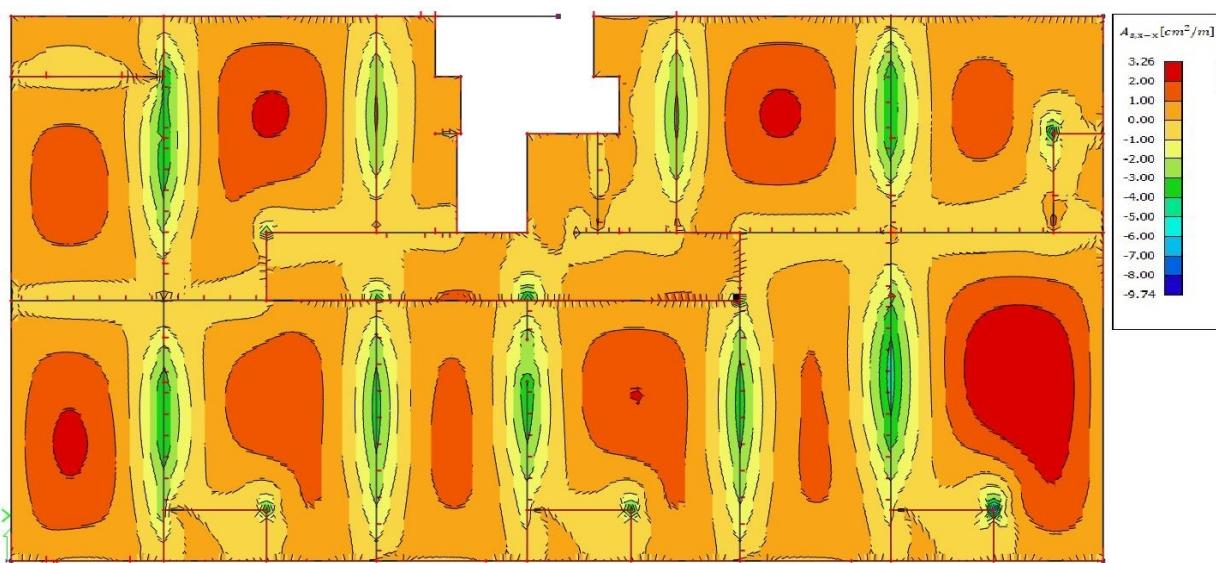
Slika 4.3. Armatura u ploči smjer x-x [ $\text{cm}^2/\text{m}$ ] za kombinaciju GSN
