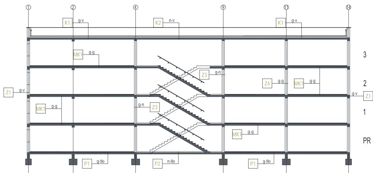
Slika 5.2. Karakteristični presjek s oznakama građevinskih dijelova
