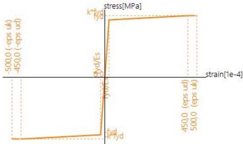
Slika 2.4. Radni dijagram čelika
