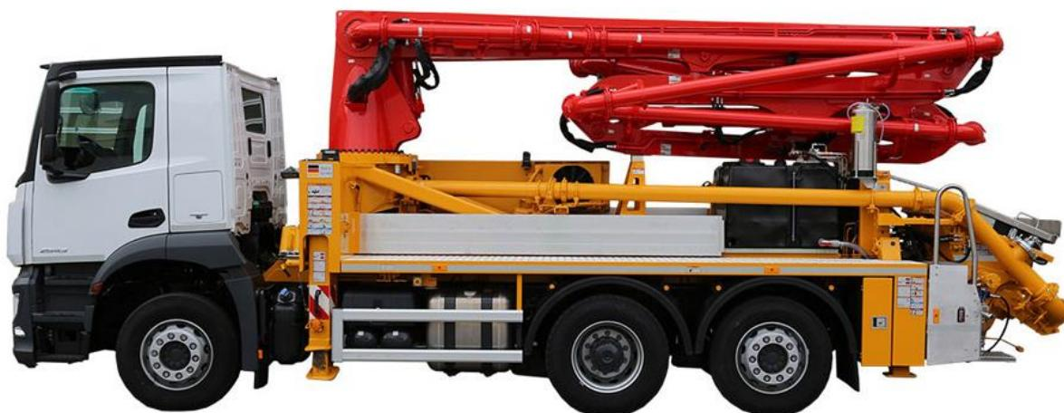
Slika 4.16. Pumpa za beton Putzmeister M20-4 [19]
