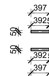
VERTIKALA (V2) 50X50X4, l=397mm, kom=2x11
