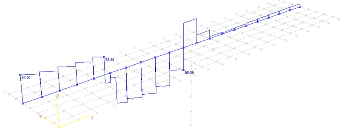
Slika 14: Pokretno opterećenje – maksimalni momenti u prvom polju – poprečne sile  $T_z$  (kN)
