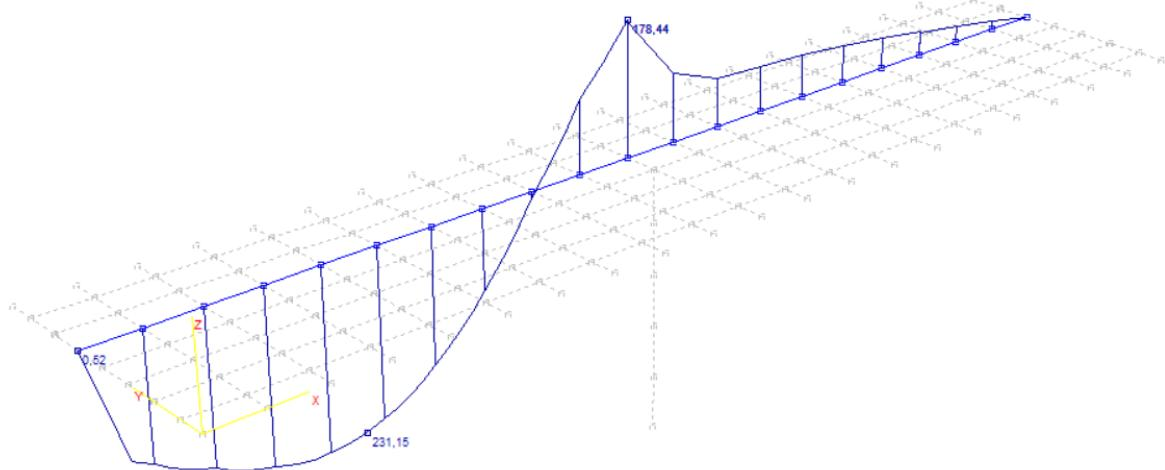
Slika 19: Pokretno opterećenje – maksimalne poprečne sile pri upornjaku – momenti  $M_y$  (kNm)
