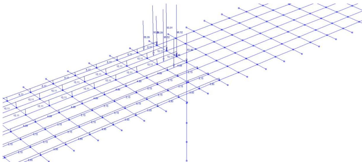
Slika 21: Pokretno opterećenje za maksimalnu poprečnu silu pri stupu
