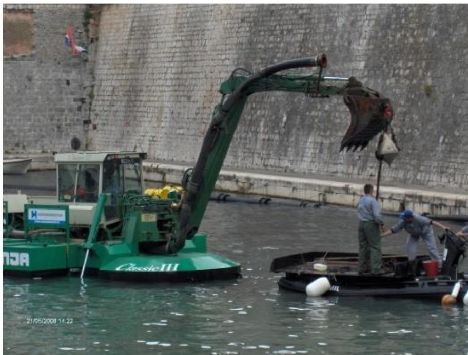
Slika 4.5. Plovno jaružalo WATERMASTER
