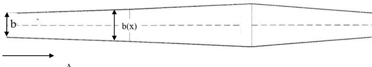
Slika 10. Ovisnost širine presjeka o stacionaži kanala.
