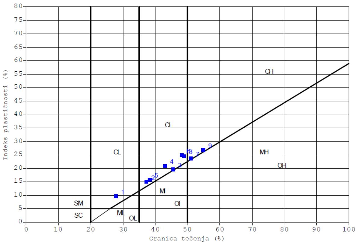
Slika 2.3. Grafički prikaz klasifikacije uzorka iz bušotine S-131-13-02 (A. Casagrande)
