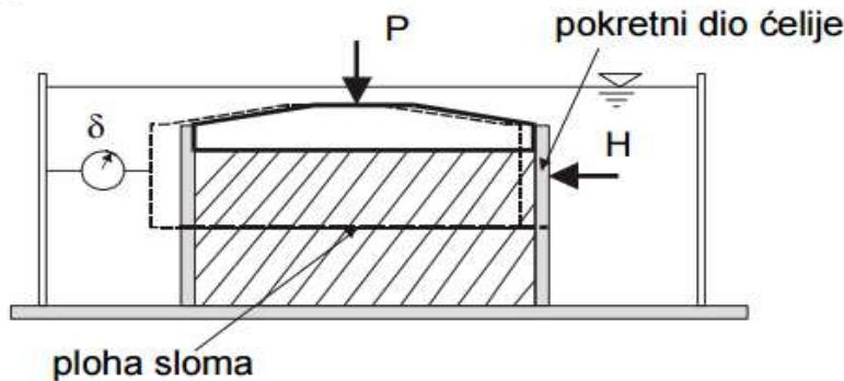
Slika 1.3. Princip rada čelije za pokus izravnog smicanja
