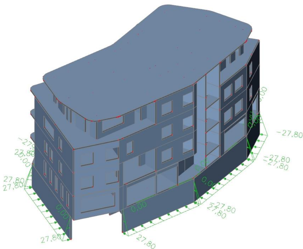
Slika 3.2. Prikaz opterećenja od tla na zidove garaže
