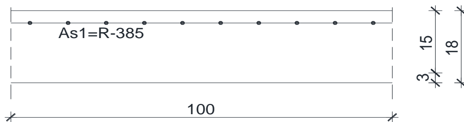
Slika 10.30 Skica armature ploče na ležaju
