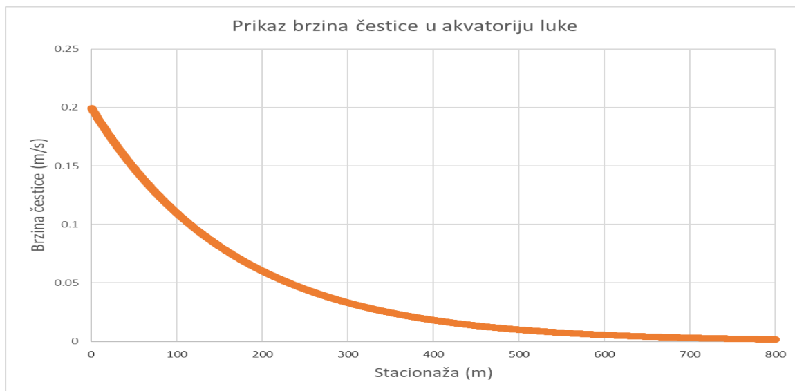
Slika 103. Prikaz brzina čestice u akvatoriju luke za prvi slučaj
