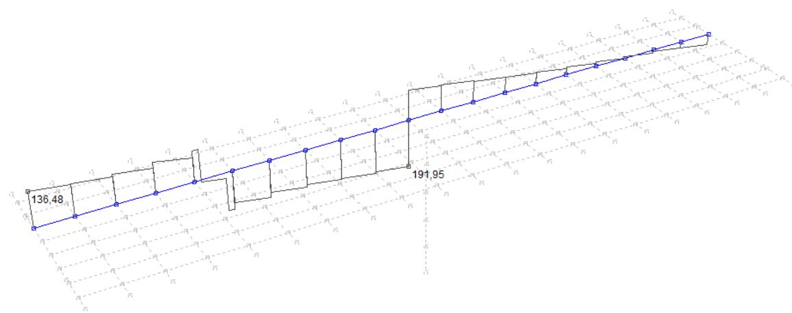
Slika 17: Pokretno opterećenje – maksimalni momenti pri stupu – poprečne sile  $V_z$  (kN)
