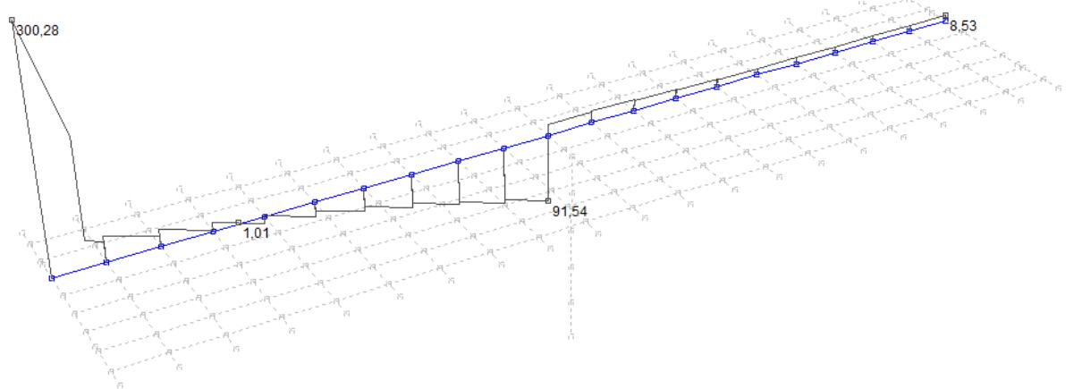
Slika 20: Pokretno opterećenje – maksimalne poprečne sile pri upornjaku – poprečne sile  $V_z$  (kN)
