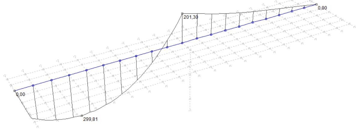
Slika 19: Pokretno opterećenje – maksimalne poprečne sile pri upornjaku – momenti  $M_y$  (kNm)
