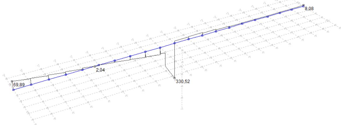
Slika 23: Pokretno opterećenje – maksimalne poprečne sile pri stupu – poprečne sile  $V_z$  (kN)
