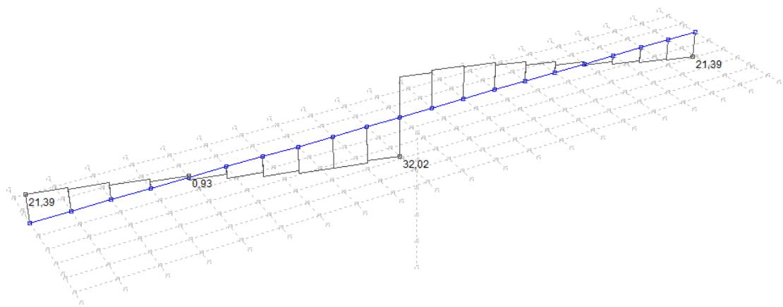
Slika 10: Dodatno stalno opterećenje – Poprečne sile  $V_z$  (kN)
