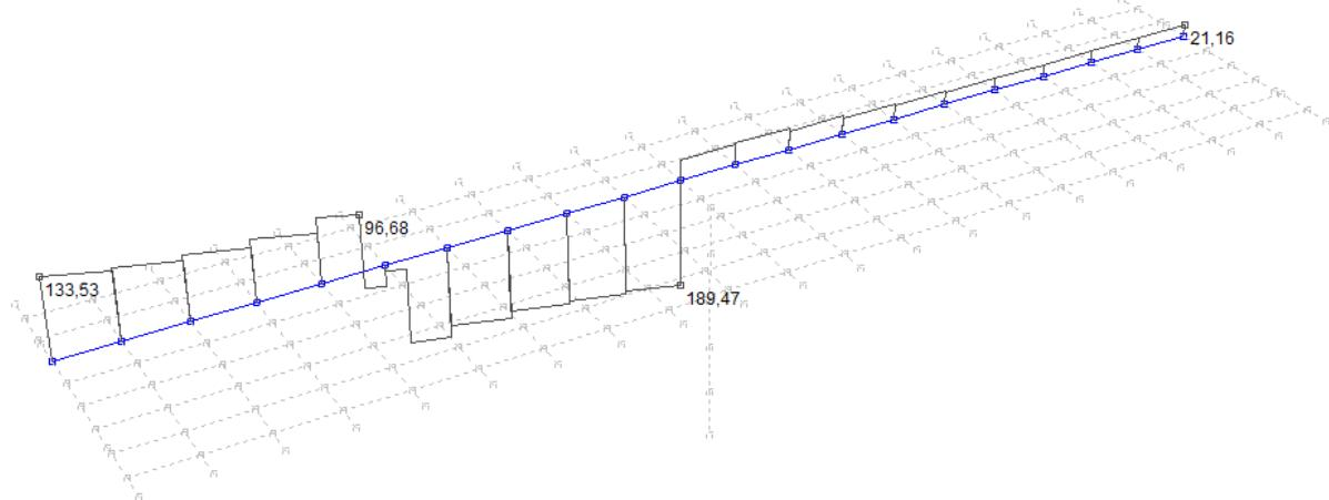
Slika 14: Pokretno opterećenje – maksimalni momenti u prvom polju – poprečne sile  $V_z$  (kN)
