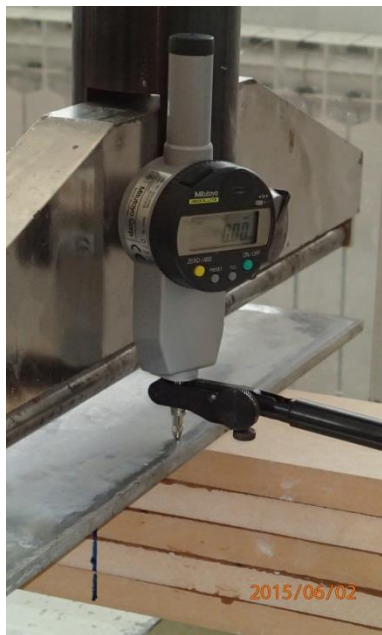
Fotografija 4.8: Postavljanje mehaničke mikroure s digitalnim očitanjem
