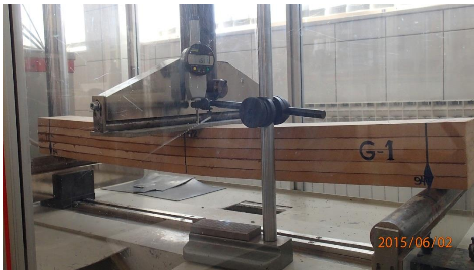
Fotografija 4.13: Ponašanje i progib grede G-1 pred slom
