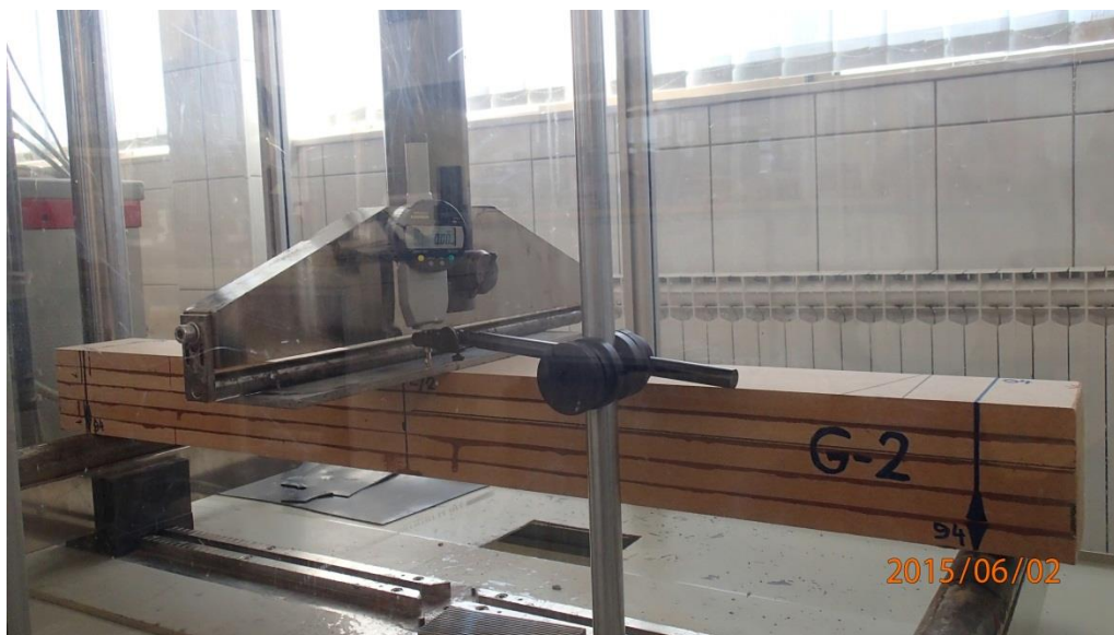
Fotografija 4.15: Početak ispitivanja grede G-2
