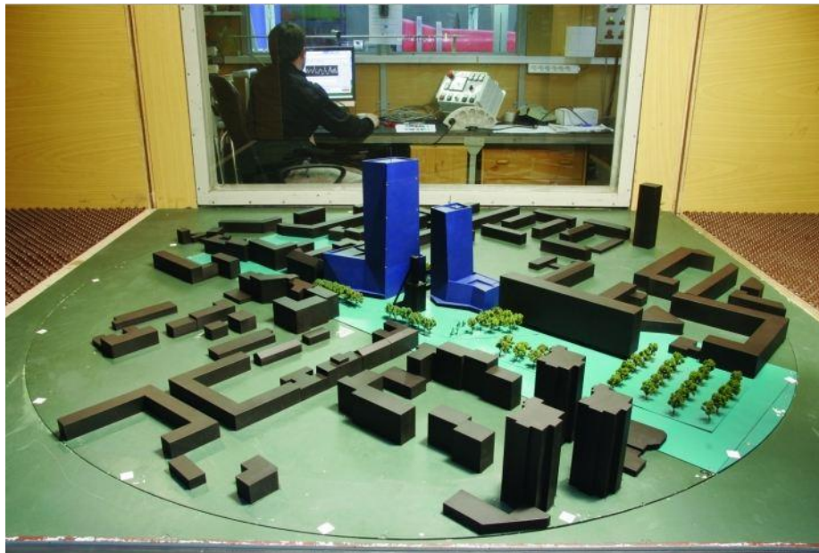
Fotografija 2.1: Prikaz ispitivanja modela visokih zgrada u vjetrovnom tunelu
