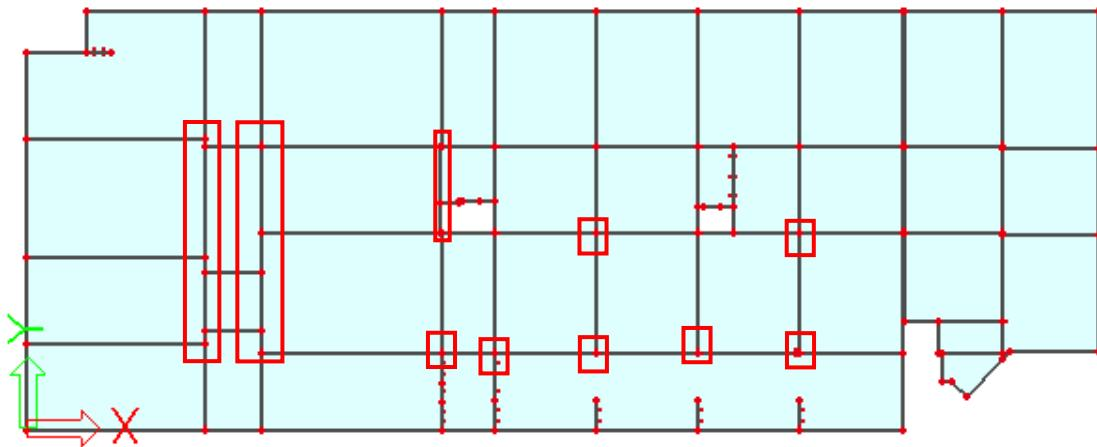
**Napomena:** Gledajući rezultate možemo primijetiti da se u pojedinim točkama pojavljuju vrijednosti koje nisu mjerodavne zbog toga što računalni program daje rezultate u beskonačno maloj točki, dakle, zapravo se radi o greški MKE. Mjerodavna i realna vrijednost na ležajevima je znatno manja.
