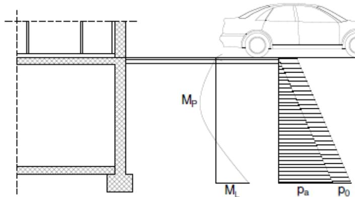
Slika 11.1 Prikaz opterećenja na obodni zid garaže
