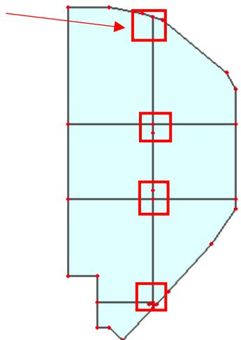
**Napomena:** Gledajući rezultate možemo primijetiti da se u pojedinim točkama pojavljuju vrijednosti koje nisu mjerodavne zbog toga što računalni program daje rezultate u beskonačno maloj točki, dakle, zapravo se radi o greški MKE. Mjerodavna i realna vrijednost na ležajevima je znatno manja.
