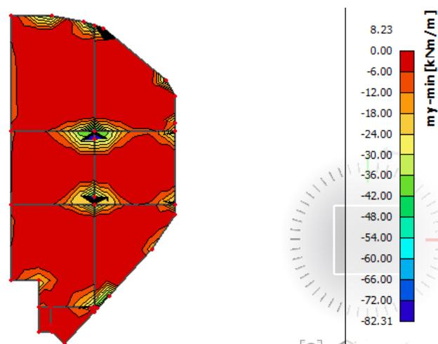
**Napomena:** Gledajući rezultate možemo primijetiti da se u pojedinim točkama pojavljuju vrijednosti koje nisu mjerodavne zbog toga što računalni program daje rezultate u beskonačno maloj točki, dakle, zapravo se radi o greški MKE. Mjerodavna i realna vrijednost na ležajevima je znatno manja.
