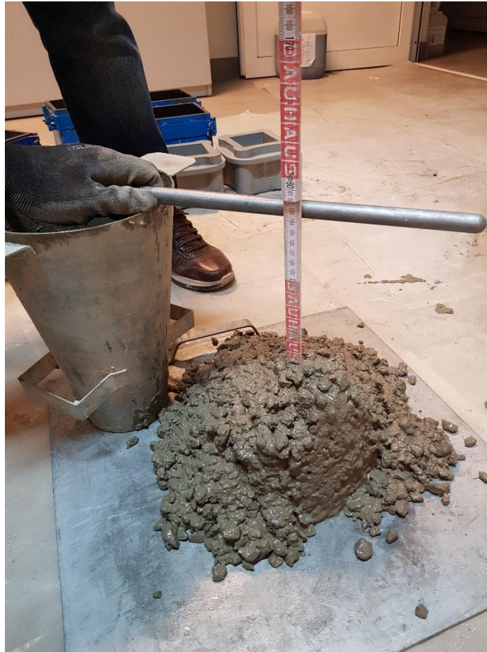
Slika 6.5. Rezultati slijeganja i oblika mješavine B3
