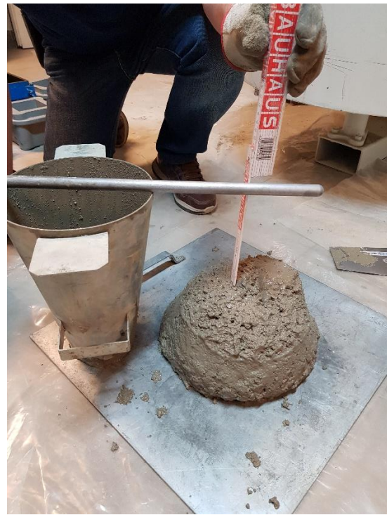
Slika 6.4. oblik slijeganja mješavine B2
