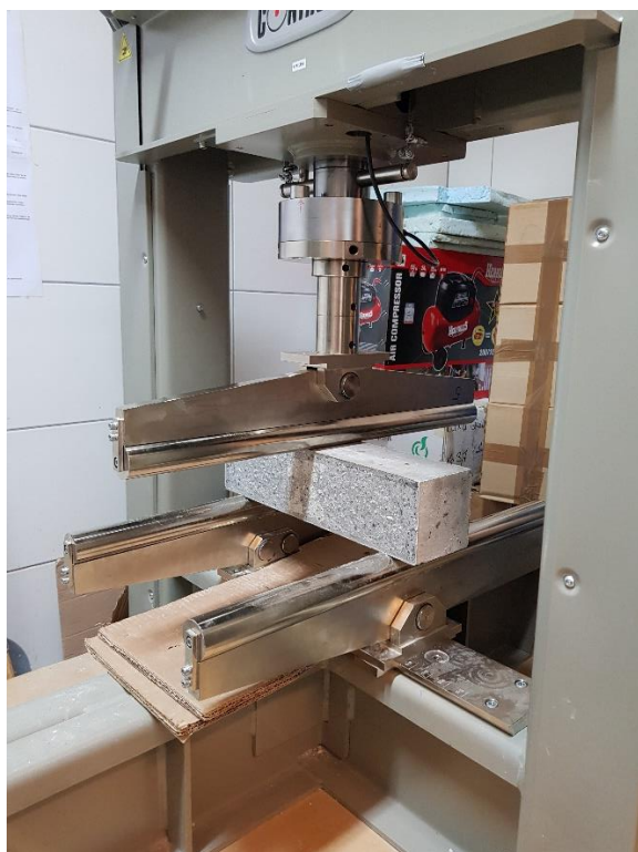
Slika 5.16. Ispitivanje čvrstoće na savijanje
