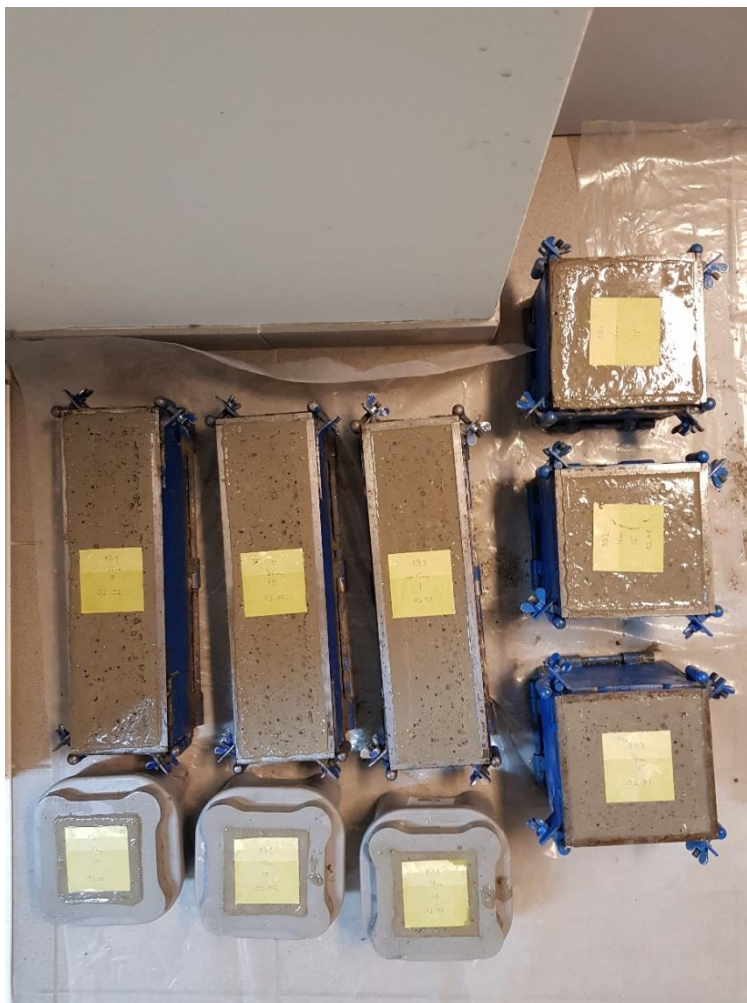
Slika 5.8. Uzorci mješavine B2(16mm)
