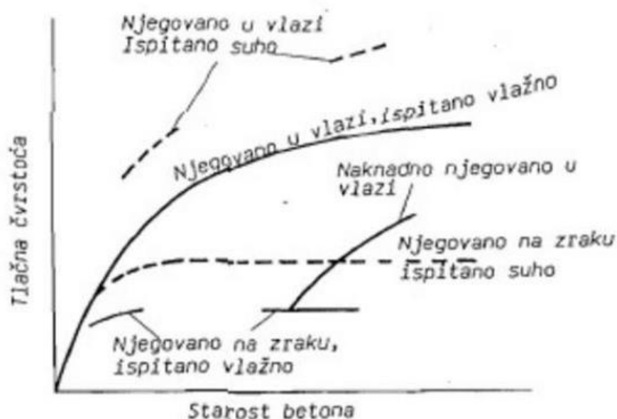
Slika 2.5. Utjecaj vlažnosti uzorka na tlačnu čvrstoću [5]
