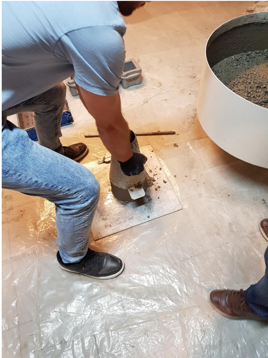
Slika 5.13. Ispitivanje konzistencije metodom slijeganja
