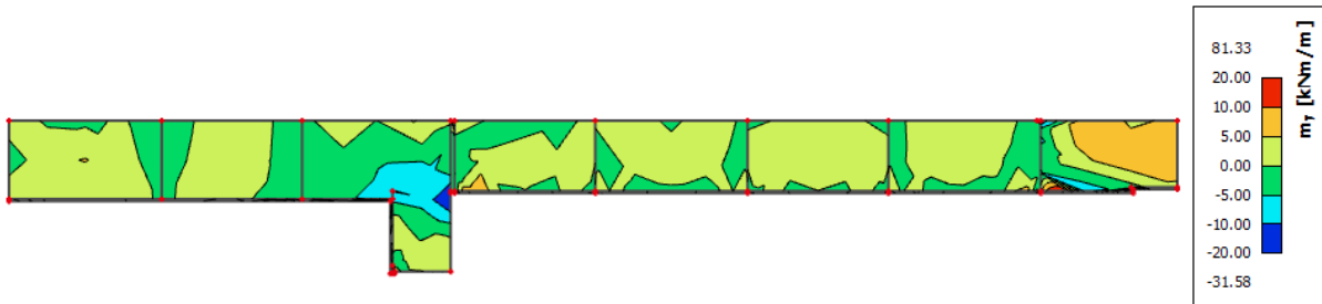
Slika 11.76 Prikaz momenata savijanja – m_y
