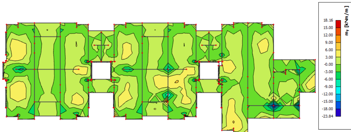
Slika 11.73 Prikaz momenata savijanja – m_y
