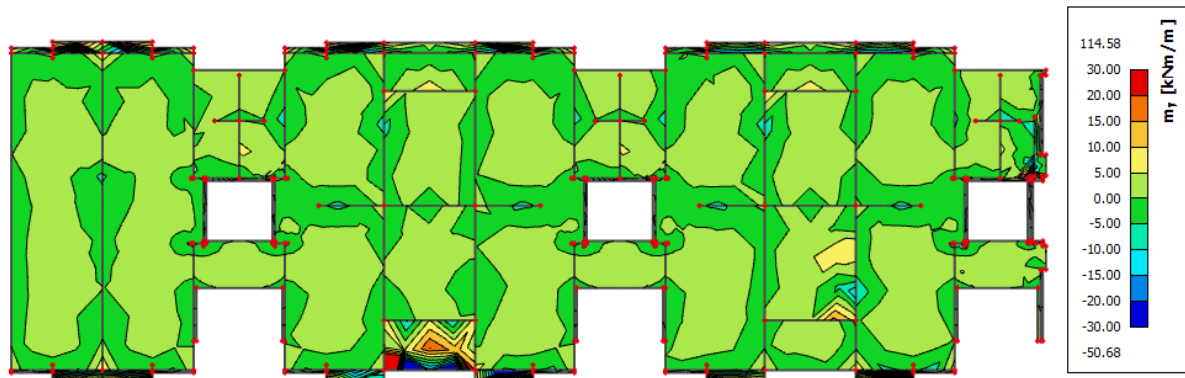
Slika 11.38 Prikaz momenata savijanja – m_y
