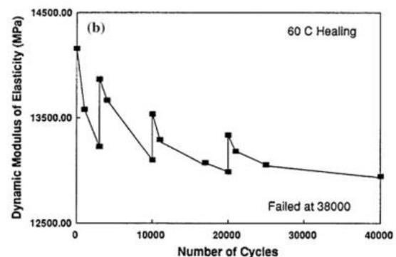
Slika 19. Dinamički modul elastičnosti pri temperaturi od 60°C [55]
