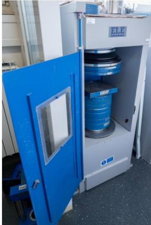
Slika 6. Tlačna preša [99]
