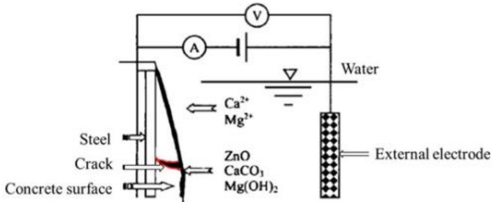
*Slika 25. Shematski prikaz regeneracije pukotina metodom elektrodepozicije [2]*
