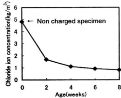
Slika 27. Koncentracija klorida na čeličnoj površini [105]
