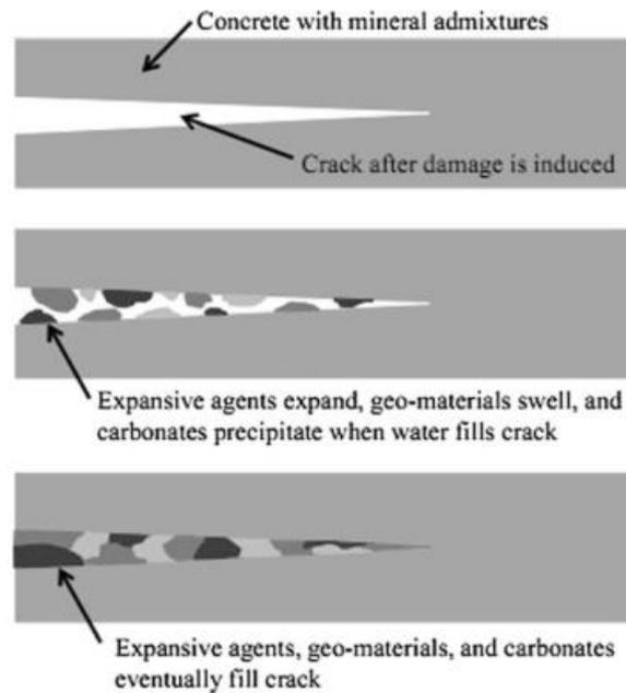
Slika 15. Samozacjeljivanje betona s mineralnim dodacima [47]
