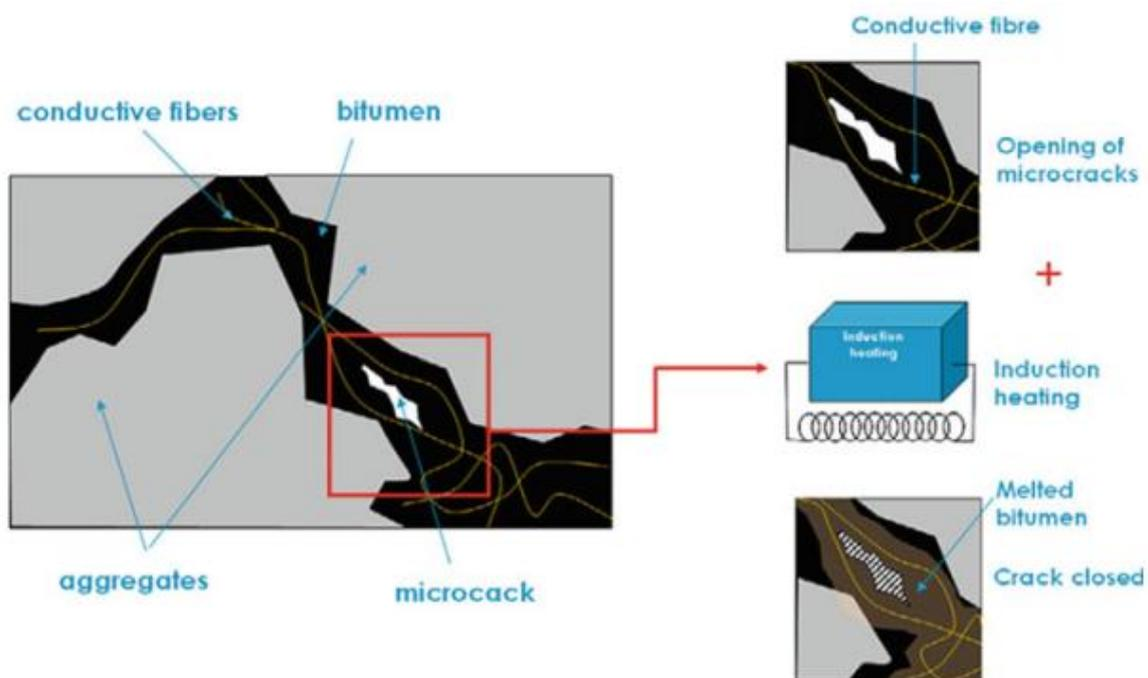
*Slika 29. Shematski prikaz sistema korištenja vlakana s induciranom energijom za zatvaranje pukotina u asfalt betonu [3]*
