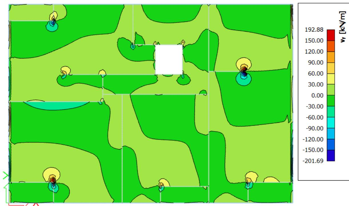
Slika 7.6 Poprečne sile  $V_{Ed,y}$  (kN/m) za GSN-1
