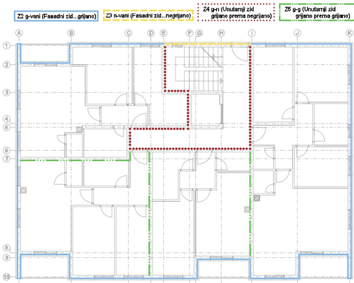
Slika 12.9 Tlocrt sa ucrtanim oznakama i granicama građevnih dijelova zgrade (zidovi)
