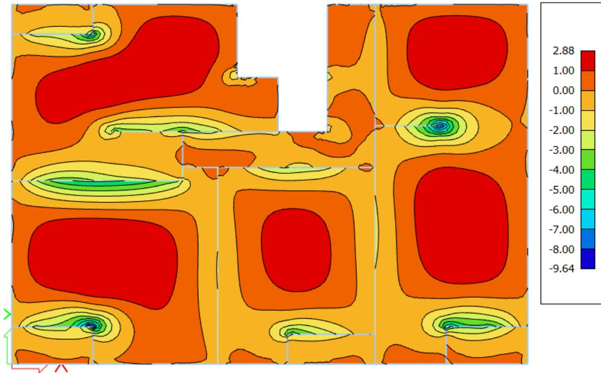
Slika 6.9 Armatura u ploči smjer  $A_{s,y-y}$  ( $\text{cm}^2/\text{m}$ ) za GSN-1
