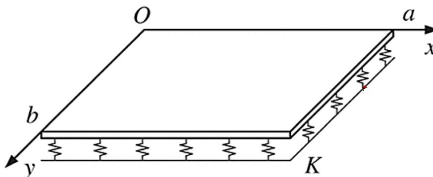
Slika 10.1 Prikaz međusobnog djelovanja konstrukcija-tlo Winkler-ovim modelom
