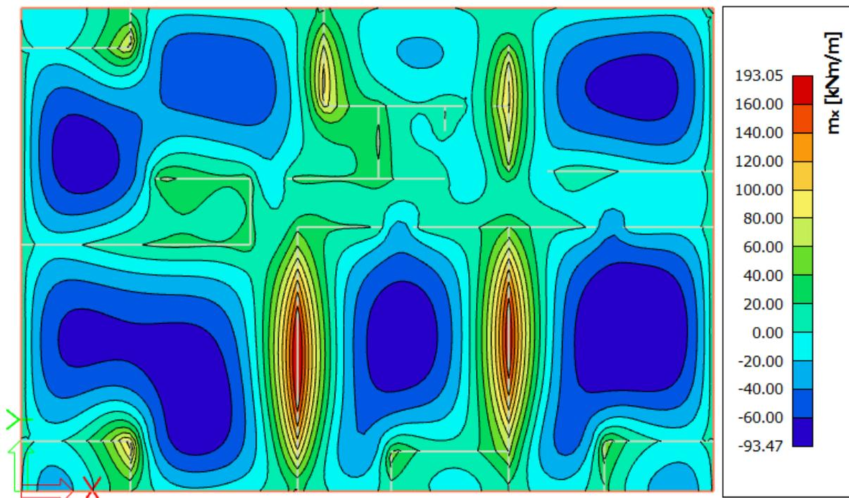
Slika 10.13 Moment savijanja  $M_{Ed,x}$  (kNm/m) za GSU-1
