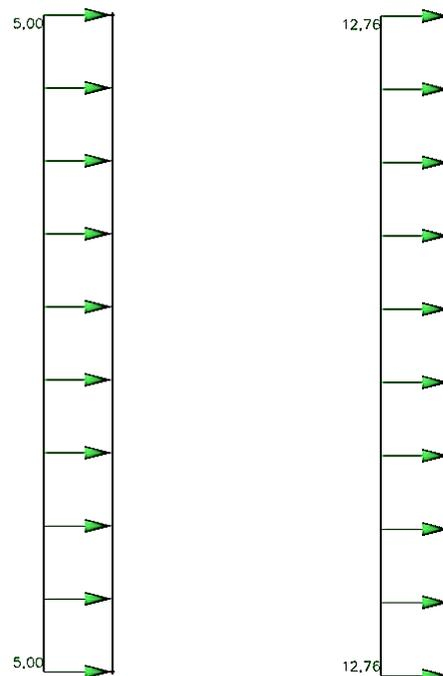
Slika 4.29 Dodatno horizontalno opterećenje (lijevo);
