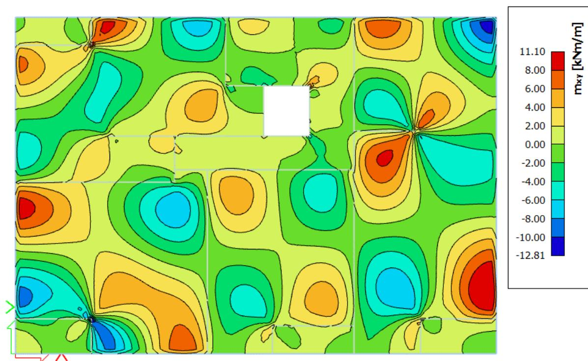
Slika 7.4 Moment savijanja  $M_{Ed,xy}$  (kNm/m) za GSN-1
