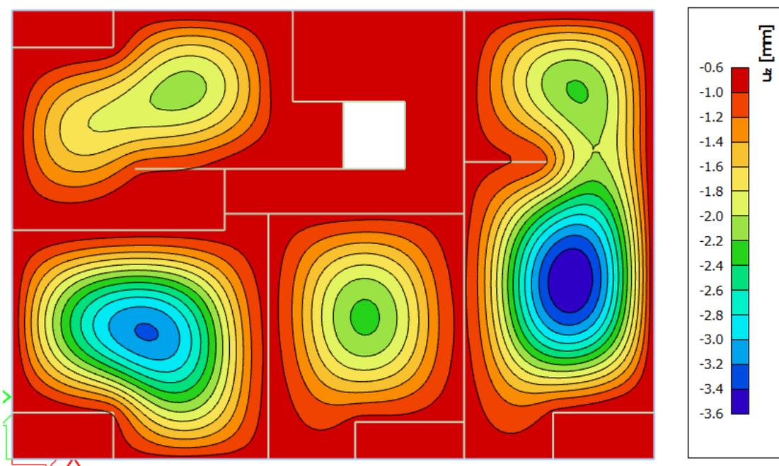
Slika 7.11 Progib krovne ploče (mm) za kombinaciju GSU-2
