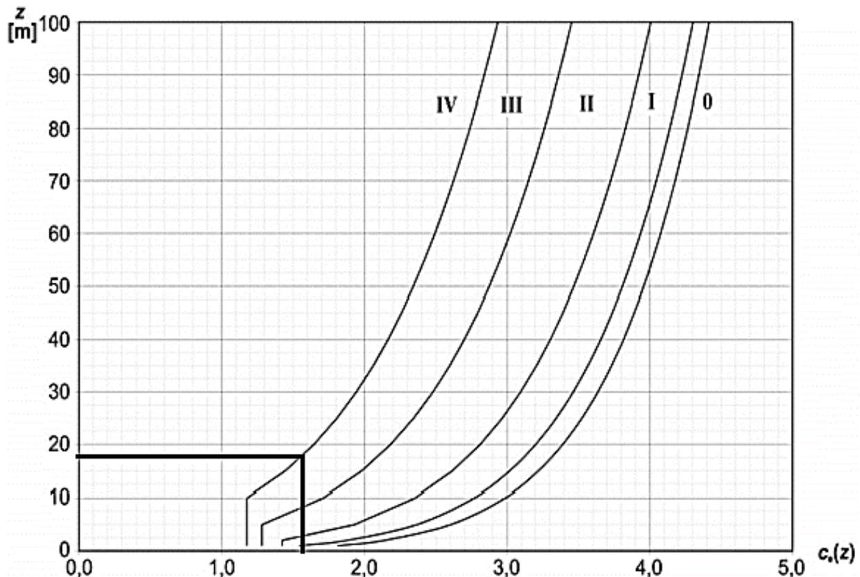
Slika 4.14 Grafički prikaz koeficijenta izloženosti  $c_e(z)$  kao funkcija visine iznad terena  $z$ , za  $c_o=1,0$  (koeficijent vertikalne razvedenosti terena) i  $k_1=1,0$  (koeficijent turbulencije) (HRN EN 1991-1-4:2012)
