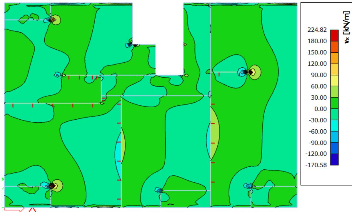
Slika 6.5 Poprečne sile  $V_{Ed,x}$  (kN/m) za GSN-1
