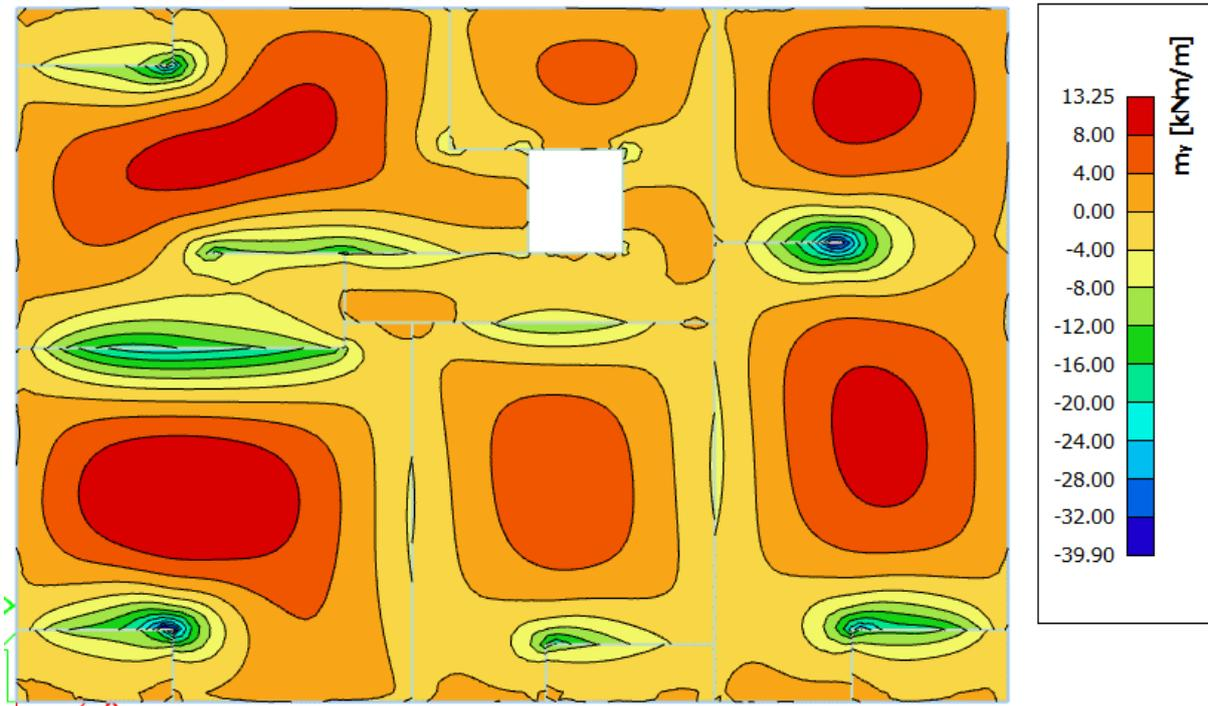
Slika 7.13 Moment savijanja  $M_{Ed,y}$  (kNm/m) za GSU-1
