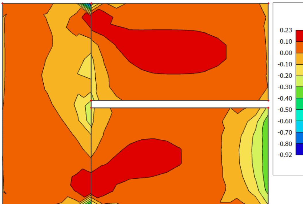
Slika 8.5 Armatura u stubištu smjer  $A_{s,x-x}$  ( $\text{cm}^2/m$ ) za GSN-1
