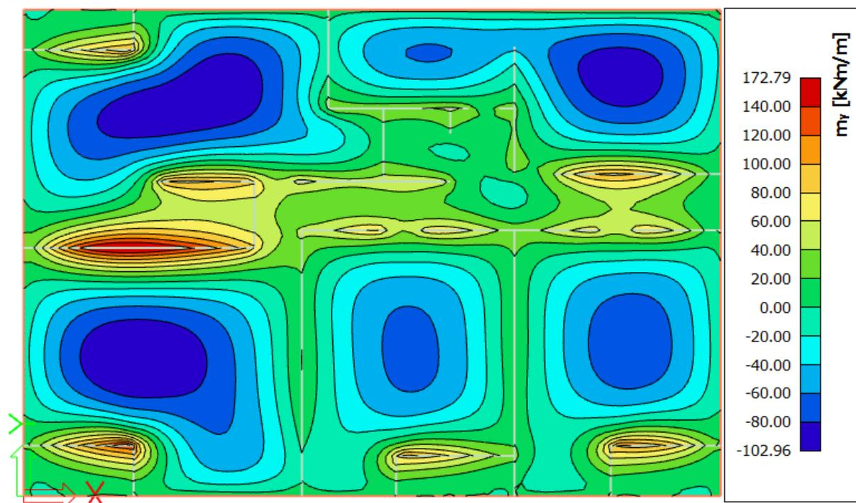
Slika 10.14 Moment savijanja  $M_{Ed,y}$  (kNm/m) za GSU-1
