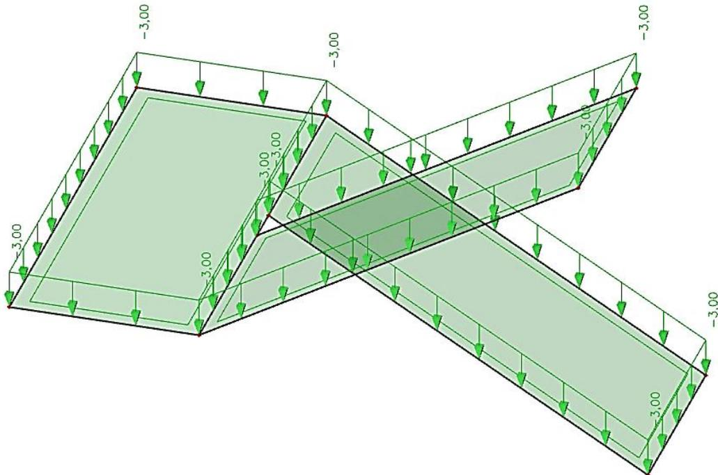
Slika 4.10 Promjenjivo djelovanje  $q$  ( $\text{kN/m}^2$ )
