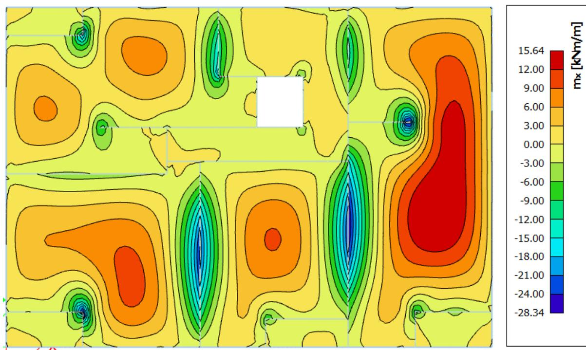
Slika 7.12 Moment savijanja  $M_{Ed,x}$  (kNm/m) za GSU-1
