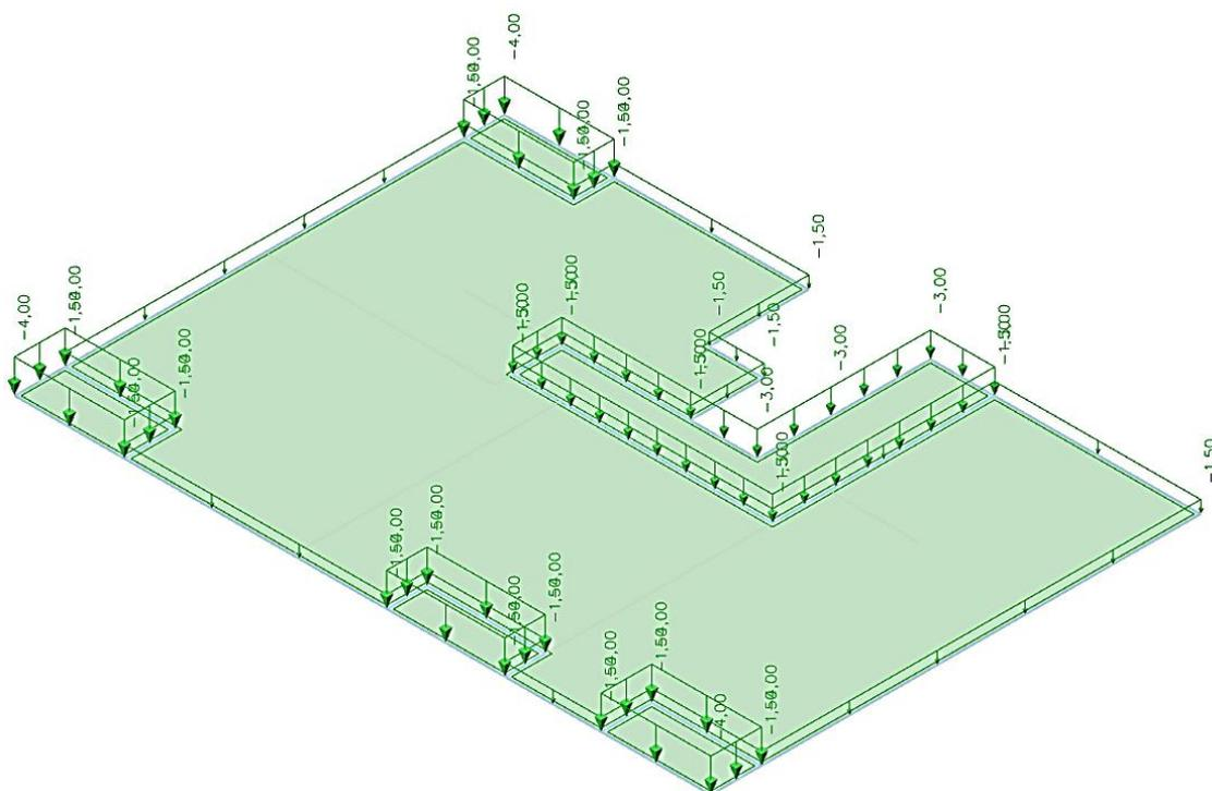
Slika 4.6 Promjenjivo djelovanje  $q$  ( $\text{kN/m}^2$ )
