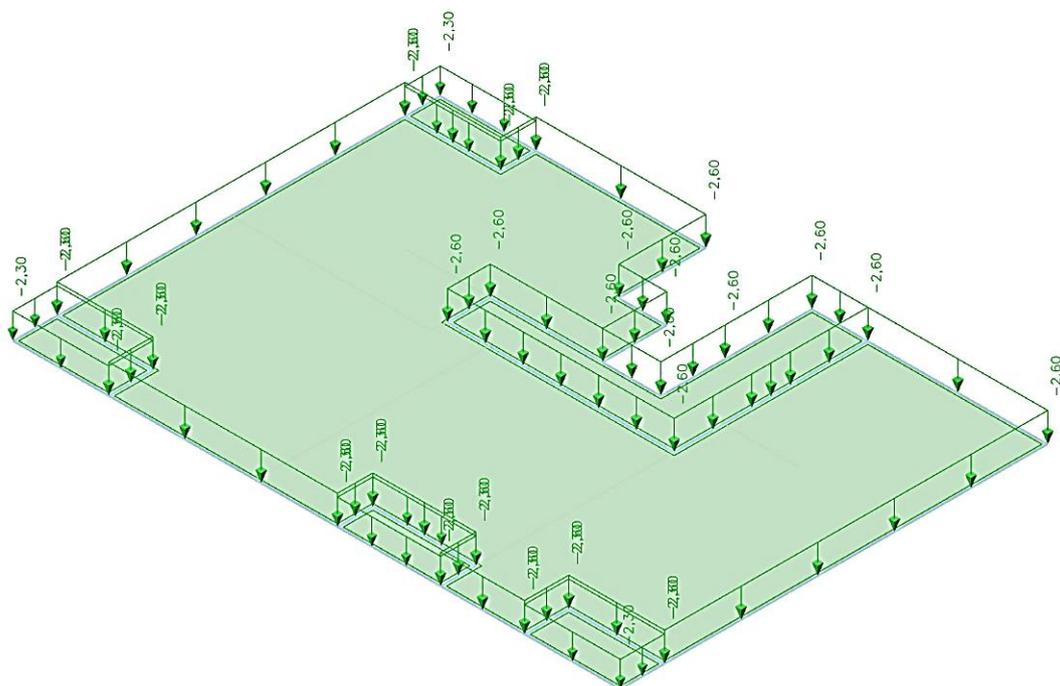
Slika 4.5 Dodatno stalno djelovanje  $\Delta g$  ( $\text{kN/m}^2$ )
