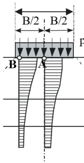
Slika 4.28 Dodatno vertikalno naprezanje
