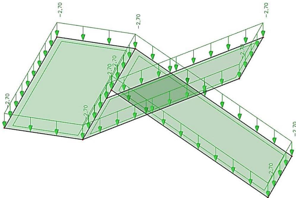
Slika 4.9 Dodatno stalno djelovanje  $\Delta g$  ( $\text{kN/m}^2$ )
