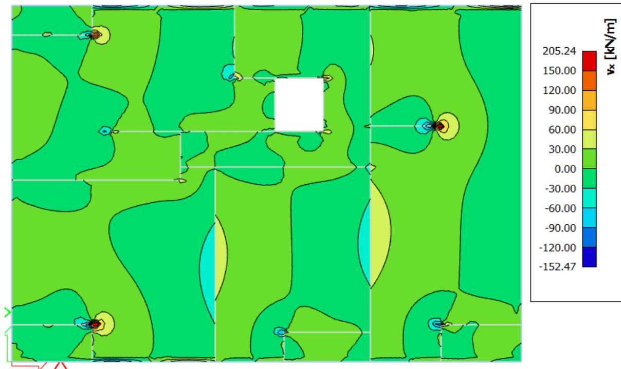
Slika 7.5 Poprečne sile  $V_{Ed,x}$  (kN/m) za GSN-1
