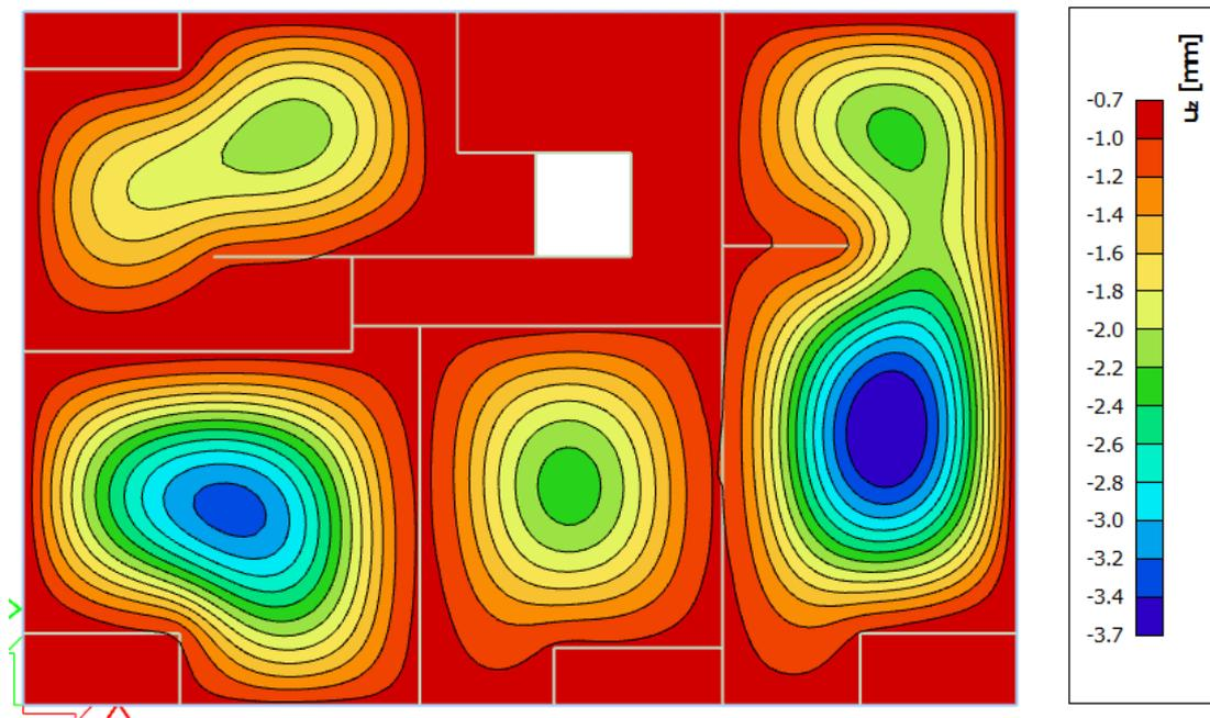
Slika 7.10 Progib krovne ploče (mm) za kombinaciju GSU-1
