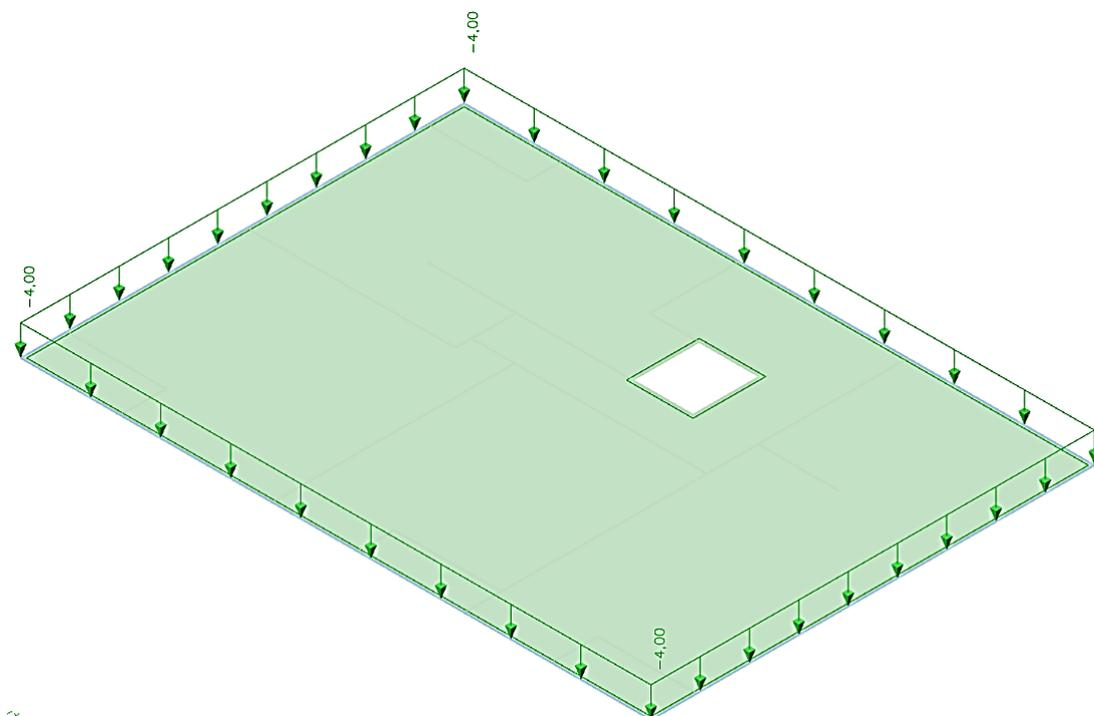
Slika 4.7 Dodatno stalno djelovanje  $\Delta g$  (kN/m<sup>2</sup>)
