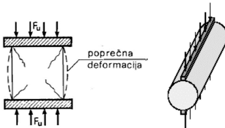
*Slika 2.1 Ispitivanje tlačne čvrstoće betona (lijevo);
