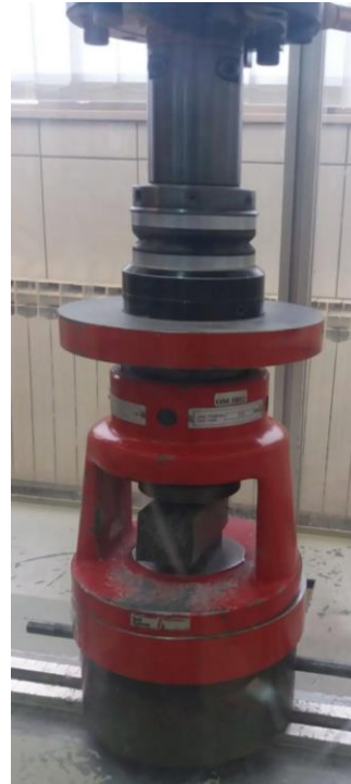
Slika 48. Hidraulička preša za tlak
