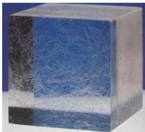
Slika 1. 3D raspored vlakana u betonu [5]
