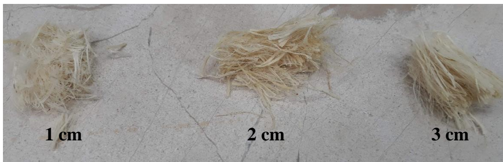
Slika 41. Osušena i izrezana vlakna brnistre
