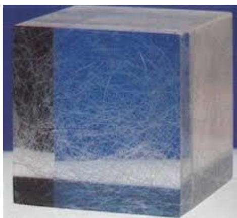
Slika 1. 3D raspored vlakana u betonu [5]
