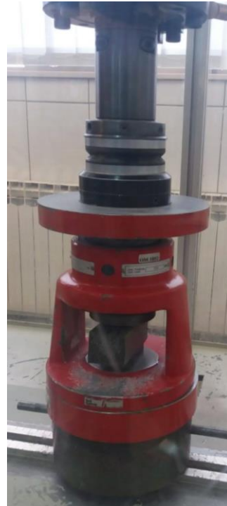
Slika 48. Hidraulička preša za tlak
