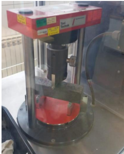
Slika 47. Hidraulička preša za savijanje
