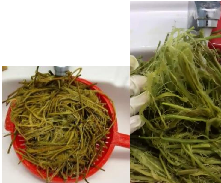
Slika 38. Vlakna brnistre isprana vodom te ručno odvajanje vlakana [41]
