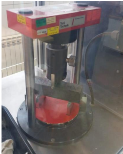
Slika 47. Hidraulička preša za savijanje
