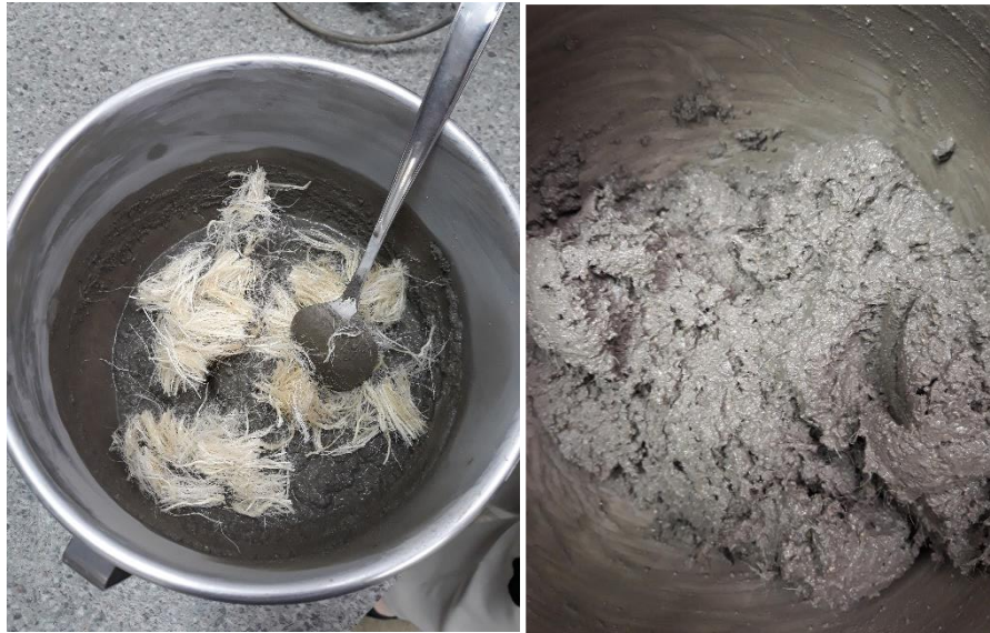
Slika 44. Vlakna dodana u mješavinu
