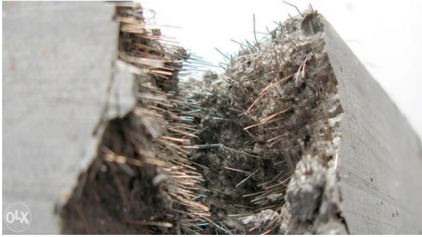
Slika 2. Čelična vlakna u betonu [6]
