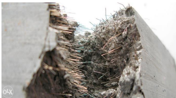
Slika 2. Čelična vlakna u betonu [6]
