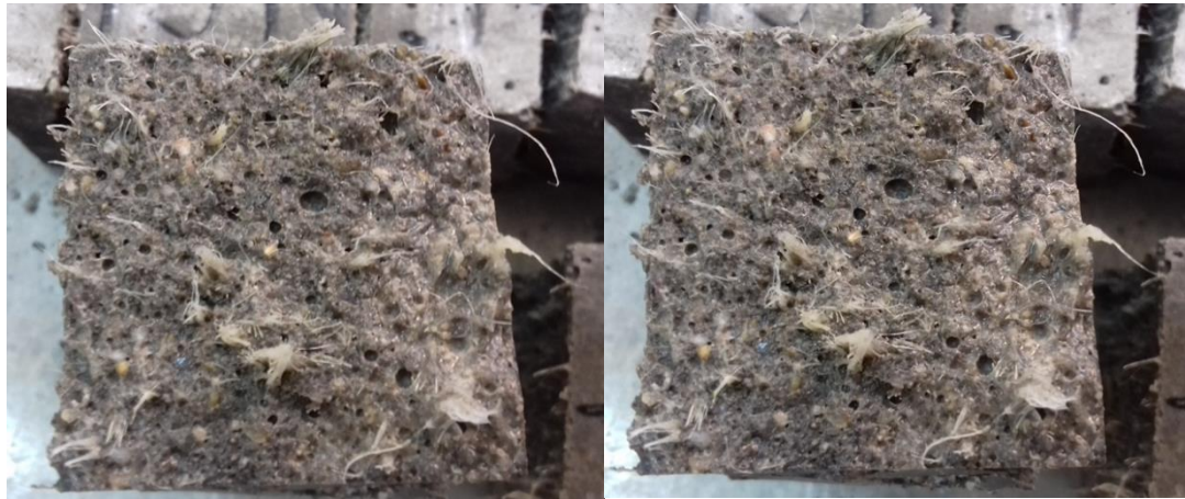
Slika 50. Presjek uzorka 19N5 -1 -1,0 nakon sloma
