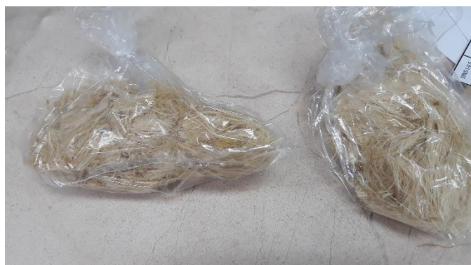
Slika 42. Izvagana vlakna brnistre ( 480g i 960g )
