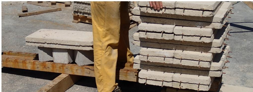
**Foto 4.20:** Nanošenje opterećenja na poklopnicu za ispitivanje na posmičnu nosivost
