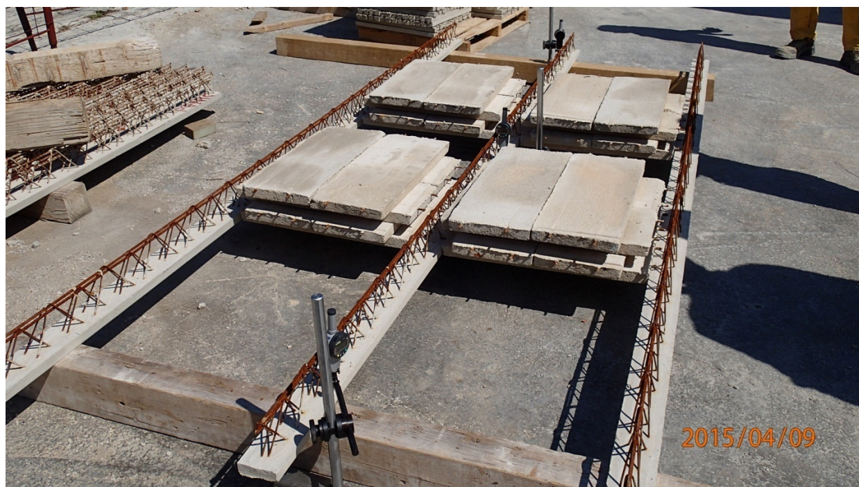
Foto 4.8: Provedba ispitivanja ( IV. faza opterećenja)
