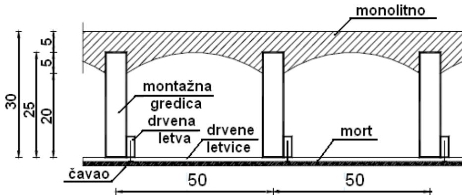
**Slika 2.1:** Poprečni presjek stropa sustava Isteg
