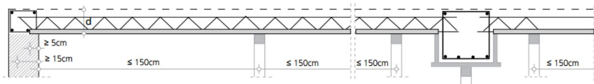
**Slika 2.16:** Uzdužni presjek Fert stropa
