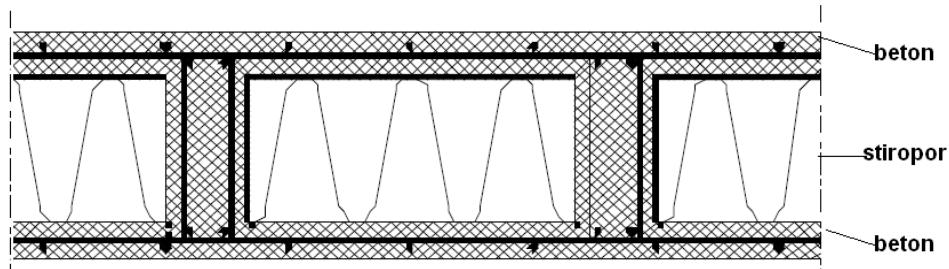
**Slika 2.4:** Poprečni presjek omnia stropa sa štednim ulošcima
