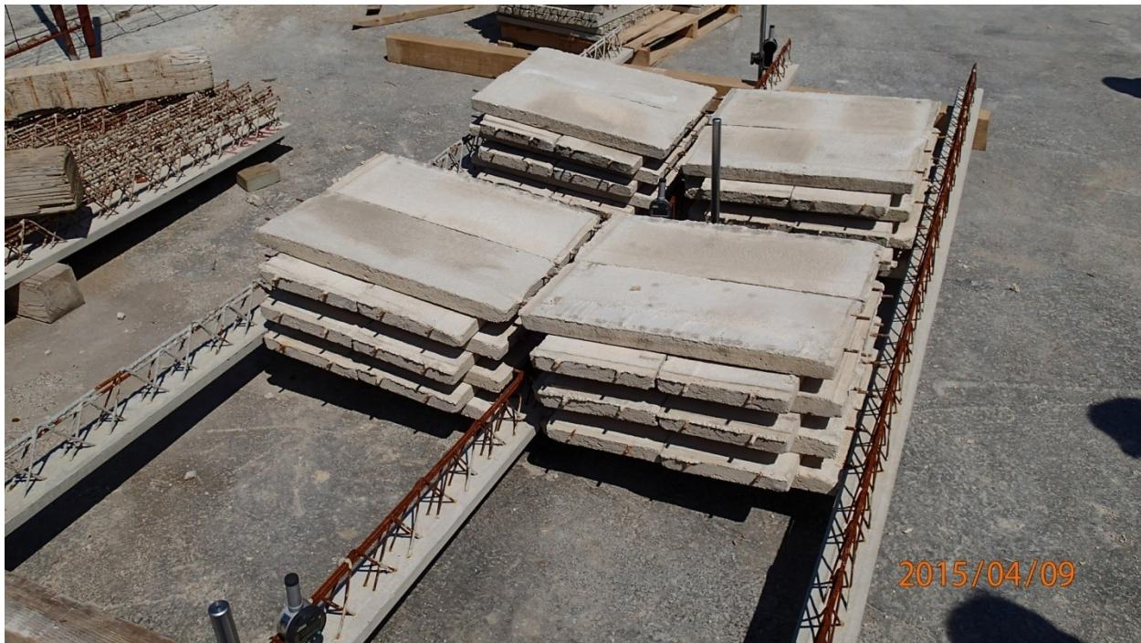
**Foto 4.9:** Provedba ispitivanja ( VII. faza opterećenja) – lomno opterećenje
