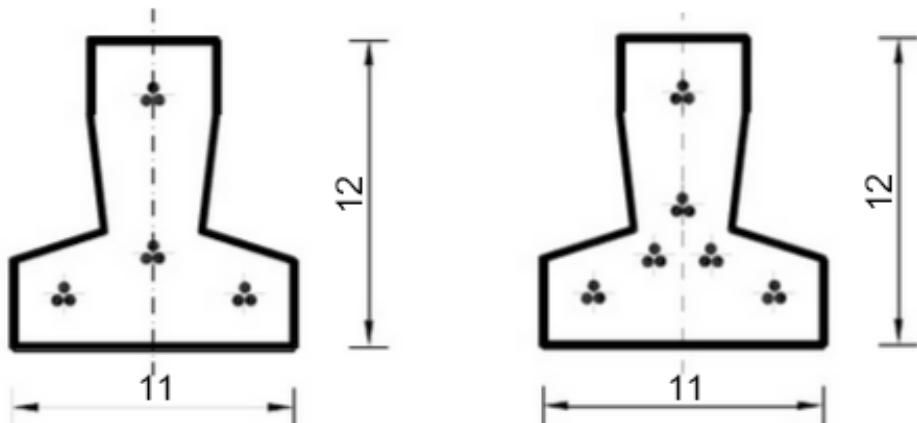
Slika 2.21: Poprečni presjek gredica T4 i T6
