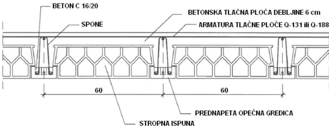
**Slika 2.19:** Poprečni presjek stropa s prednapetim opečnim gredicama
