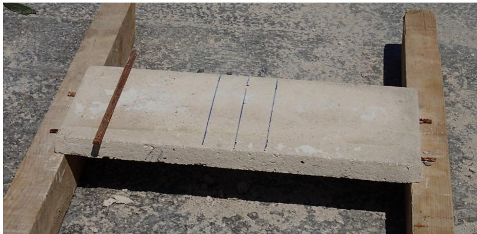
**Foto 4.17:** Priprema za opterećivanje poklopnice na posmičnu nosivost
