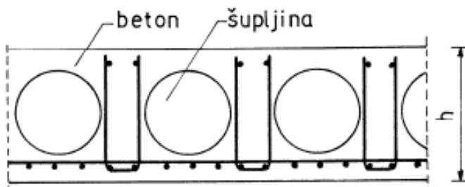
**Slika 2.5:** Poprečni presjek stropa od prednapregnutih šupljih ploča
