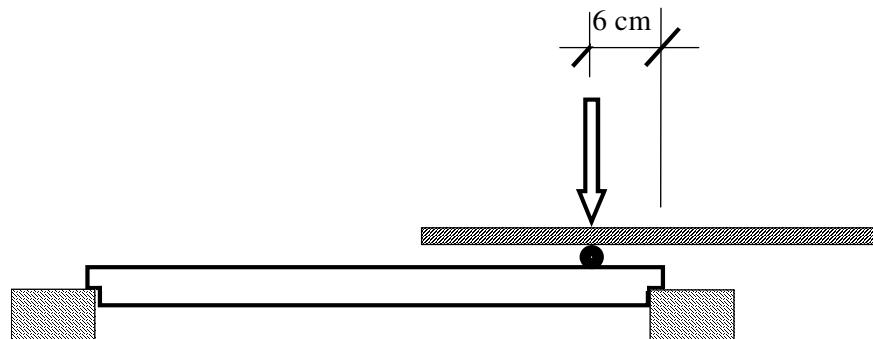
**Crtež 4.4:** Shema ispitivanja posmične nosivosti
