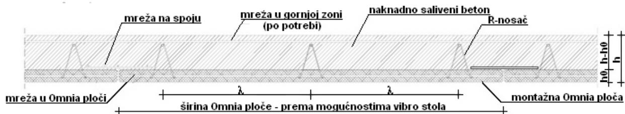
**Slika 2.2:** Poprečni presjek stropa sustava Omnia
