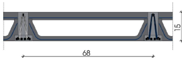
**Slika 2.31:** Poprečni presjek sivog stropa
