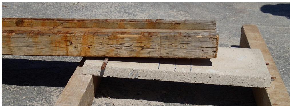
Foto 4.18: Priprema podloge za opterećivanje poklopnice na posmičnu nosivost
