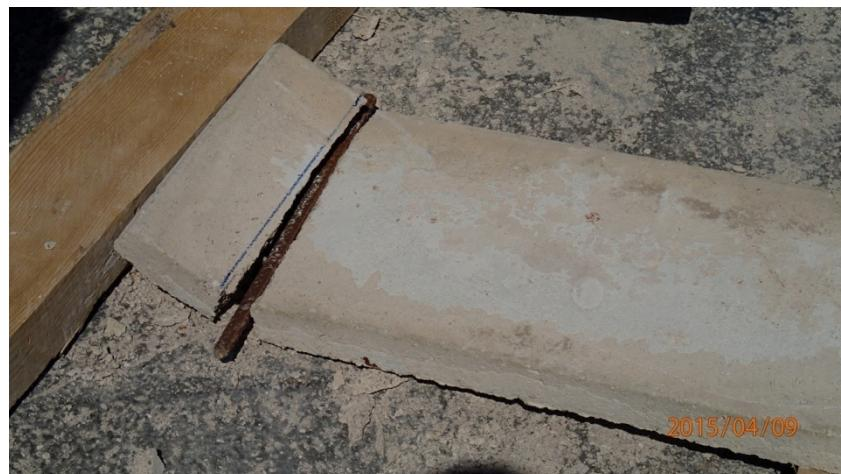
**Foto 4.22:** Izgled mesta sloma poklopnice pri ispitivanju posmične čvrstoće
