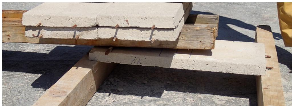
**Foto 4.19:** Početak nanošenja opterećenja na poklopnicu za ispitivanje na posmičnu nosivost
