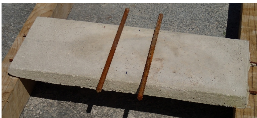
Foto 4.15. Priprema za opterećivanje poklopnice
