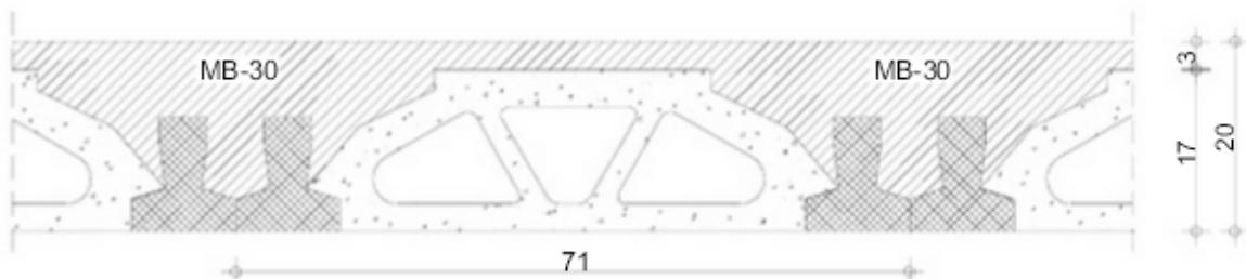
**Slika 2.25:** Poprečni presjek stropa tipa MK-20 – 2T6 ili 2T4
