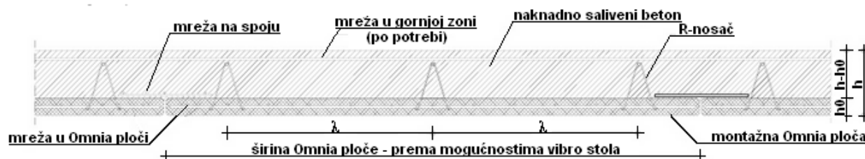
Slika 2.2: Poprečni presjek stropa sustava Omnia
