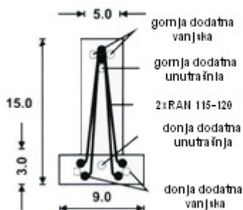
Slika 2.28: Poprečni presjek gredice
