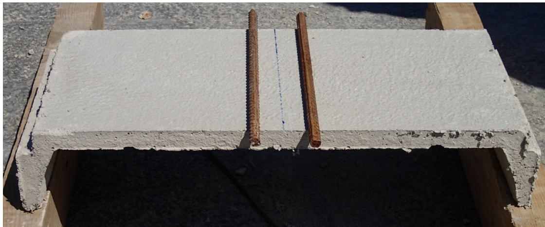
**Foto 4.12:** Priprema za opterećivanje kadice u položaju  $\cap$
