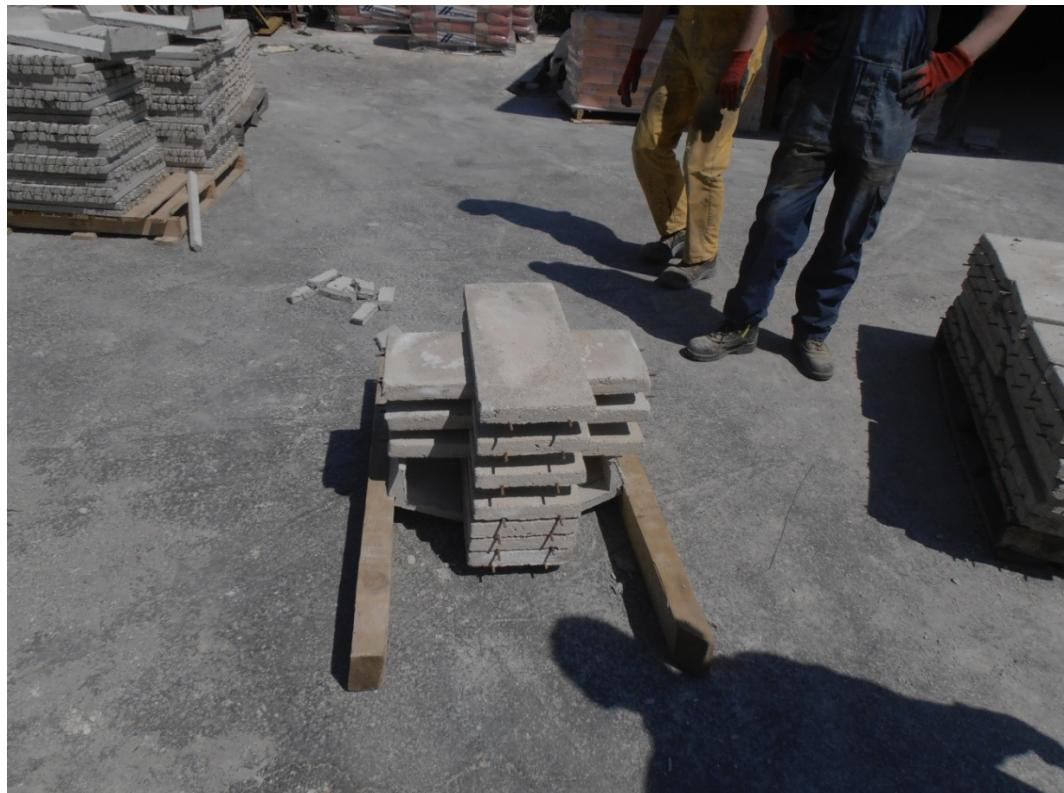
**Foto 4.13:** Provedba ispitivanja – kadica u položaju U
