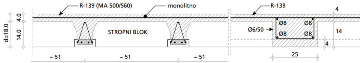
**Slika 2.17:** Armatura ploče i rebra za ukrutu
