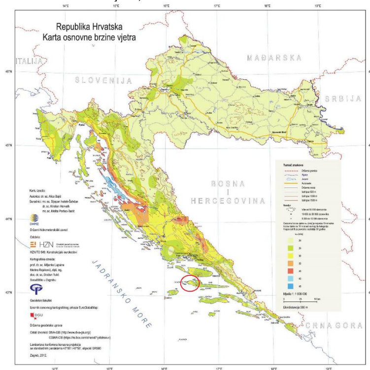
Slika 16 Karta osnovnih brzina vjetra V_{b,0}
