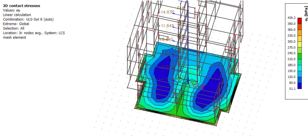
Slika 129 Maksimalno kontaktno naprezanje temeljne ploče
