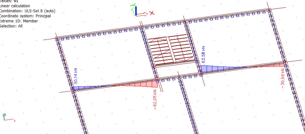
Slika 97 Dijagram poprečnih sila  $V_z$  na gredama
