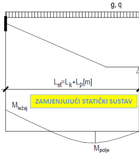
Slika 160 Zamjenjujući statički sustav za stubište
