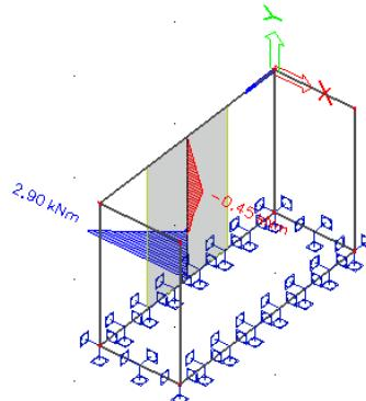
Slika 164 Moment savijanja  $M_y$ Dimenzioniranje na moment savijanja:
