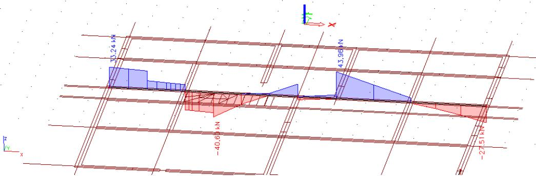
Slika 82 Dijagram poprečnih sila  $V_z$  na gredama
