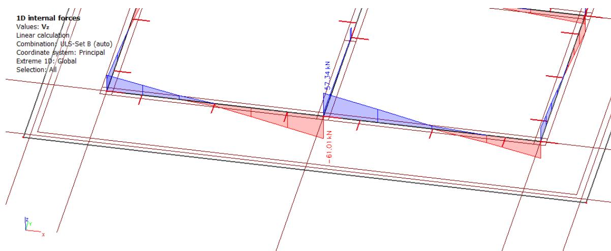
Slika 63 Dijagram poprečnih sila  $V_z$  na gredama**Poprečni presjek grede:**
