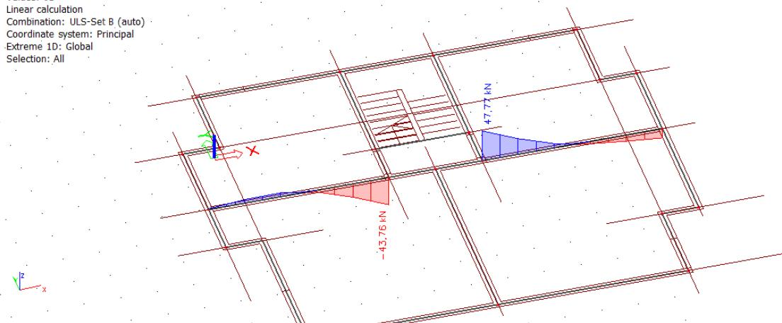
Slika 127 Dijagram poprečnih sila  $V_z$  na gredama
