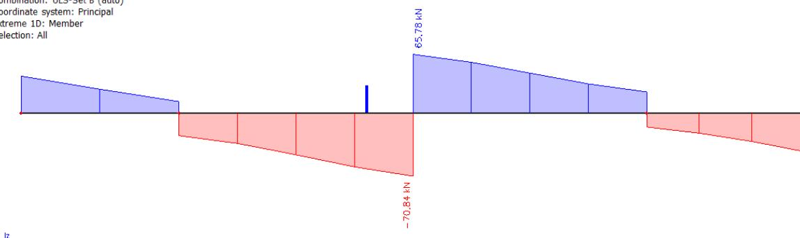
Slika 78 Dijagram poprečnih sila  $V_z$  na gredama**Poprečni presjek grede:**
