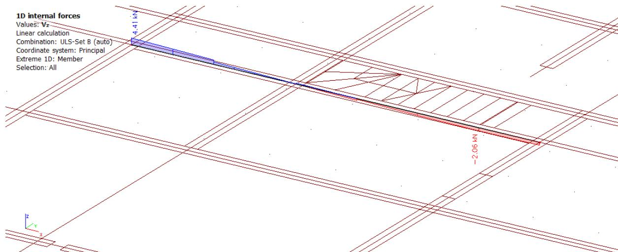
Slika 84 Dijagram poprečnih sila  $V_z$  na gredama
