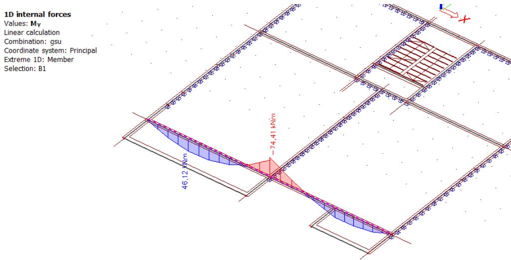
Slika 133 Moment savijanja  $m_y$  za GSU
