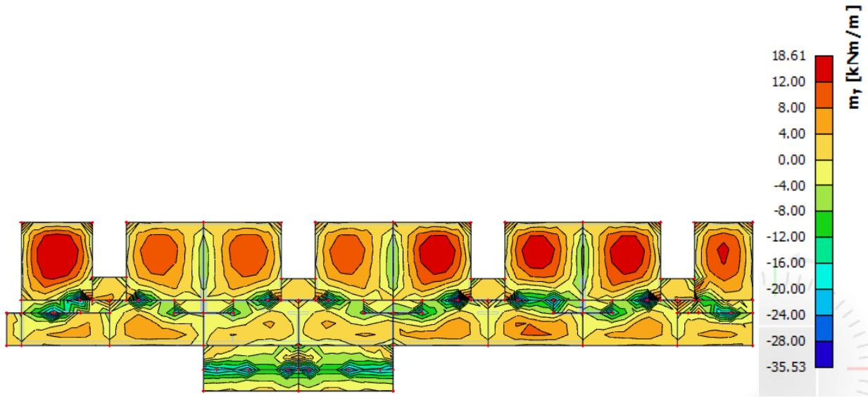
Slika 11.12. Rezultati momenata savijanja ploče pozicije 600 (GSN 2,  $M_y$ )
