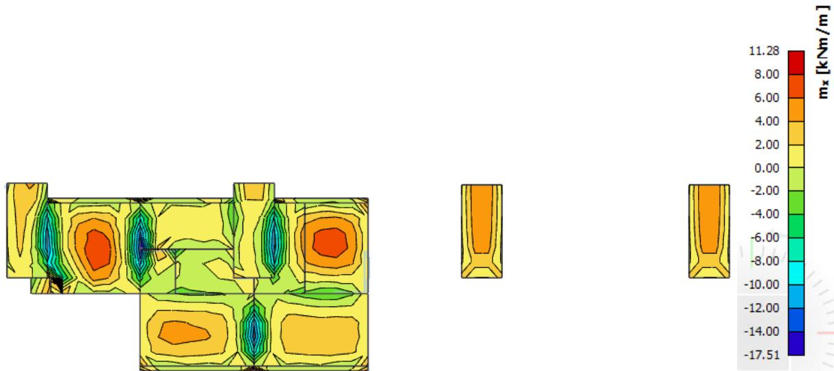
Slika 11.7. Rezultati momenata savijanja ploče pozicije 700 (GSU,  $M_x$ )
