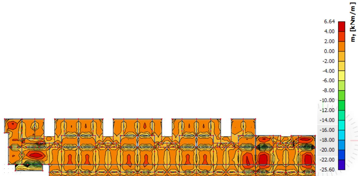
Slika 11.46. Rezultati momenata savijanja ploče pozicije 200 (GSU,  $M_y$ )
