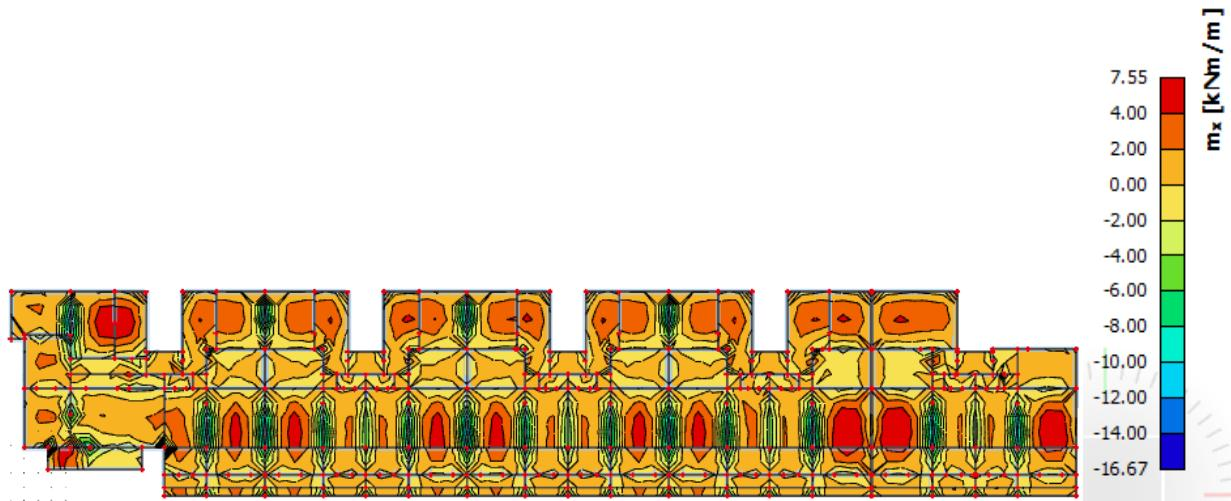
Slika 11.55. Rezultati momenata savijanja ploče pozicije 100 (GSU,  $M_x$ )
