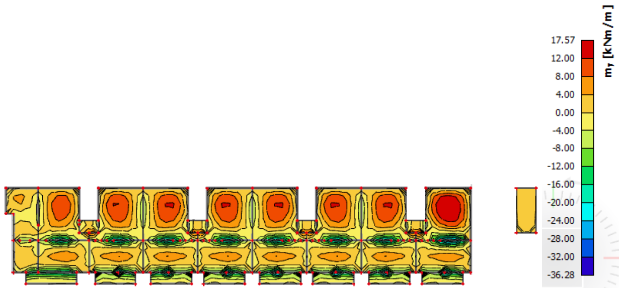
Slika 11.34. Rezultati momenata savijanja ploče pozicije 300 (GSN 1, M_y )
