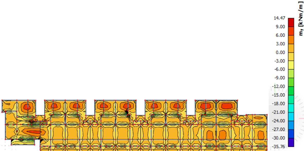
Slika 11.54. Rezultati momenata savijanja ploče pozicije 100 (GSU,  $M_y$ )
