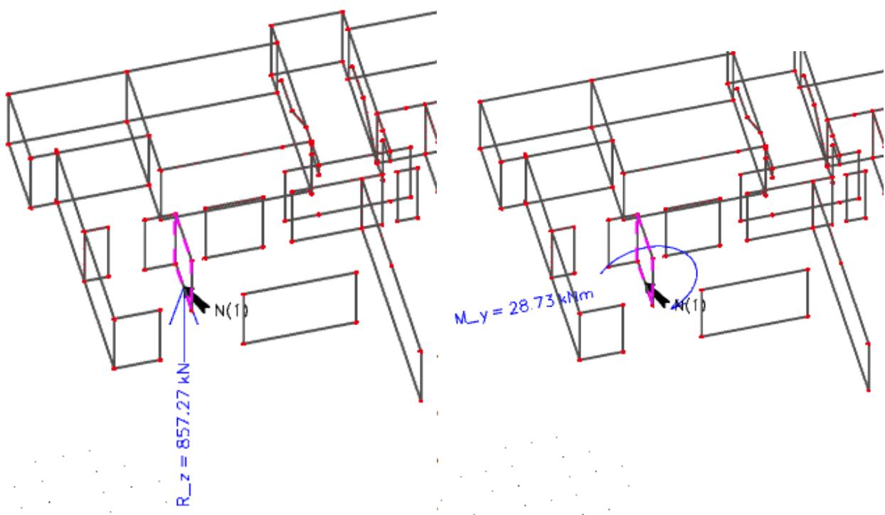
Slika 16.4.  $N_y,\text{ppadni}$  - GSN  $S_y$ Slika 16.5.  $M_y,\text{max}$  - GSN  $S_y$
