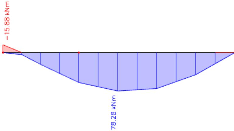
Slika 11.54. Rezultati momenata savijanja grede pozicije 703 (GSU, M<sub>y</sub>)Granična vrijednost širine pukotine:  $w_g = 0,3 \text{ mm}$
