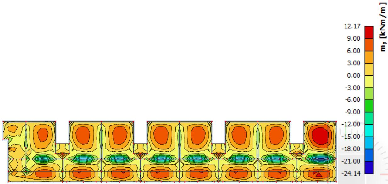
Slika 11.22. Rezultati momenata savijanja ploče pozicije 500 (GSU,  $M_y$ )
