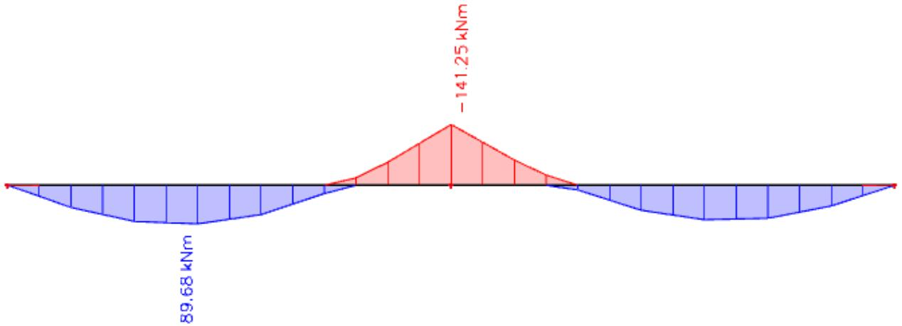
Slika 11.54. Rezultati momenata savijanja grede pozicije 701 (GSU, M<sub>y</sub>)
