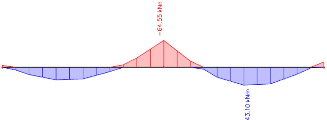
Slika 11.54. Rezultati momenata savijanja grede pozicije 702 (GSU, M<sub>y</sub>)
