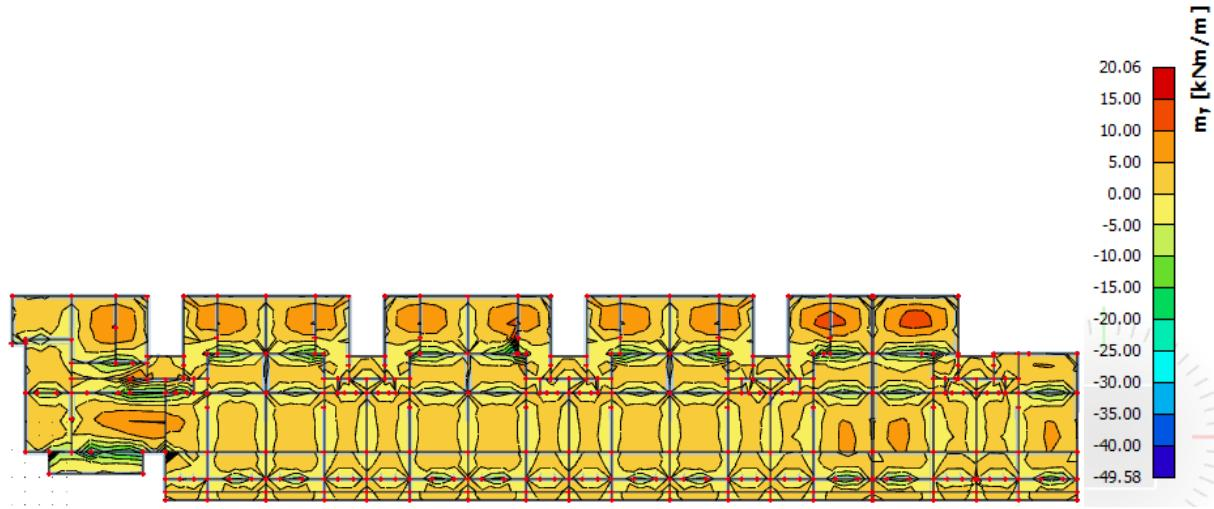
Slika 11.52. Rezultati momenata savijanja ploče pozicije 100 (GSN 2,  $M_y$ )
