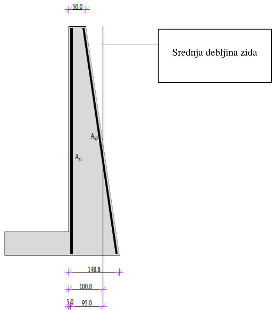
Slika 15.6. Prikaz armature u poprečnom presjeku
