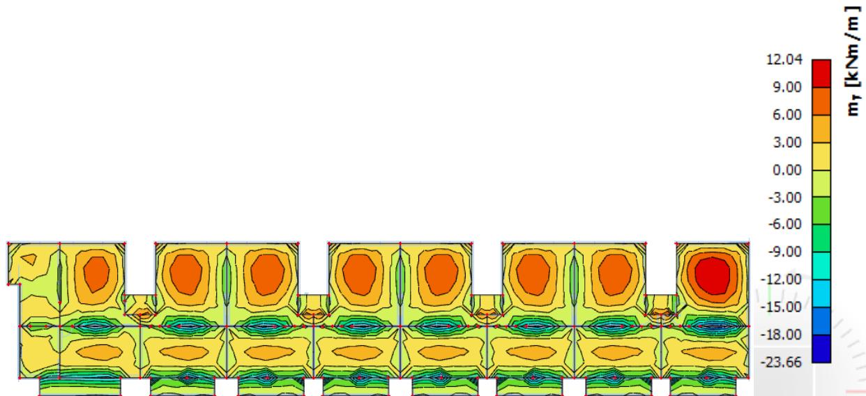
Slika 11.30. Rezultati momenata savijanja ploče pozicije 400 (GSU,  $M_y$ )
