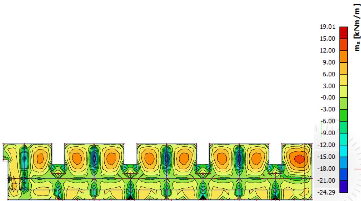
Slika 11.23. Rezultati momenata savijanja ploče pozicije 500 (GSU,  $M_x$ )
