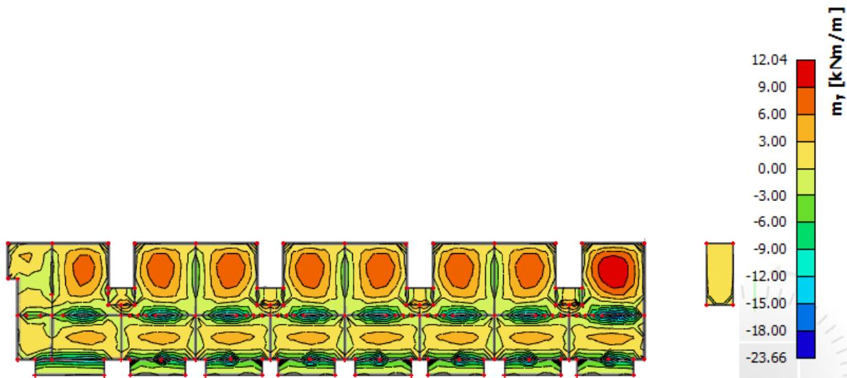
Slika 11.38. Rezultati momenata savijanja ploče pozicije 300 (GSU,  $M_y$ )
