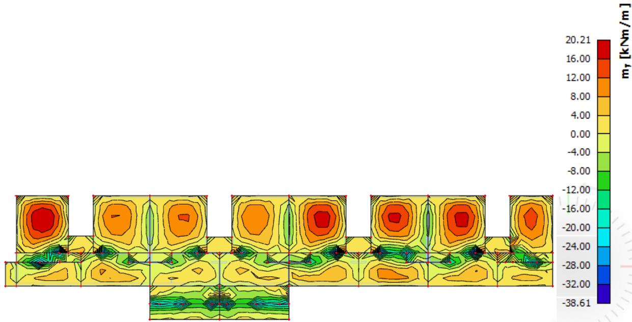
Slika 11.10. Rezultati momenata savijanja ploče pozicije 600 (GSN 1,  $M_y$ )
