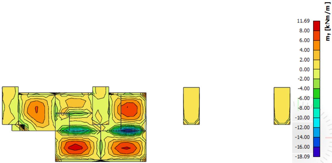
Slika 11.6. Rezultati momenata savijanja ploče pozicije 700 (GSU,  $M_y$ )
