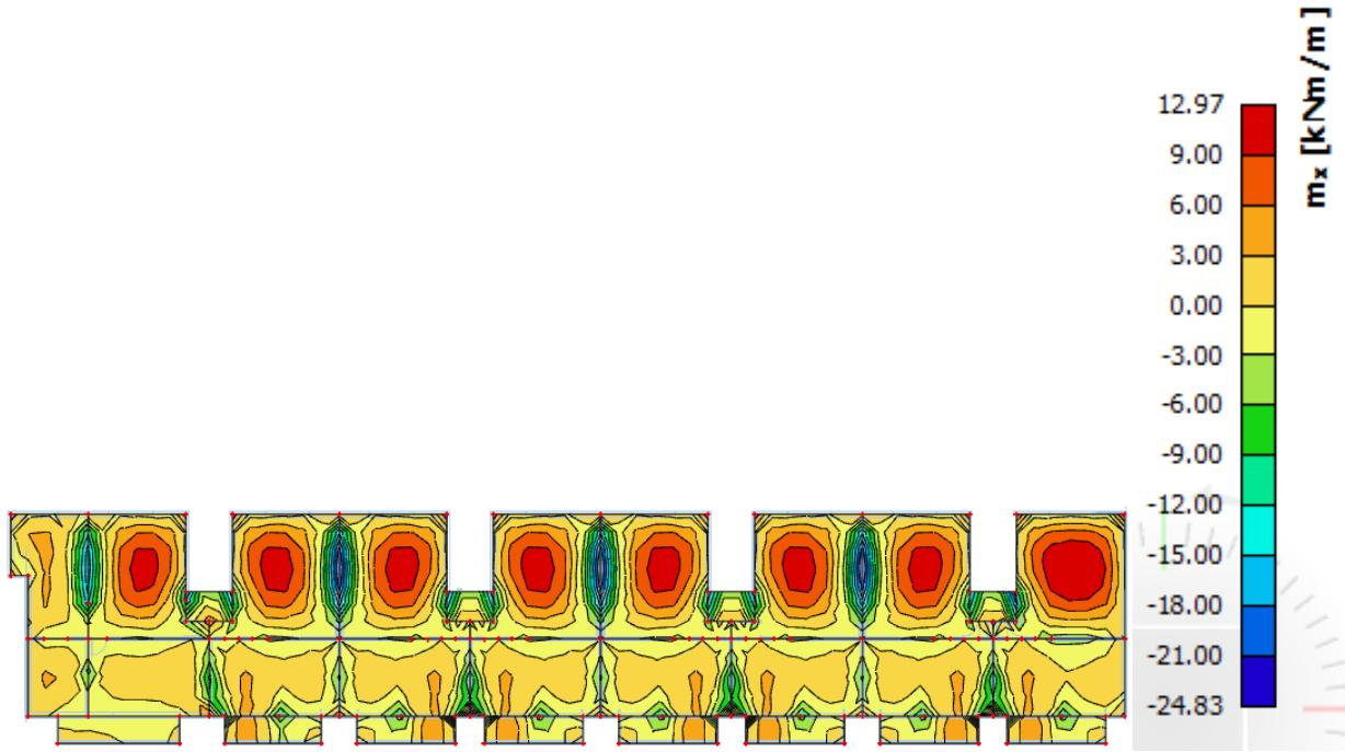
Slika 11.31. Rezultati momenata savijanja ploče pozicije 400 (GSU, M<sub>x</sub>)
