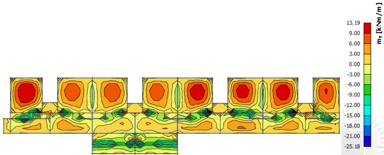
Slika 11.14. Rezultati momenata savijanja ploče pozicije 600 (GSU,  $M_y$ )
