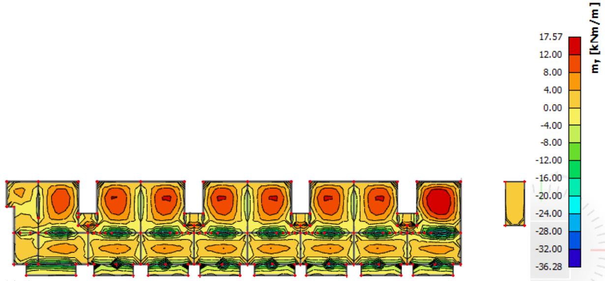
Slika 11.34. Rezultati momenata savijanja ploče pozicije 300 (GSN 1,  $M_y$ )
