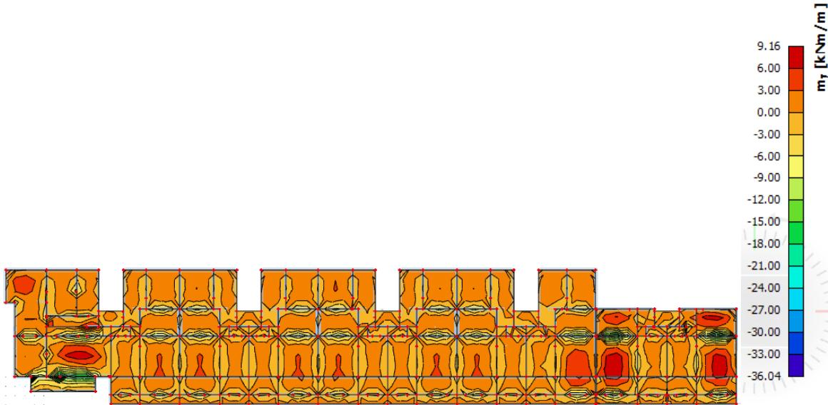
Slika 11.44. Rezultati momenata savijanja ploče pozicije 200 (GSN 2,  $M_y$ )
