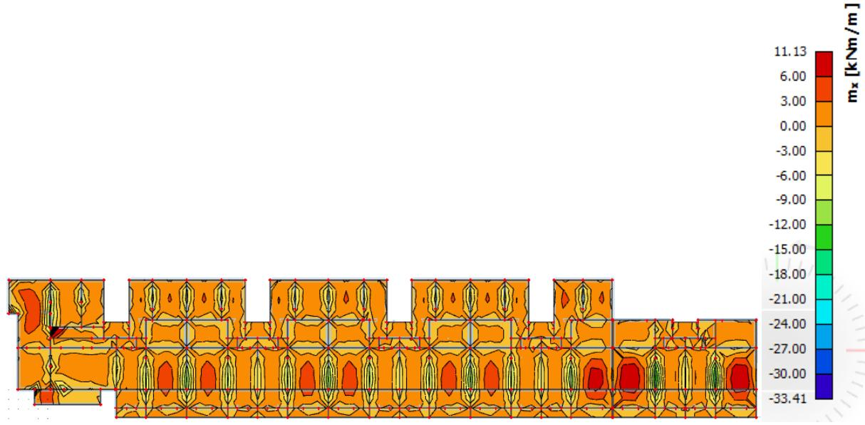
Slika 11.47. Rezultati momenata savijanja ploče pozicije 200 (GSU,  $M_x$ )
