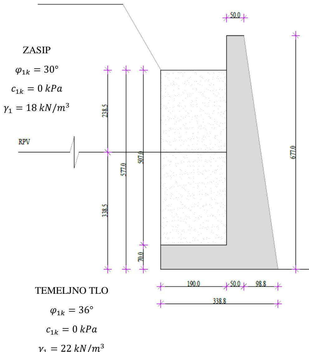
Slika 15.1. Dimenziye potpornog zida
