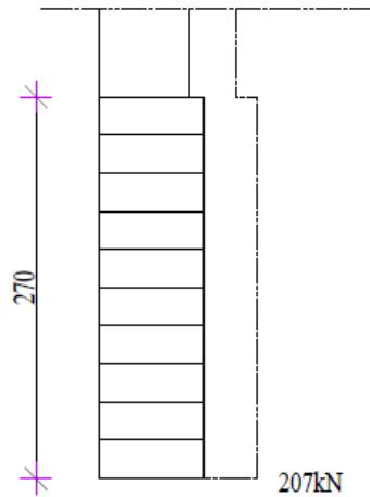
Slika 14.9. Ovojnica poprečnih sila  $V_y$  (kN)
