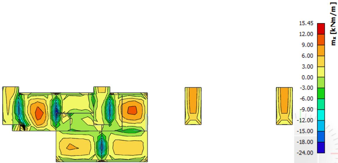
Slika 11.5. Rezultati momenata savijanja ploče pozicije 700 (GSN 2, M<sub>x</sub>)
