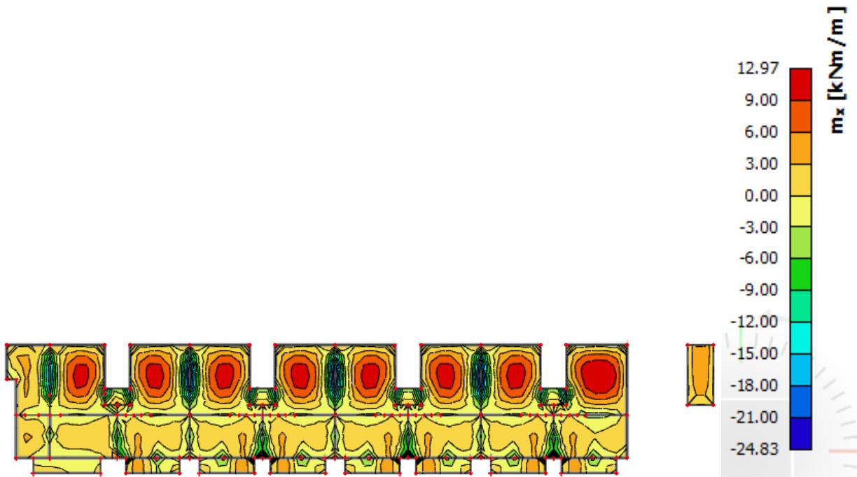
Slika 11.39. Rezultati momenata savijanja ploče pozicije 300 (GSU,  $M_x$ )
