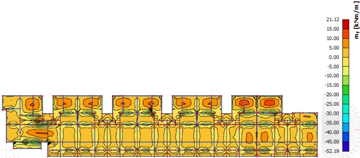
Slika 11.50. Rezultati momenata savijanja ploče pozicije 100 (GSN 1,  $M_y$ )
