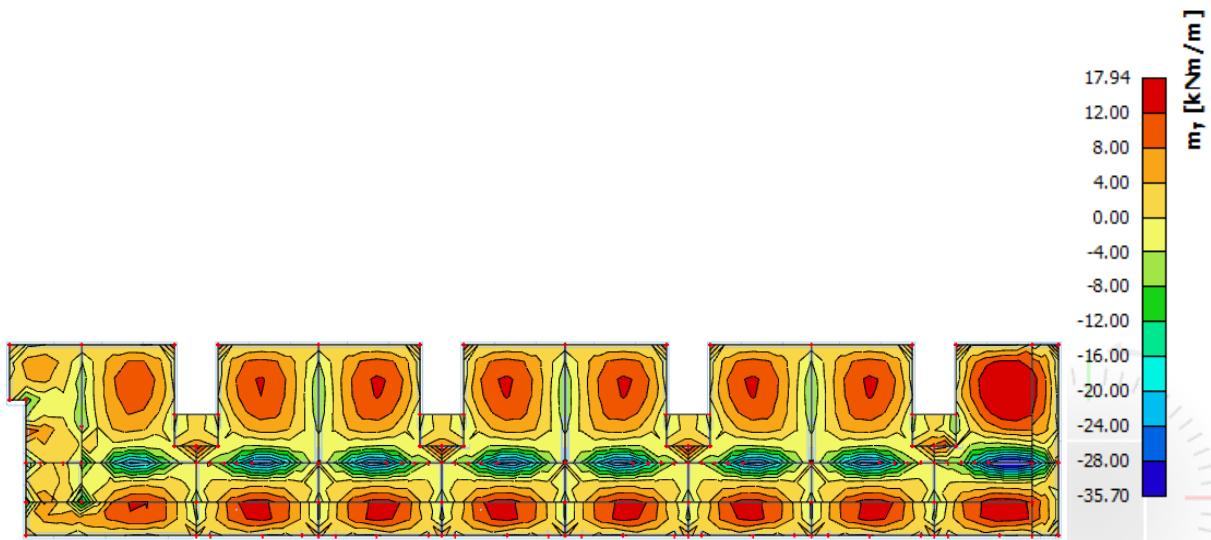
Slika 11.18. Rezultati momenata savijanja ploče pozicije 500 (GSN 1,  $M_y$ )
