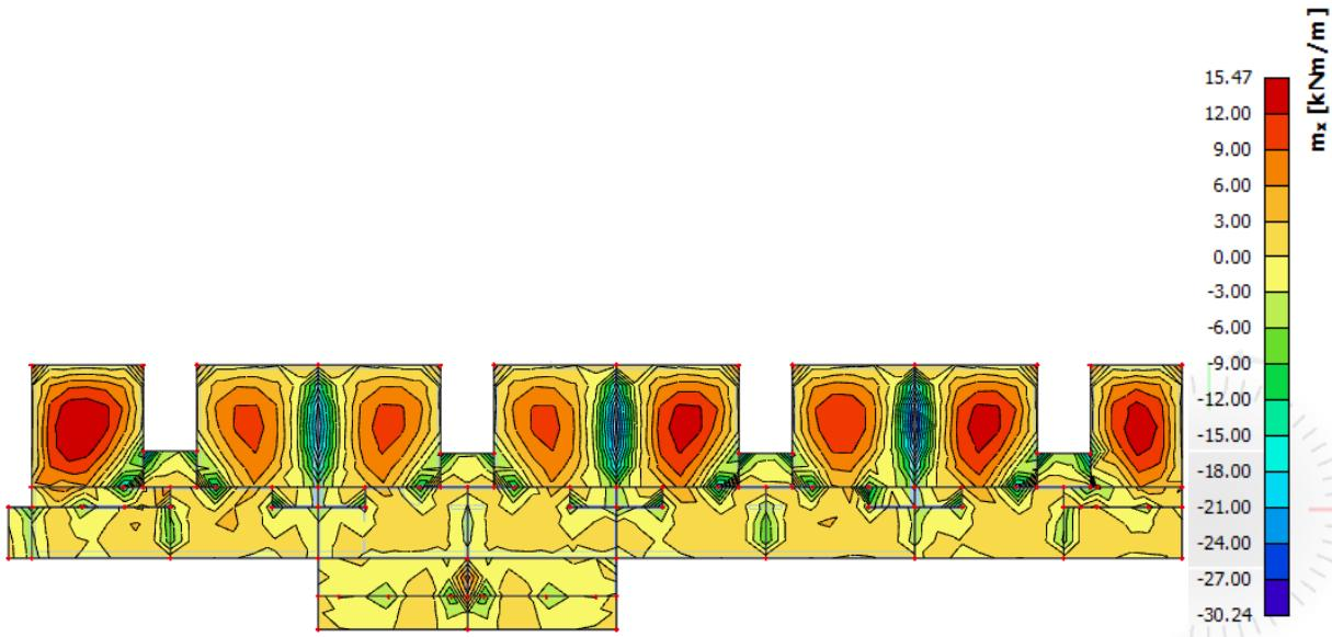
Slika 11.15. Rezultati momenata savijanja ploče pozicije 600 (GSU,  $M_x$ )
