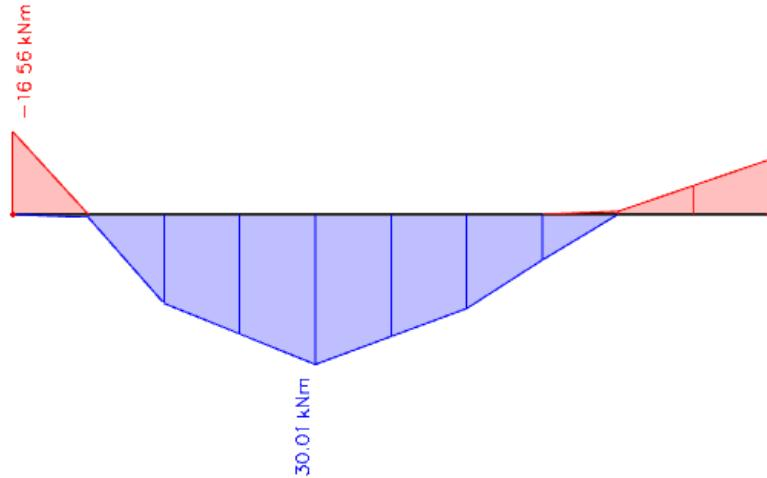
Slika 11.54. Rezultati momenata savijanja grede pozicije 704 (GSU, M<sub>y</sub>)Granična vrijednost širine pukotine:  $w_g = 0,3 \text{ mm}$
