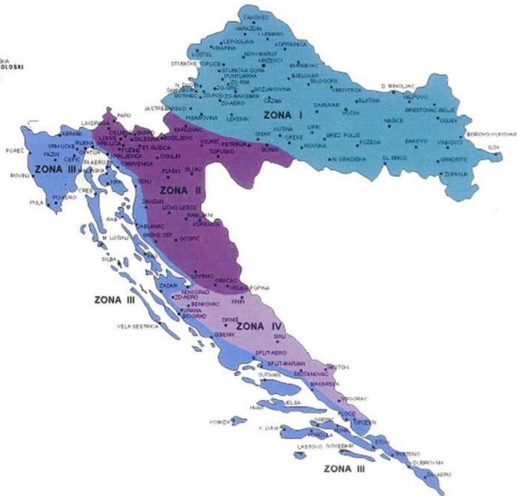
Slika br.29 Klimatske zone karakterističnog opterećenja snijegom [14]
