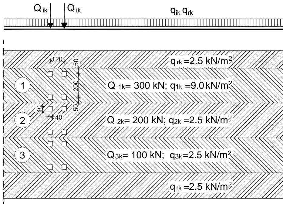
Slika 13. Prikaz načina opterećenja mosta pokretnim opterećenjem
