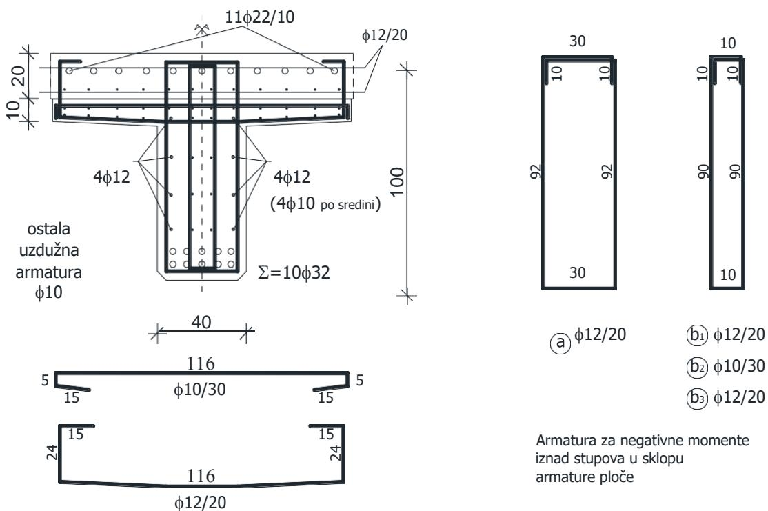
Slika 33. Prikaz armiranja nosača u presjeku a-a
