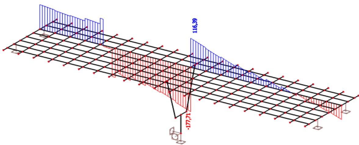
Slika 21. Pokretno - maksimalni moment pri stupu – poprečne sile ( $Vz$ ) u kN
