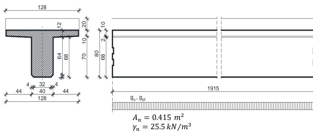
*Slika 2. Uzdužna i poprečna dispozicija jednog nosača*
