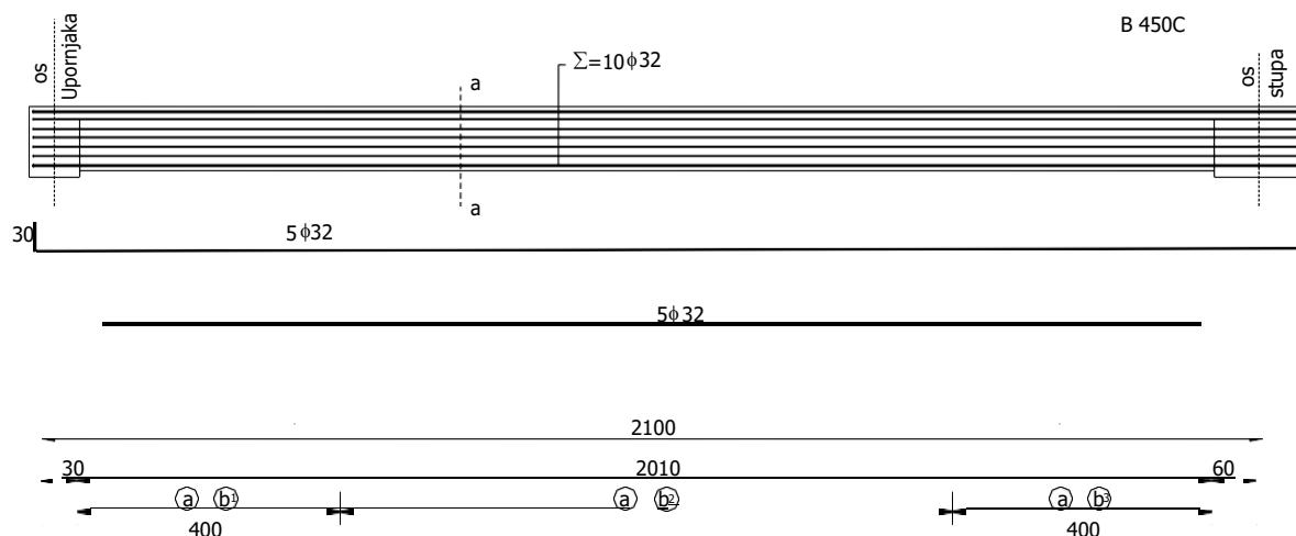
Slika 32. Prikaz armiranja uzdužnog nosača u polju
