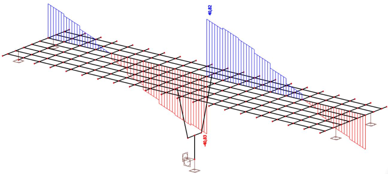
Slika 12. Dodatno stalno opterećenje-poprečne sile ( $V_z$ ) u kN
