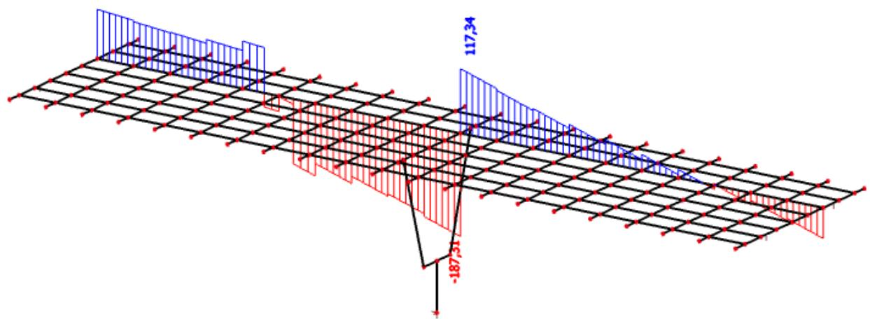
Slika 17. Pokretno - maksimalni moment u prvom polju – poprečne sile ( $Vz$ ) u kN
