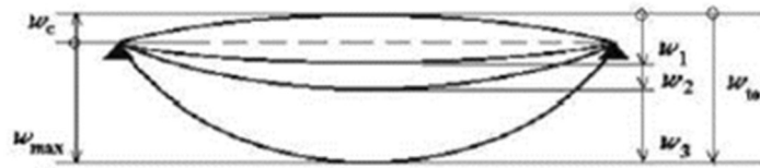
Slika 7.3 Prikaz progiba grede
