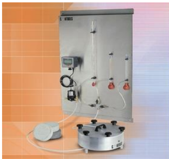
Slika 5.3 Uređaj za ispitivanje plino-propusnosti betona
