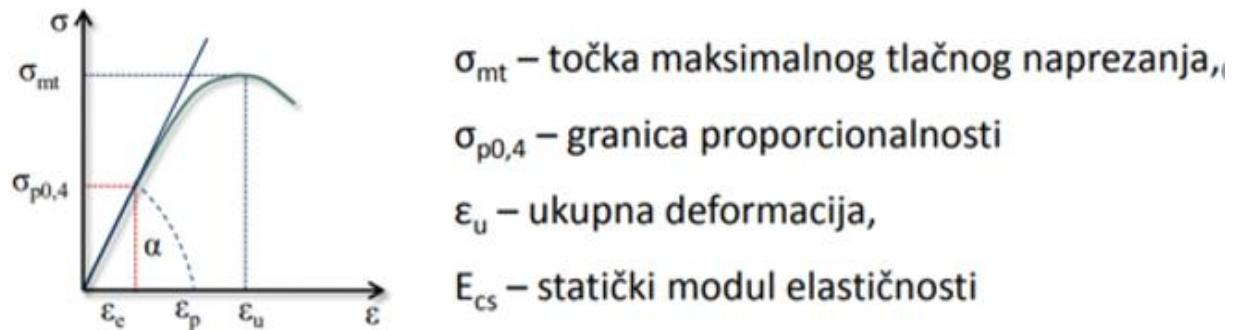
Slika 2. Graf ukupne deformacije betona pri kratkotrajnom opterećenju [2]
