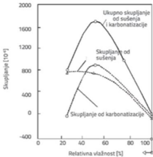
Slika 21. Skupljanje cementnog morta uslijed sušenja i karbonatizacije [5]
