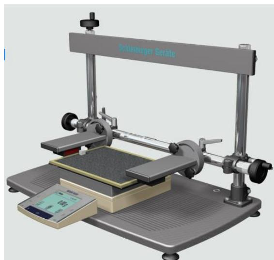
Slika 33. Uređaj za mjerjenje skupljanja tankih slojeva betona[11]
