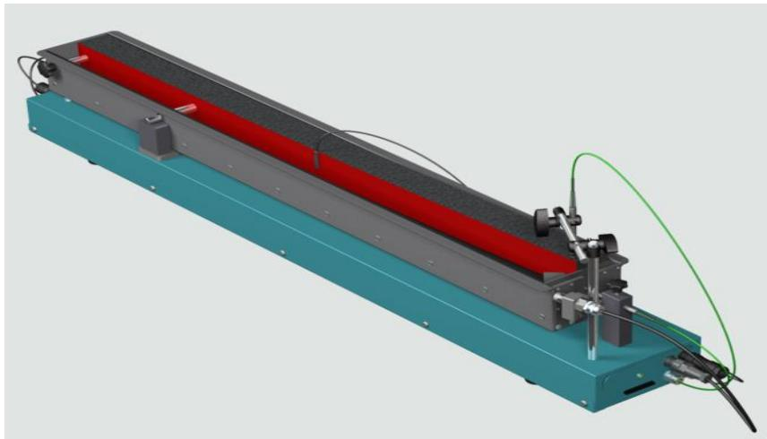
**Slika 36.** Odvod za savijanje uređaj za mjerjenje skupljanja estriha [11]
