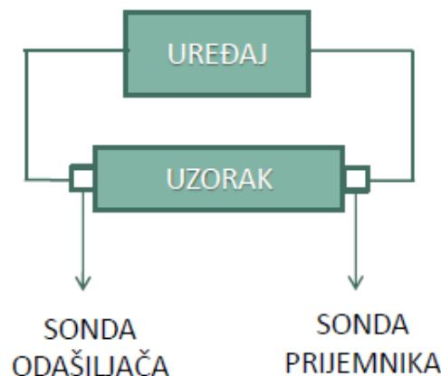
**Slika 5.** Shematski prikaz utvrđivanja dinamičkog modula elastičnosti [2]
