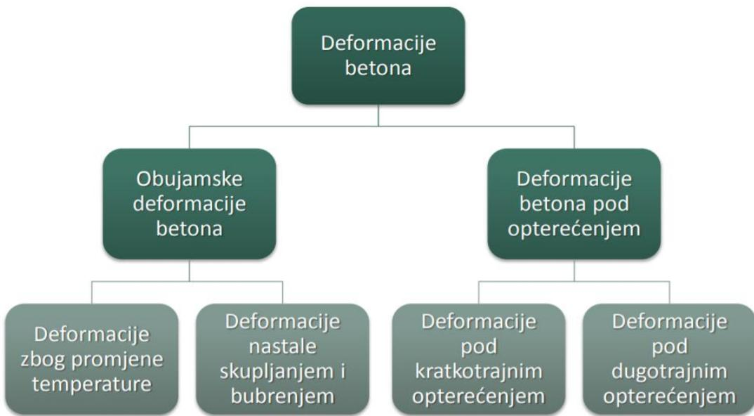
**Slika 1.** Podjela deformacija betona [2]
