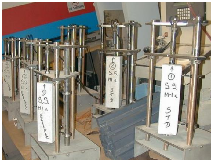
Slika 26. Prikaz više istovremenih testova skupljanja koristeći LVDT [12]
