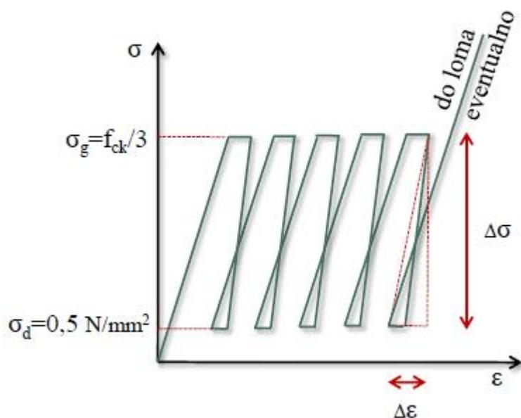
**Slika 4.** Graf određivanja statičkog modula elastičnosti treniranjem ispitnih uzoraka [2]
