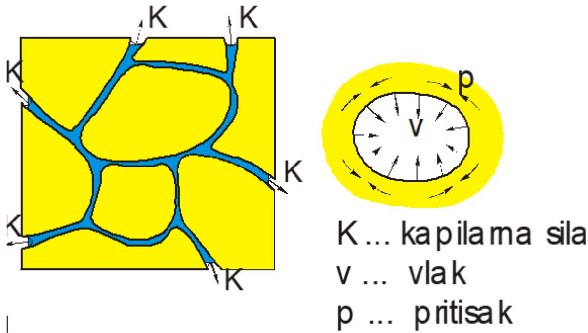
**Slika 8.** Shematski prikaz mehanizma skupljanja zbog sušenja, uzdužni presjek kapilarne mreže i poprečni presjek kapilara
