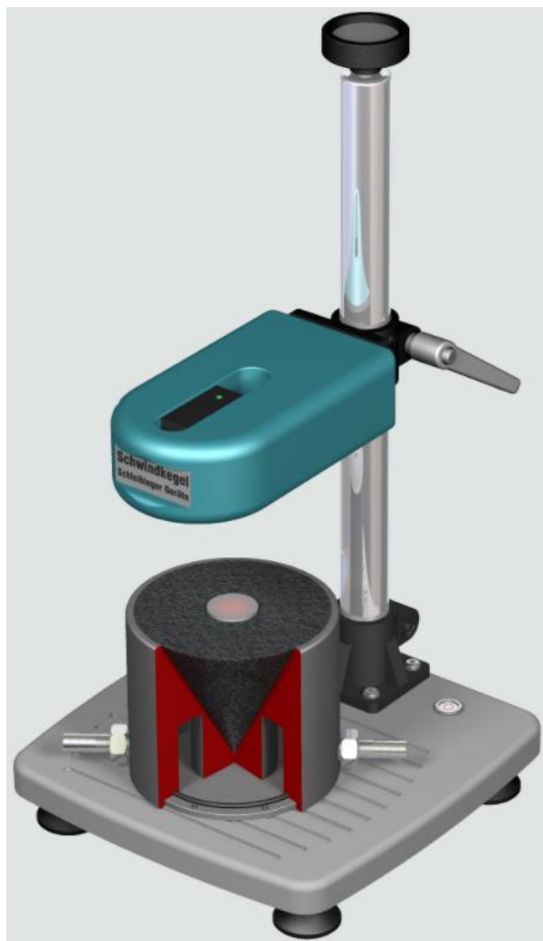
Slika 30. Uređaj konus za mjerenje skupljanja betona [11]
