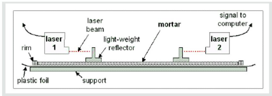
**Slika 34.** Shematski prikaz postupka mjerjenja skupljanja tankih slojeva betona [11]
