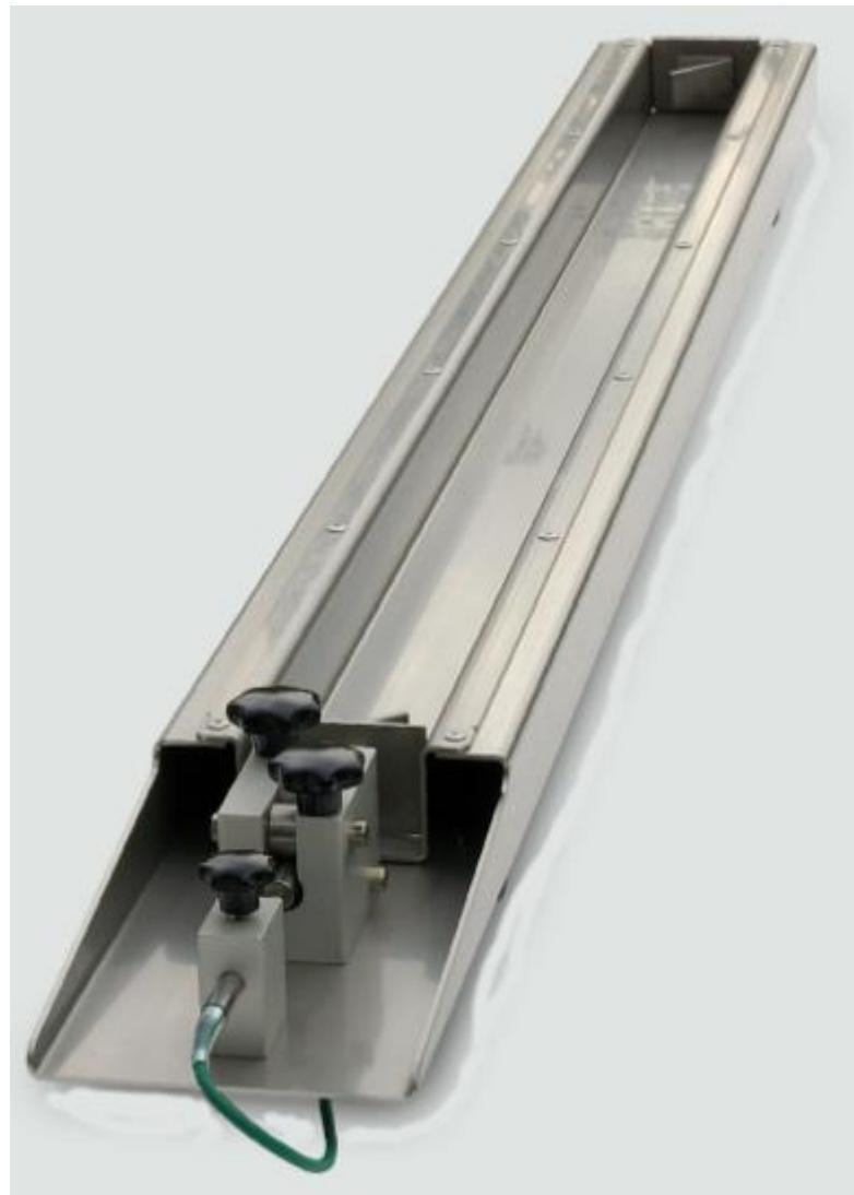
**Slika 29.** Odvod za mjerjenje skupljanja betona [11]
