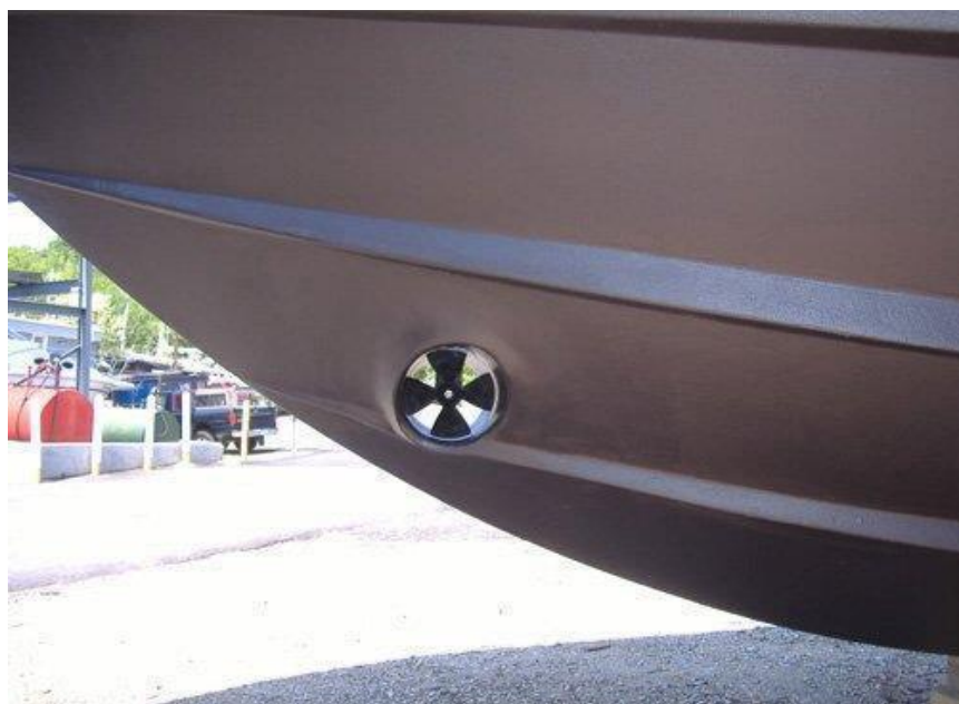
Slika 9. Pramčani propeler (eng. thruster)
