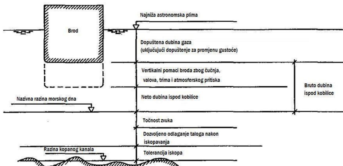
Slika 15. Dijelovi dubine
