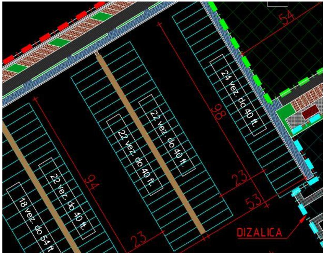
Slika 31. Prikaz prvog pontona na sekundarnom lukobranu
