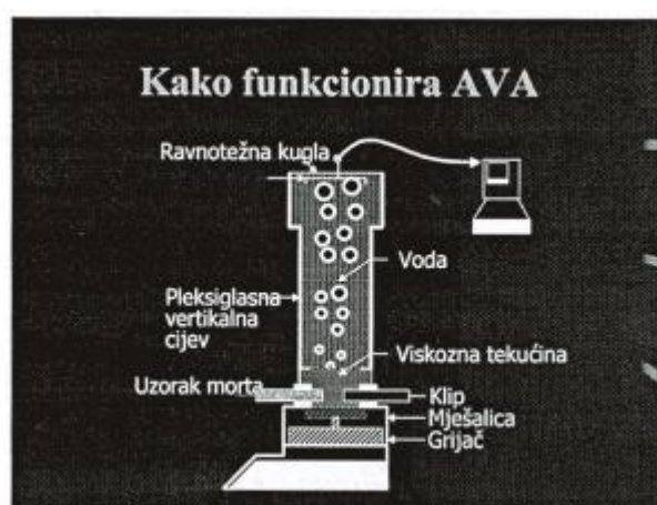
Slika 5.5 Shematski prikaz djelovanja analizatora zračnih pora [7]
