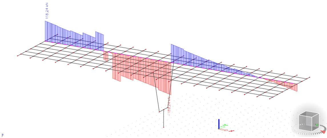
Slika 21. Pokretno - maksimalni moment pri stupu – poprečne sile ( $V_z$ ) u kN
