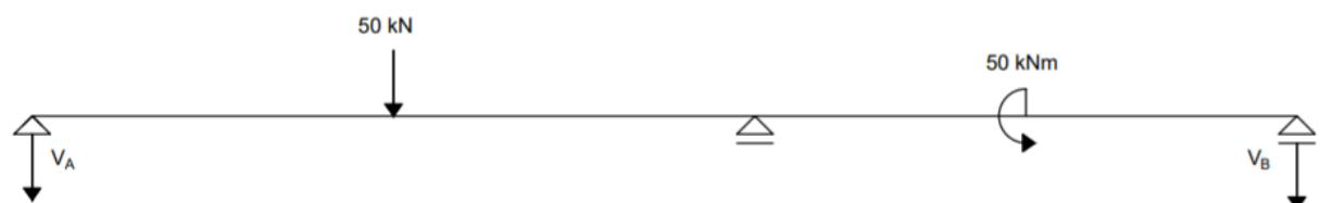
Slika 3.6. Reakcije uslijed vanjskog opterećenja
