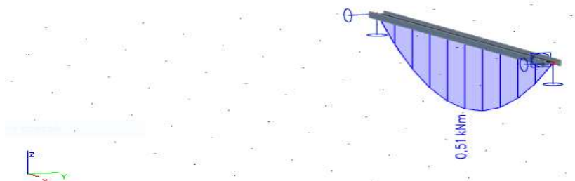
Slika 45 Momentni dijagram M_z za mjerodavnu kombinaciju
