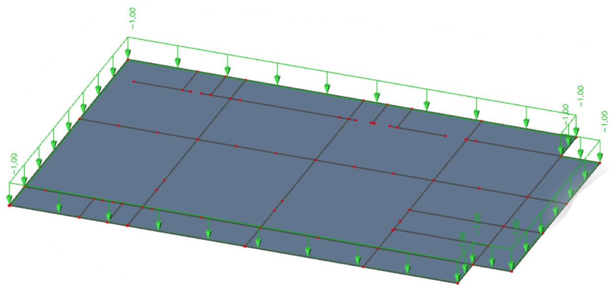
Slika 4.1.2 Promjenjivo djelovanje  $Q$  [ $\text{kN}/\text{m}^2$ ]
