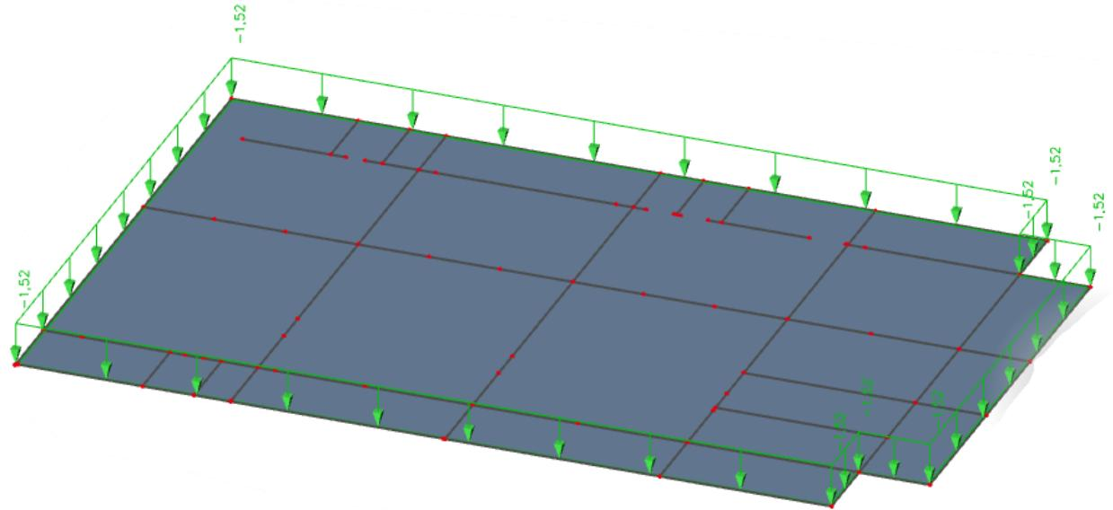
Slika 4.1.1 Dodatno stalno djelovanje  $G1$  [ $\text{kN}/\text{m}^2$ ]
