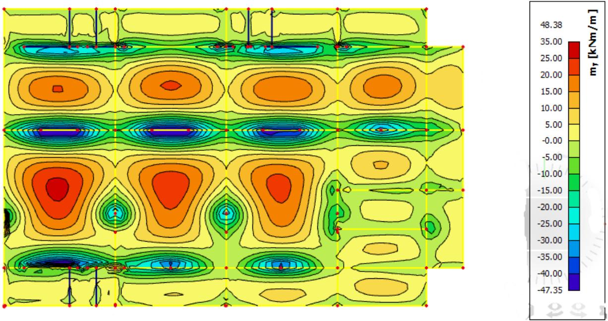
Slika 6.2.3 Moment savijanja  $M_{Ed,y}$  ( $\text{kNm}/\text{m}$ ) za GSN-1
