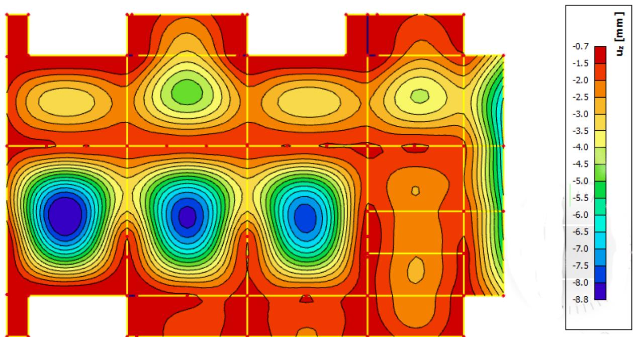
Slika 6.1.9 Progib ploče (mm) za kombinaciju GSU-1
