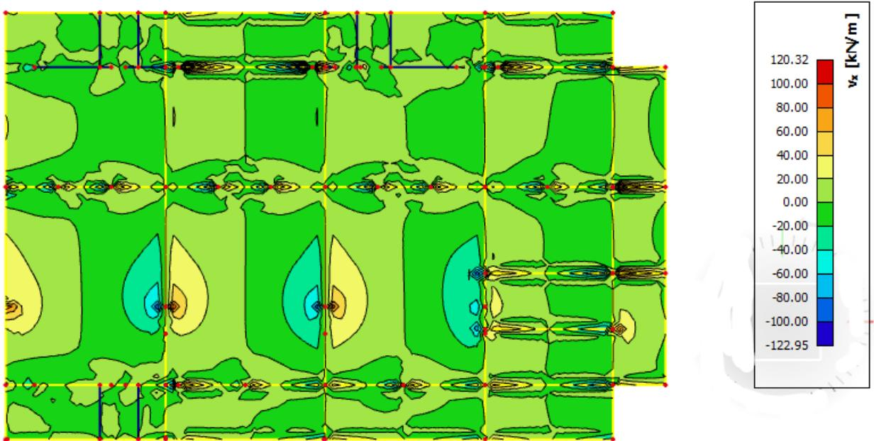
Slika 6.2.5 Poprečne sile  $V_{Ed,x}$  (kN/m) za GSN-1
