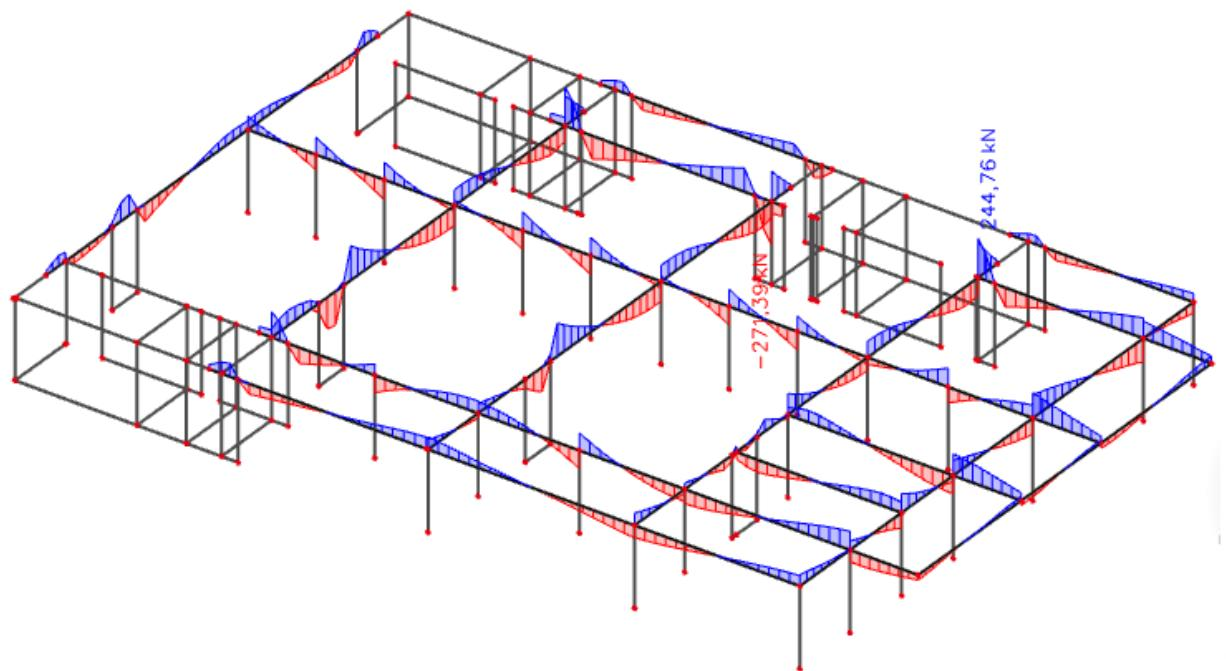
Slika 7.2.2 Poprečne sile  $V_{Ed,z}$  (kN/m) za GSN
