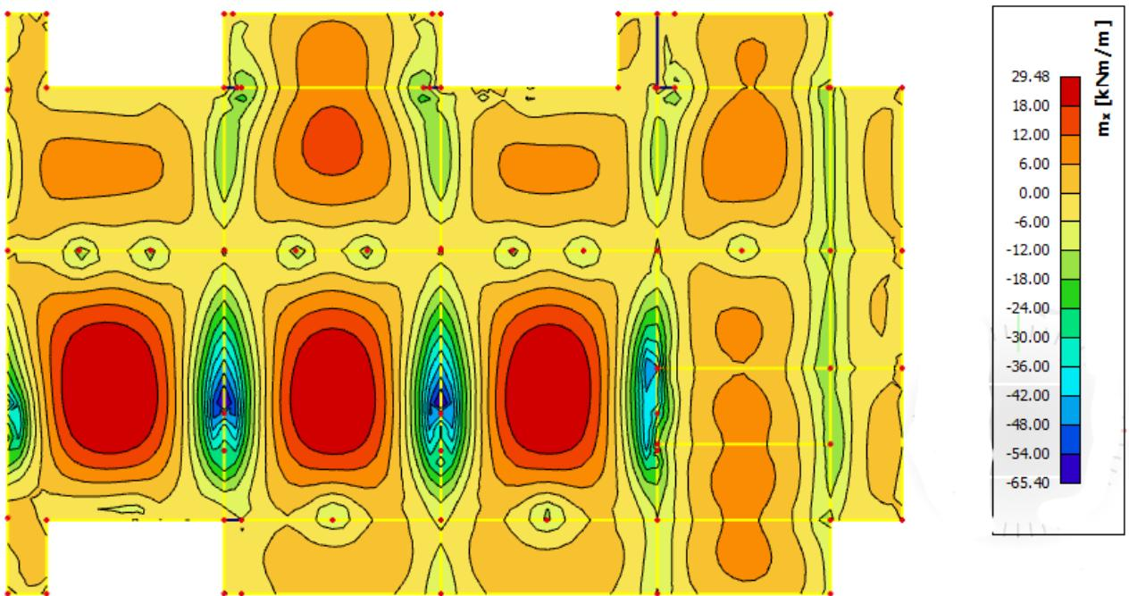
Slika 6.1.11 Moment savijanja  $M_{Ed,x}$  (kNm/m) za GSU-I
