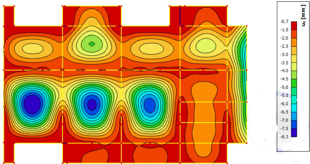
Slika 6.1.10 Progib ploče (mm) za kombinaciju GSU-2
