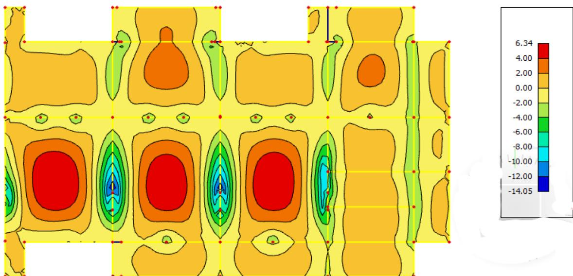
Slika 6.1.7 Potrebna površina armature  $A_s(cm^2/m)$  u x smjeru
