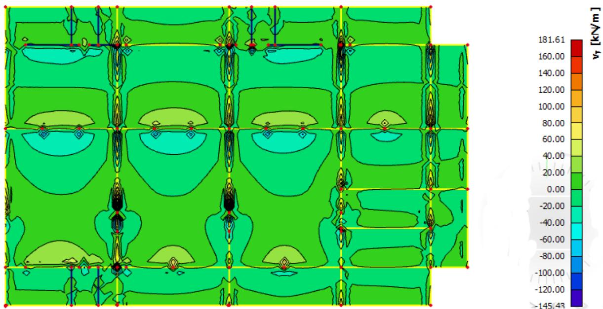
Slika 6.2.6 Poprečne sile  $V_{Ed,y}$  (kN/m) za GSN
