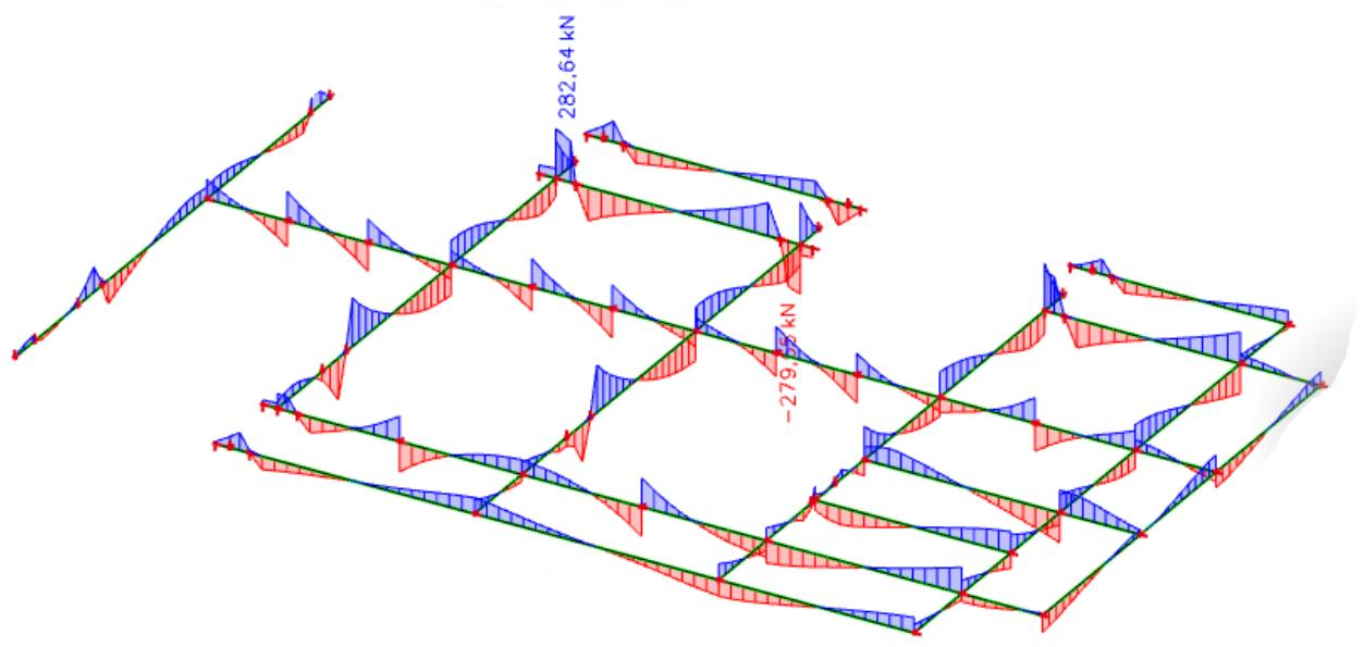
Slika 7.1.2 Poprečne sile  $V_{Ed,z}$  (kN/m) za GSN
