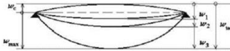
Slika 7.1.4 Prikaz progiba grede
