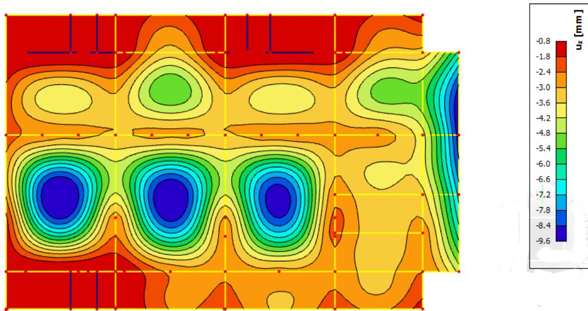
Slika 6.2.9 Progib ploče (mm) za kombinaciju GSU-1
