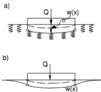
Slika 11.2. Winklerov model (a) i stvarni nosač (b)
