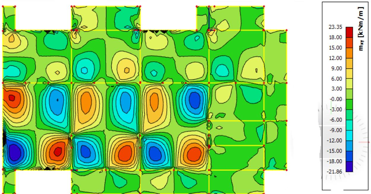
Slika 6.1.4 Moment savijanja  $M_{Ed,xy}$  (kNm/m) za GSN-1
