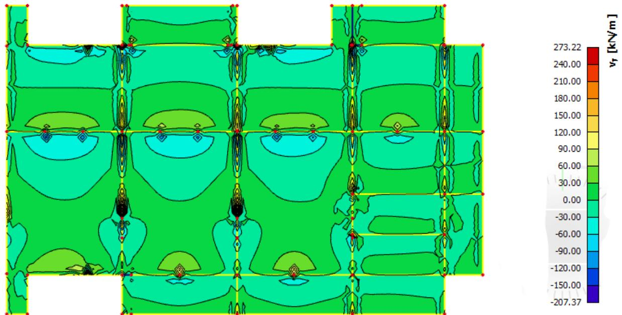
Slika 6.1.6 Poprečne sile  $V_{Ed,y}$  (kN/m) za GSN-I
