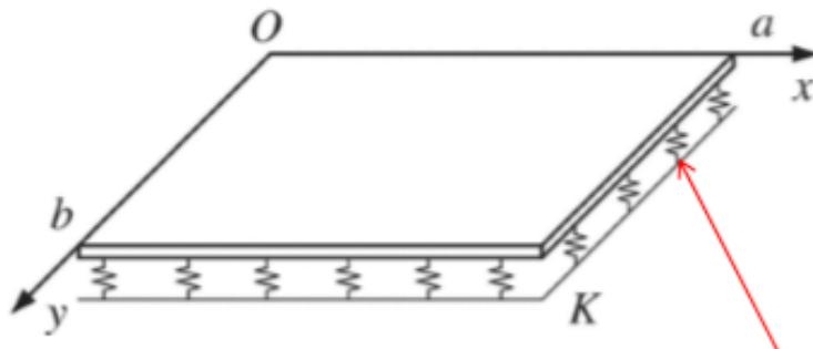
Slika 11.1. Međudjelovanje konstrukcija – tlo modelirano Winkler- ovim modelom
