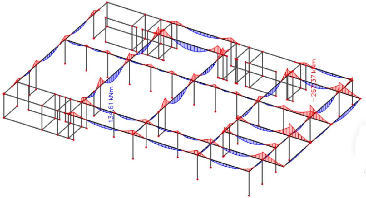
Slika 7.2.5 Moment savijanja  $M_{Ed,y}$  (kNm) za GSU-1
