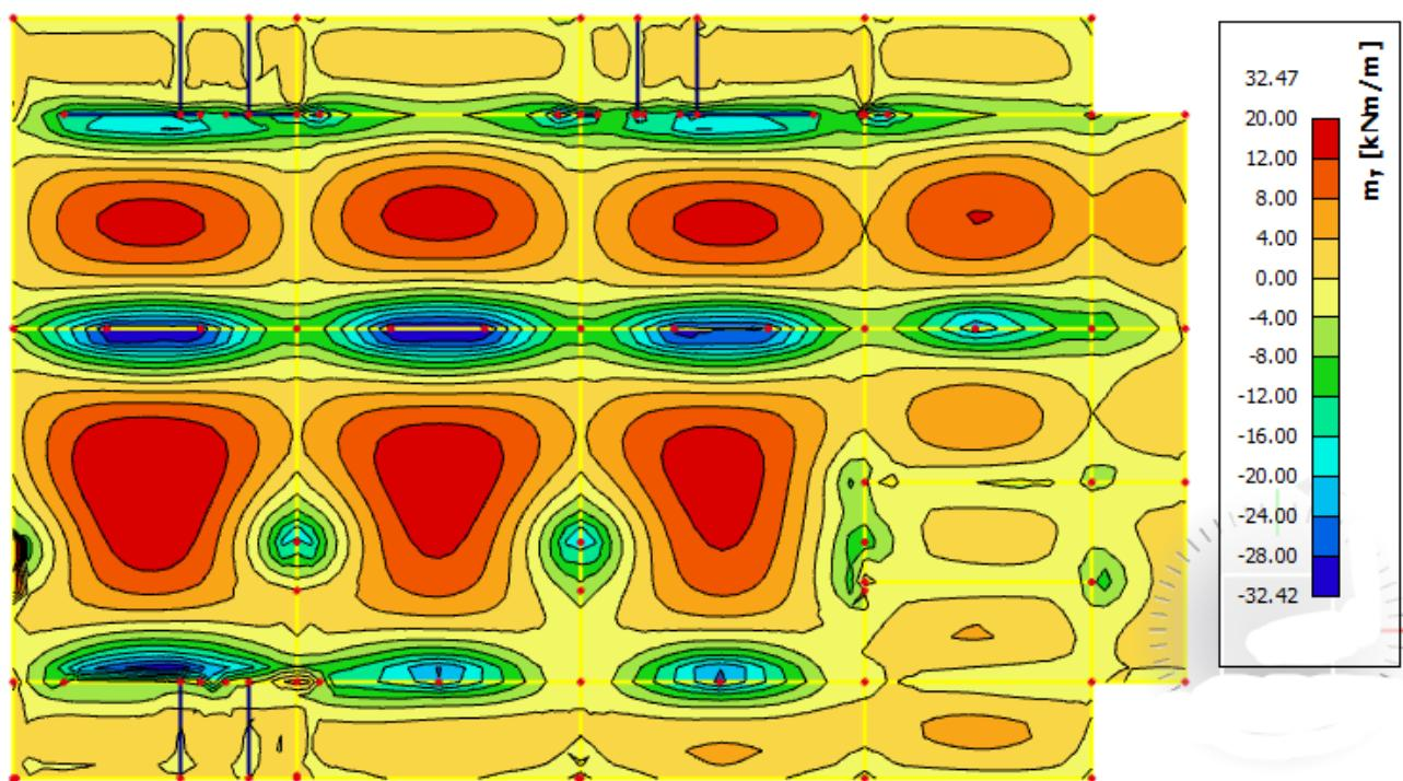
Slika 6.2.12 Moment savijanja  $M_{Ed,y}$  (kNm/m) za GSU-1
