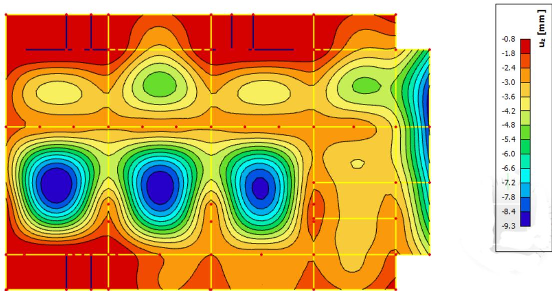
Slika 6.2.10 Progib ploče (mm) za kombinaciju GSU-2
