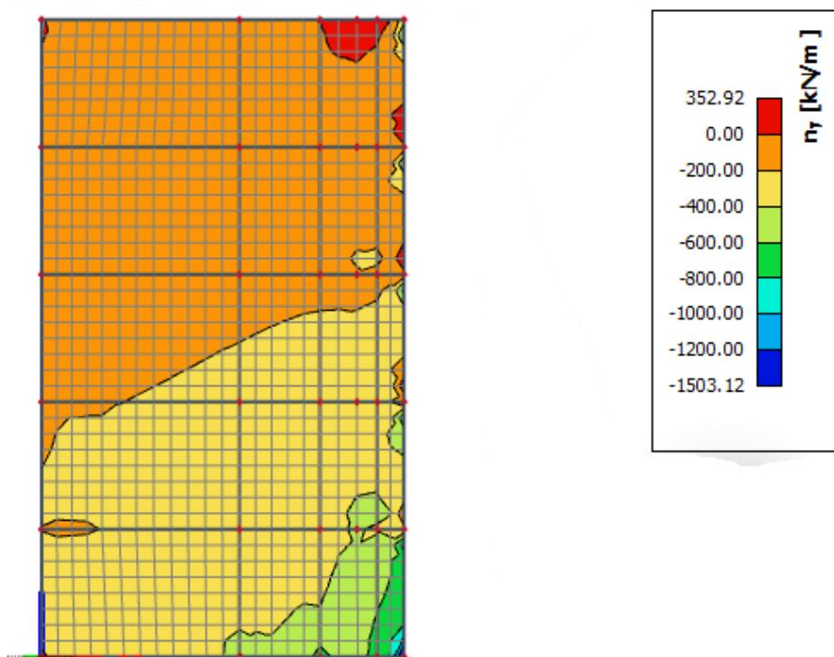
Slika 8.6 Uzdužne sile smjer Y u zidovima za anvelopu GSN
