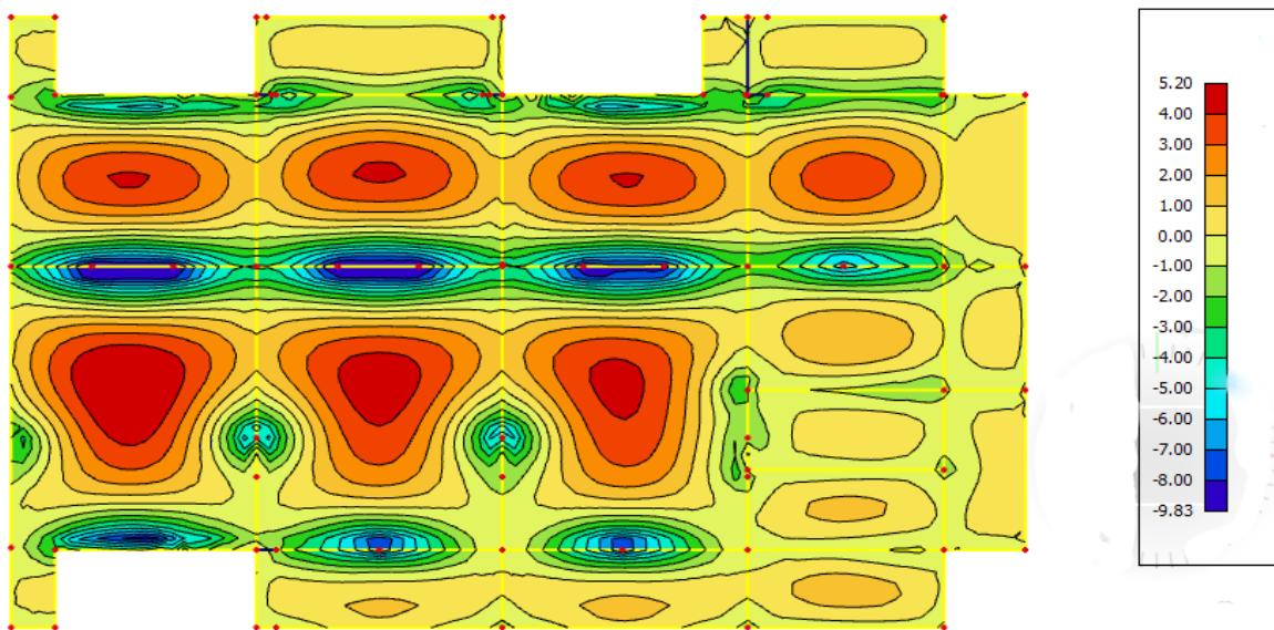
Slika 6.1.8 Potrebna površina armature  $A_s(cm^2/m)$  u y smjeru
