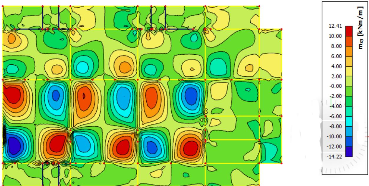
Slika 6.2.4 Moment savijanja  $M_{Ed,xy}$  ( $\text{kNm}/\text{m}$ ) za GSN-1
