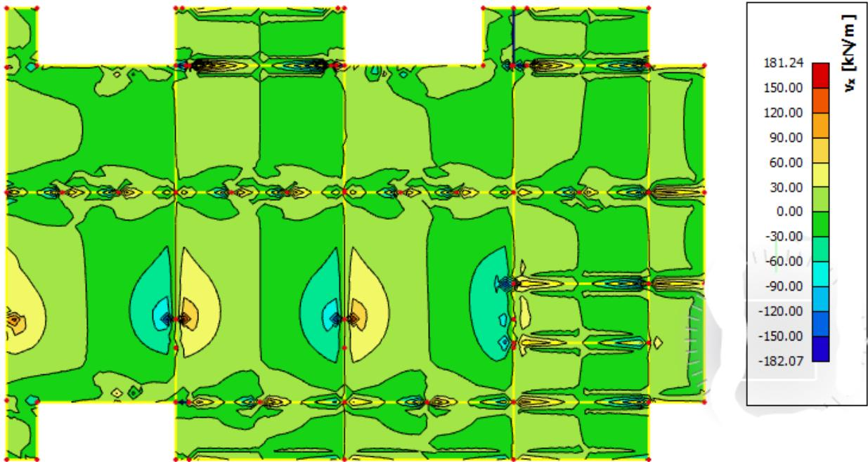
Slika 6.1.5 Poprečne sile  $V_{Ed,x}$  (kN/m) za GSN-I
