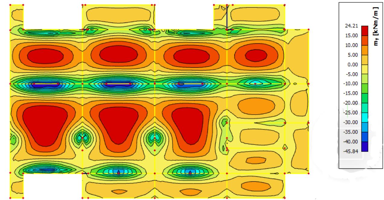
Slika 6.1.12 Moment savijanja  $M_{Ed,y}$  (kNm/m) za GSU-I
