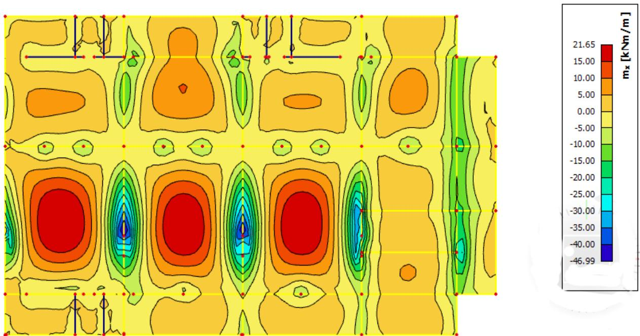
Slika 6.2.11 Moment savijanja  $M_{Ed,x}$  (kNm/m) za GSU-1
