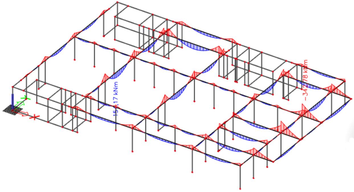
Slika 7.1.6 Moment savijanja  $M_{Ed,y}$  (kNm/m) za GSU-1
