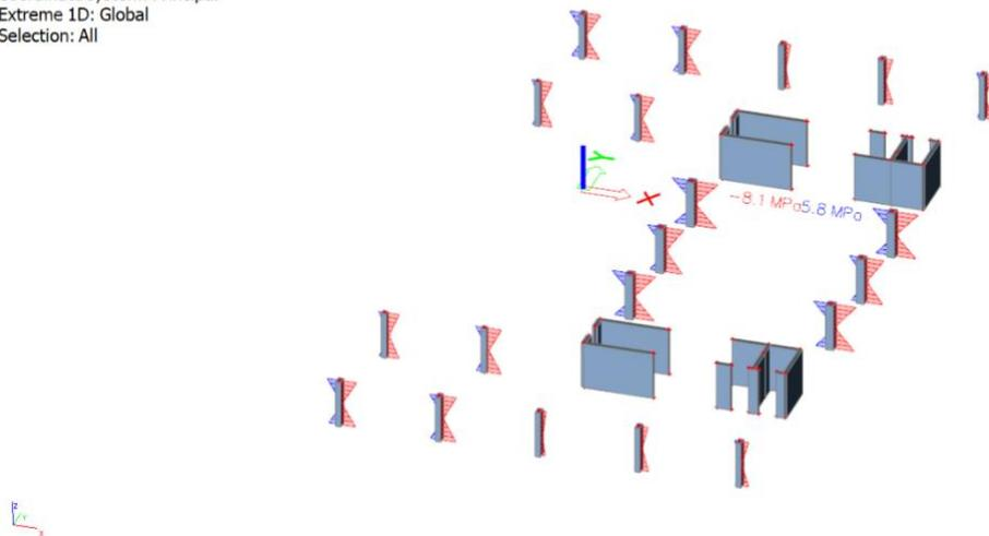
Slika 9.2 Srednje tlačno napreznje u stupovima  $\sigma_{c,Ed}$  (MPa) za GSU-2
