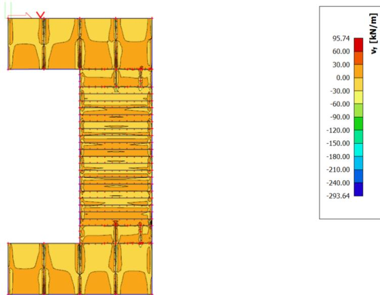
Slika 6.2.5 Poprečne sile  $V_{Ed,y}$  (kN/m) za GSN
