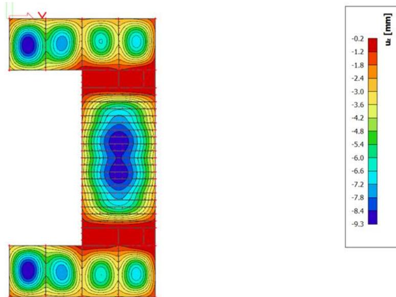
Slika 6.1.6 Progib ploče (mm) za kombinaciju GSU-1
