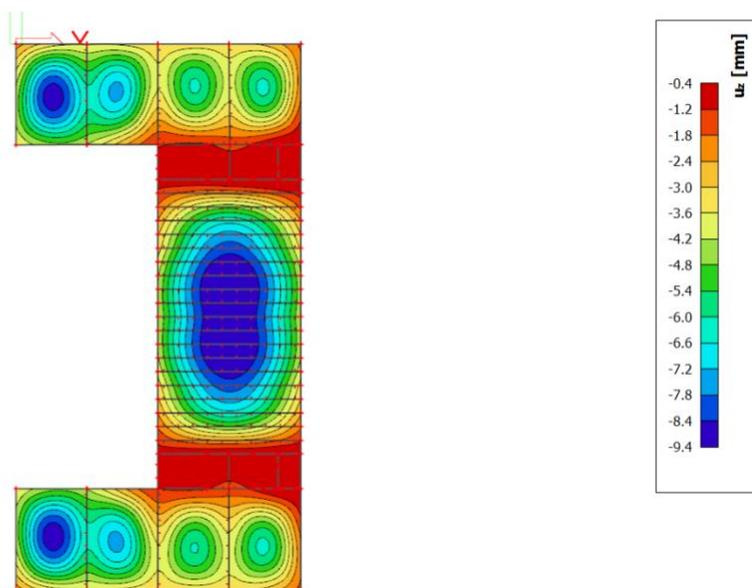
*Slika 6.2.7 Progib ploče (mm) za kombinaciju GSU-2*
