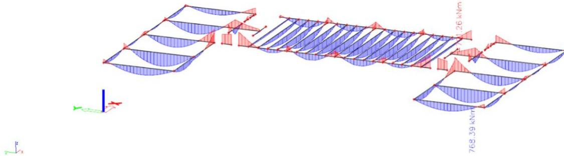
Slika 7. 1. 6 Moment savijanja  $M_{Ed,y}$  (kNm/m) za GSU-1
