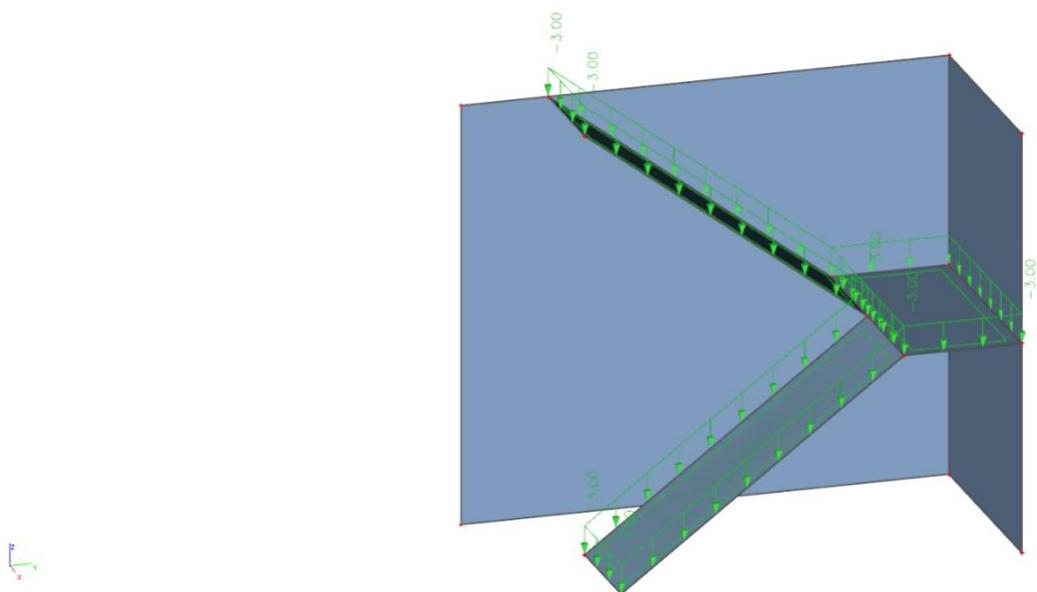
Slika 4.3.2 Promjenjivo djelovanje  $Q$  [ $\text{kN/m}^2$ ]
