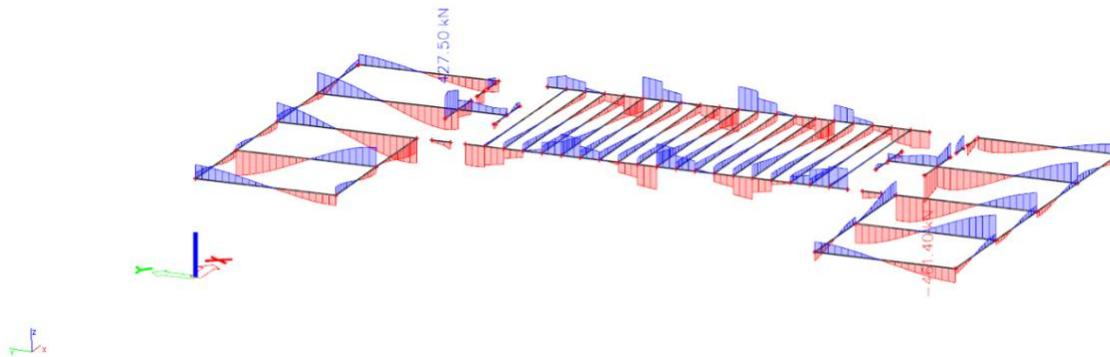
Slika 7.1.2 Poprečne sile  $V_{Ed,z}$  (kN/m) za GSN
