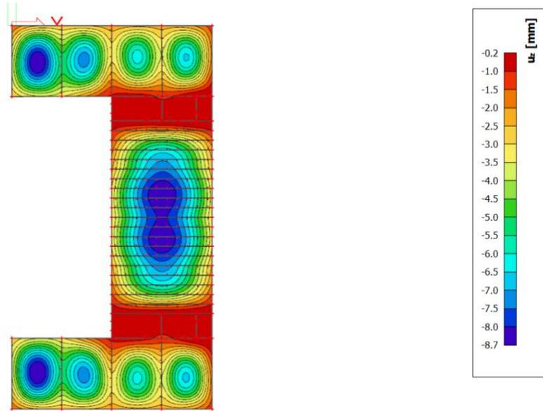
Slika 6.1.7 Progib ploče (mm) za kombinaciju GSU-2
