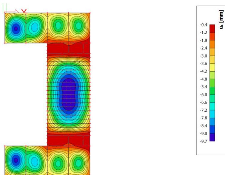
Slika 6.2.6 Progib ploče (mm) za kombinaciju GSU-1
