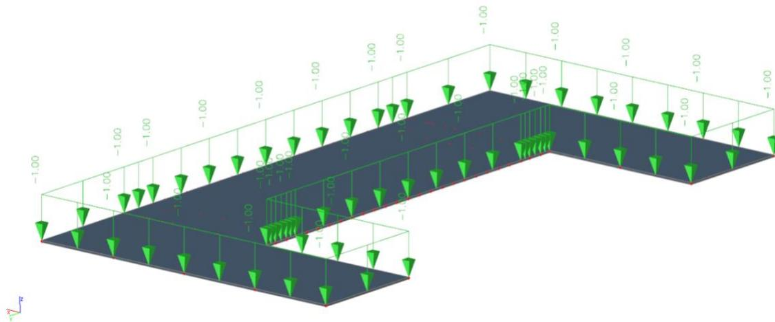
Slika 4.1.2 Promjenjivo djelovanje  $Q$  [ $\text{kN/m}^2$ ]
