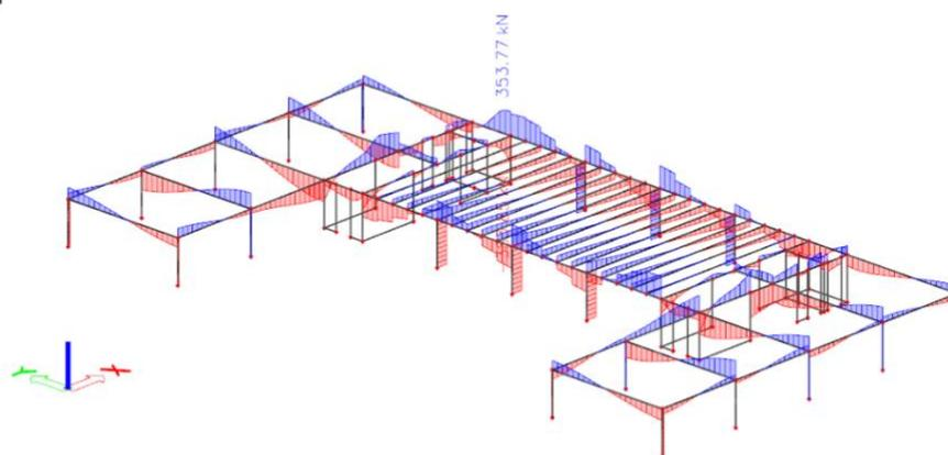
Slika 7.2.2 Poprečne sile  $V_{Ed,z}$  (kN/m) za GSN
