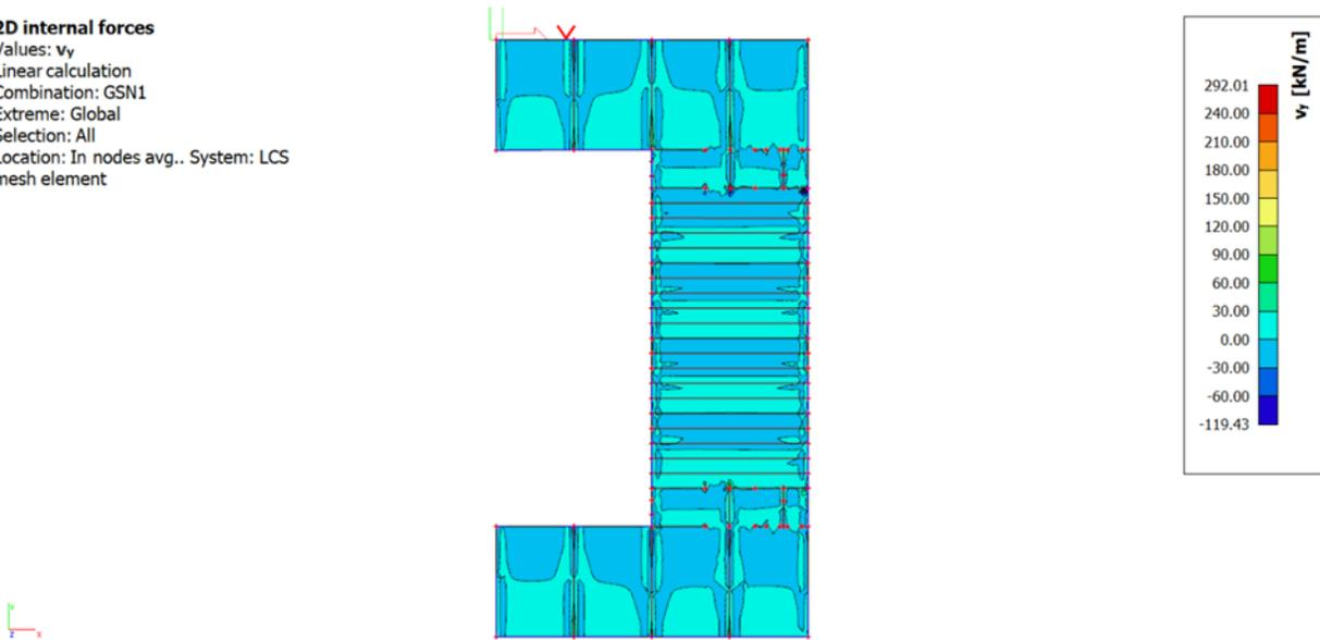
Slika 6.1.5 Poprečne sile  $V_{Ed,y}$  (kN/m) za GSN-1
