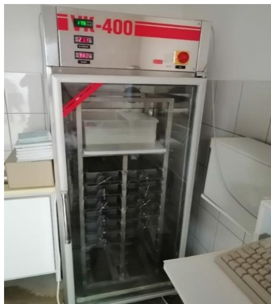
Slika 48. Komora za čuvanje uzoraka pri standardnoj temperaturi i vlazi
