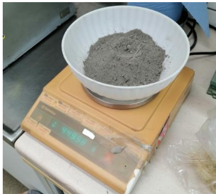
Slika 41. Izvagana količina cementa korištena za izradu jedne mješavine morta
