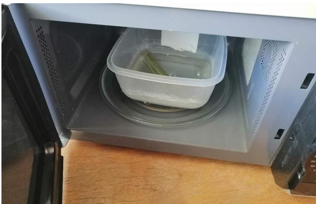
Slika 36. Posuda sa otopinom NaOH i grančicama brnistre u mikrovalnoj pećnici
