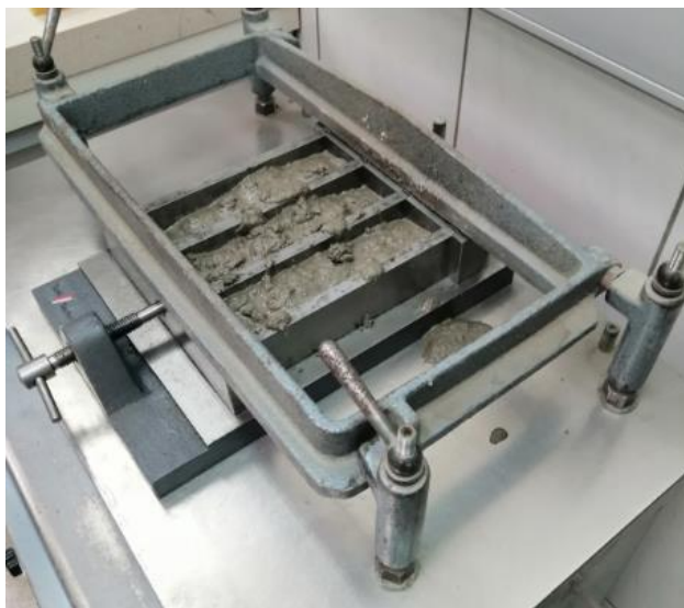
Slika 46. Vibrostol sa trodijelnim kalupom i mješavinom
