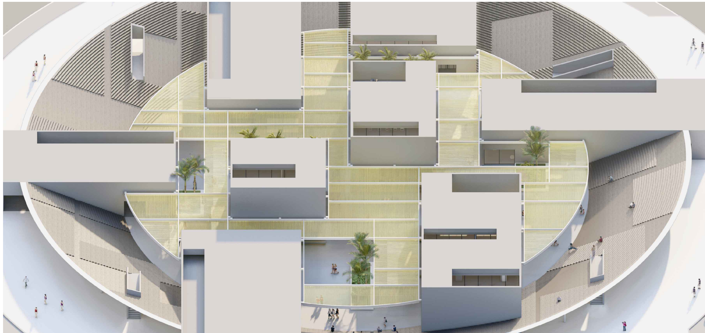
Nastrešnica od trske se točkasto pridržava za pune volumene što stvara doživljaj njenog lebdenja.
