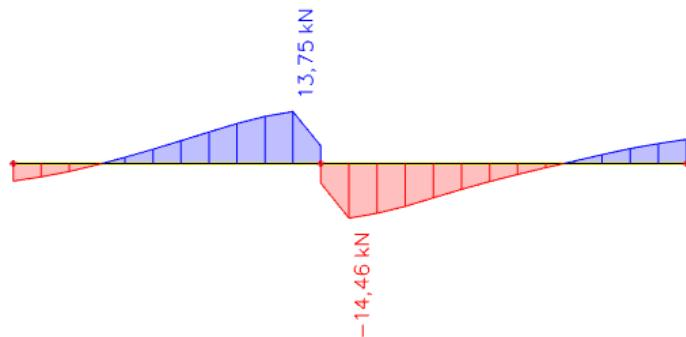
*Slika 83. Prikaz poprečne sile  $V_z$  od pokretnog opterećenja za gredu G 502*
