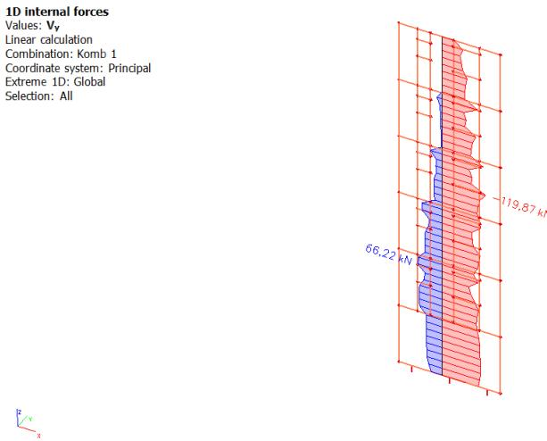
Slika 128. Dijagram poprečne sile Vy za kombinaciju K1
