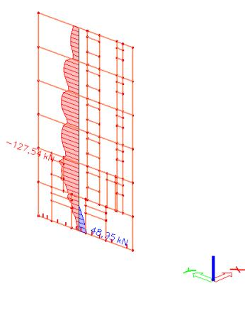
Slika 131. Dijagram poprečne sile  $V_y$  za kombinaciju K2
