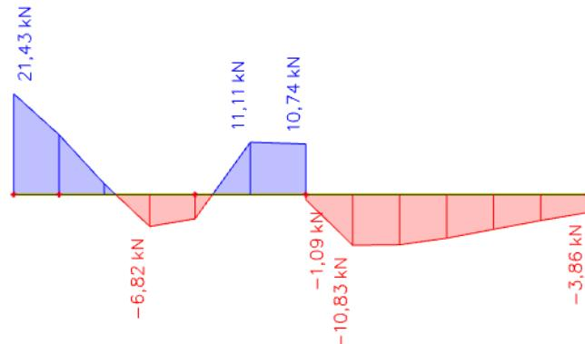
Slika 62. Prikaz poprečne sile  $V_z$  od pokretnog opterećenja za gredu G 101
