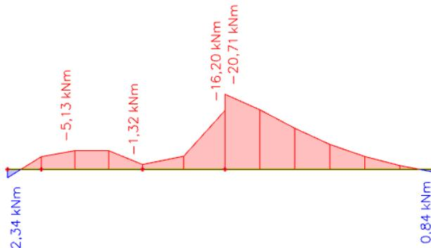
Slika 61. Prikaz momenta savijanja  $M_y$  od pokretnog opterećenja za gredu G 101
