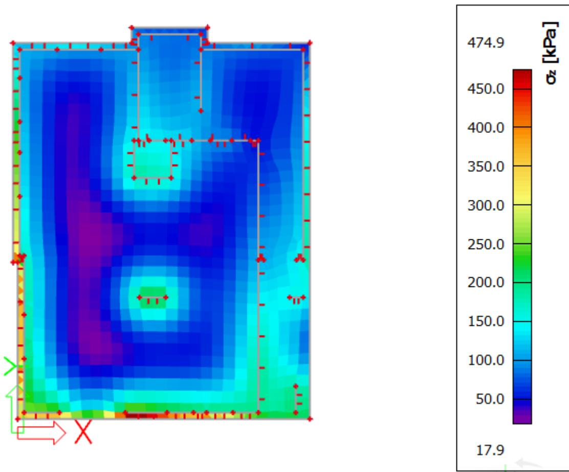
Slika 119. Prikaz kontaktnih naprezanja u temeljnoj ploči
