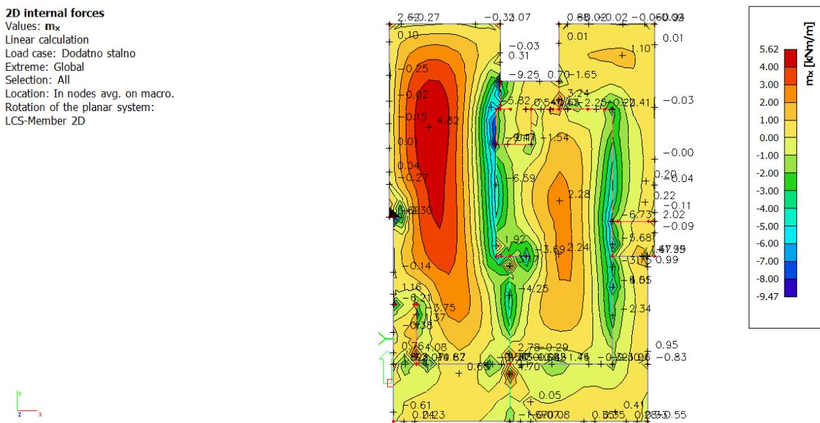
Slika 41. Moment savijanja  $M_x$
