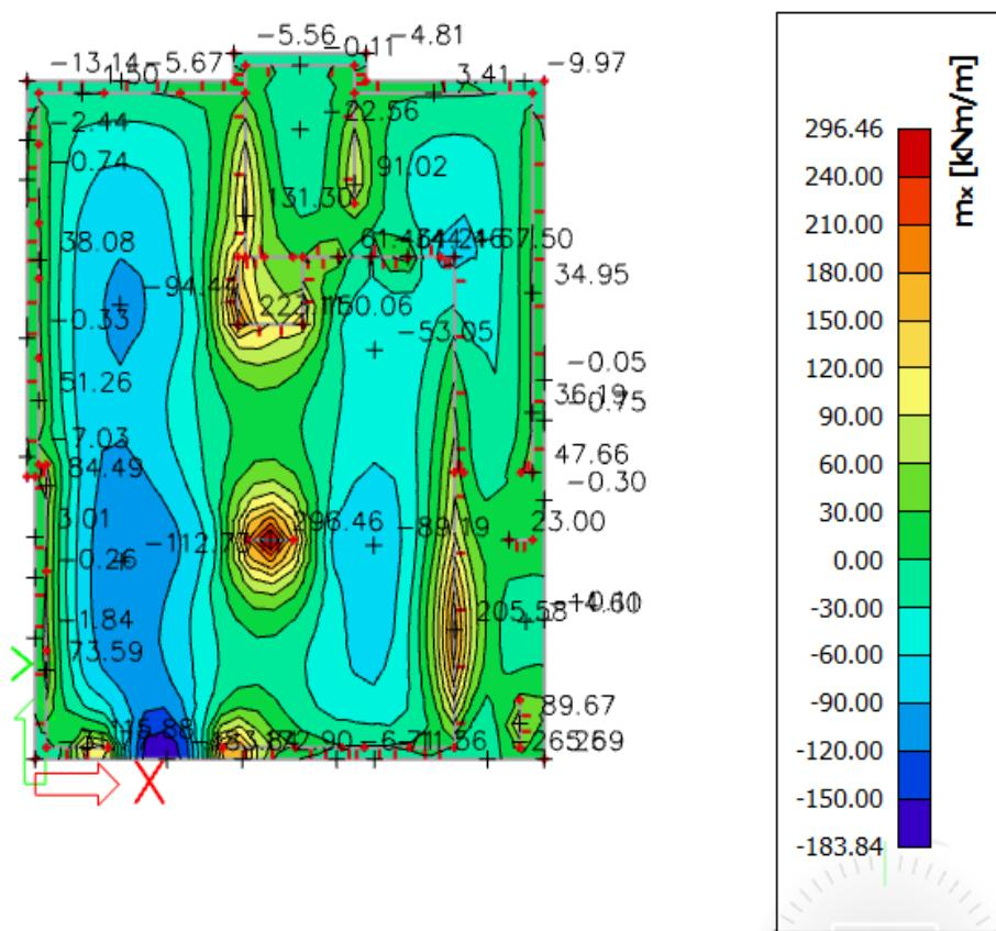
Slika 120. Prikaz momenata savijanja  $M_x$  u temeljnoj ploči
