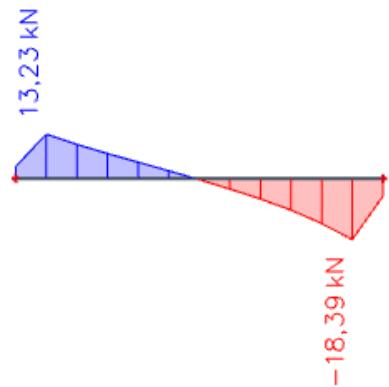
Slika 114. Prikaz poprečnih sila od vlastite težine za gredu G 604
