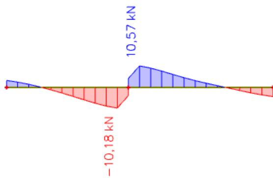
Slika 88. Prikaz poprečne sile od dodatnog stalnog opterećenja za gredu G 602
