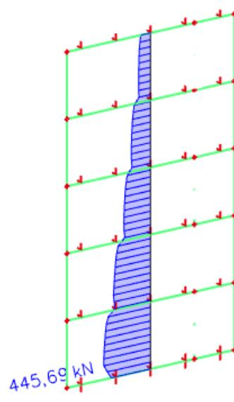
Slika 137. Poprečna sila  $V_y$
