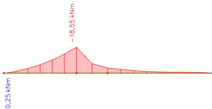
Slika 101. Prikaz momenata savijanja od dodatnog stalnog opterećenja za gredu G 603
