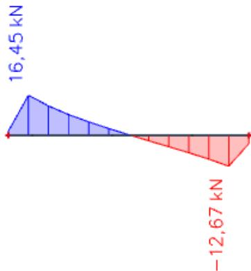
Slika 107. Prikaz poprečnih sila od vlastite težine za gredu G 204
