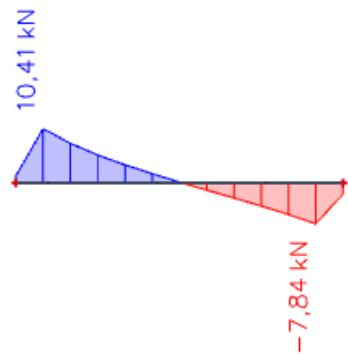
Slika 111. Prikaz poprečnih sila od pokretnog opterećenja za gredu G 204
