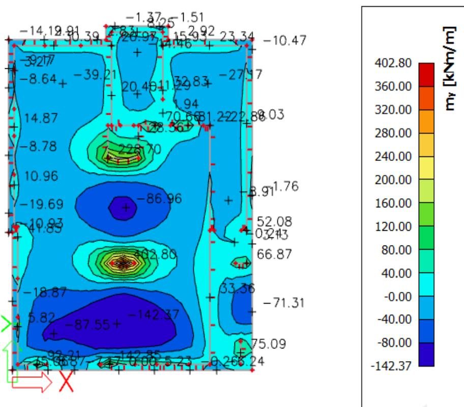
Slika 121. Prikaz momenata savijanja  $M_y$  u temeljnoj ploči
