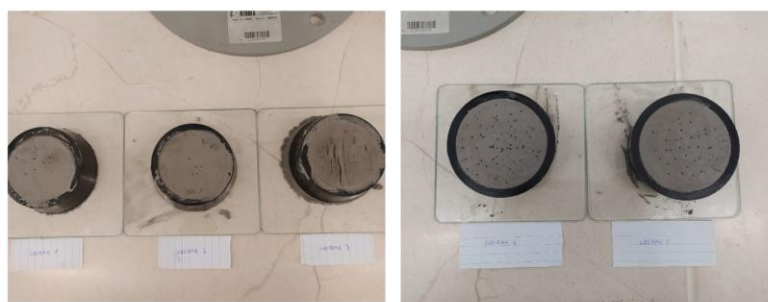
Slika 20. Određivanje vremena vezanja Vicatovim aparatom
