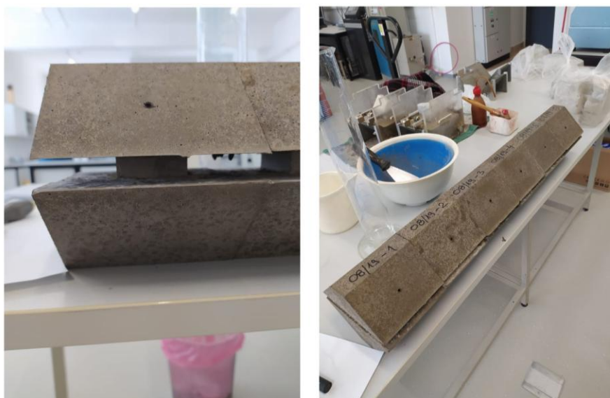
Slika 7. Uzorci spremni za smicanje
