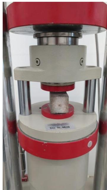
Slika 14. Određivanje tlačne čvrstoće
