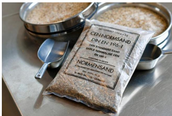
*Slika 16. Standardni laboratorijski pijesak*
