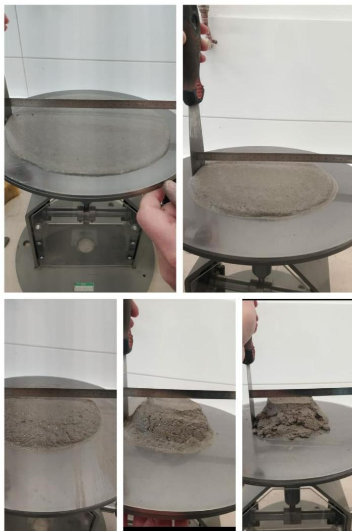
Slika 25. Ispitivanje obradljivosti morta
