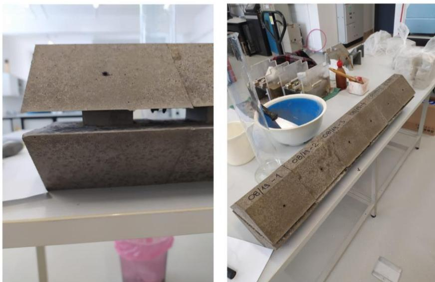
*Slika 7. Uzorci spremni za smicanje*
