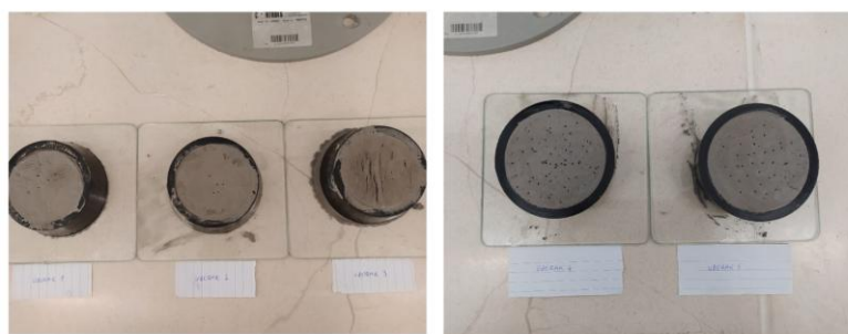
Slika 20. Određivanje vremena vezanja Vicatovim aparatom
