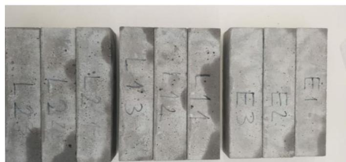
*Slika 27. Prizme spremne za ispitivanje*
