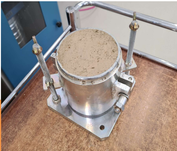
Slika 4.6 Uzorak spreman za konačno vaganje
