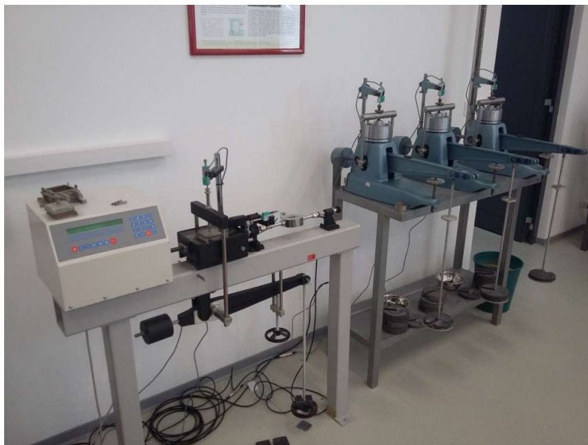
Slika 5.1 Edometri (gore desno) na kojima su se vršila ispitivanja (pokus u tijeku).
