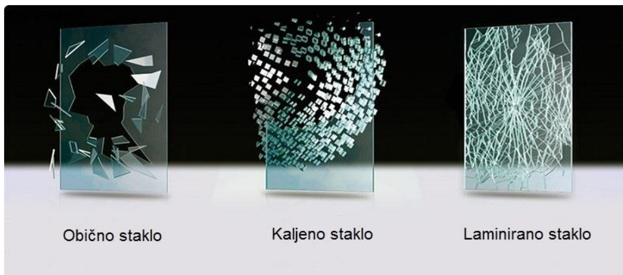
Slika 8. Prikaz loma običnog, kaljenog i laminiranog stakla
