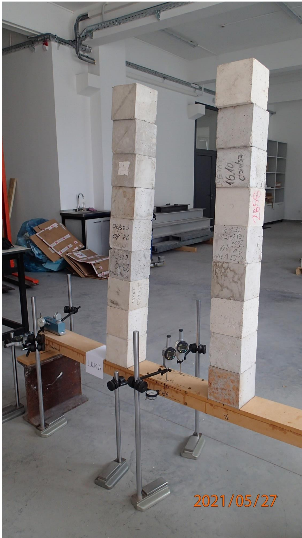
Slika 52: Nosač s devet redova opterećenja, F = 0,72 \text{ kN}
