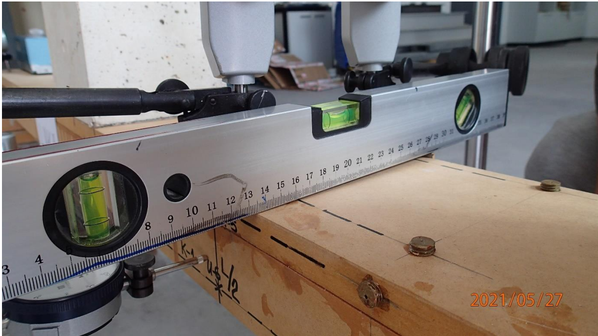
Slika 48: Uvijanje poprečnog presjeka grednog nosača u L/2
