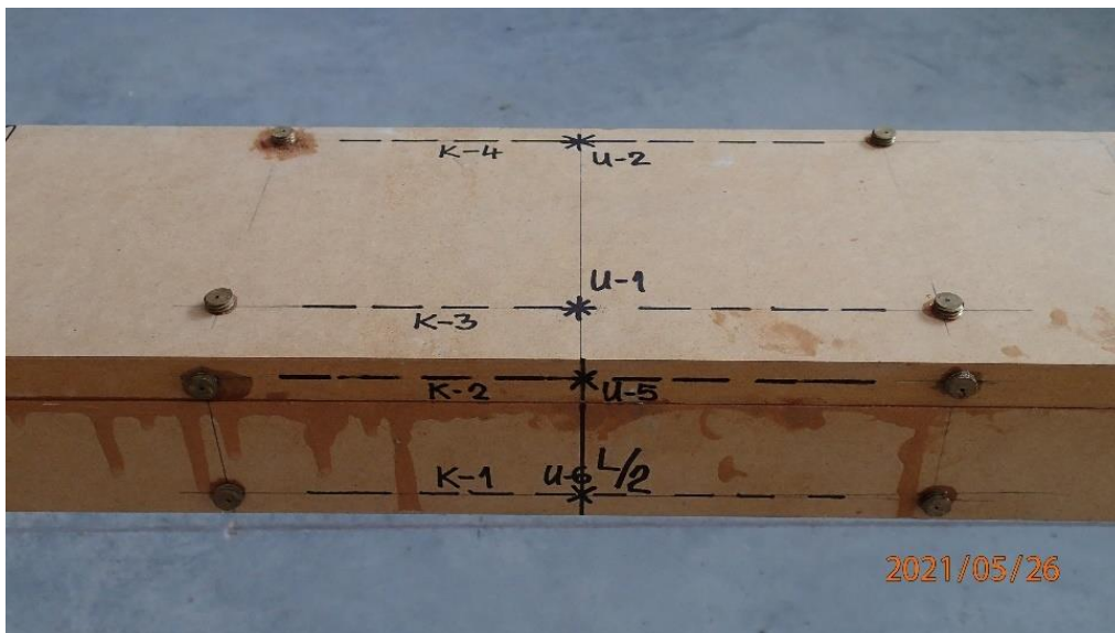
Slika 37: Položaj markica na grednom nosaču
