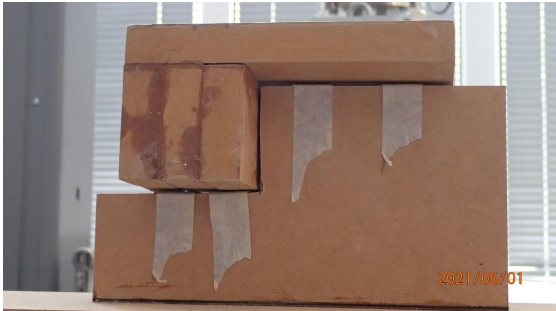
Slika 62: Odizanje poprečnog presjeka kod ležaja
