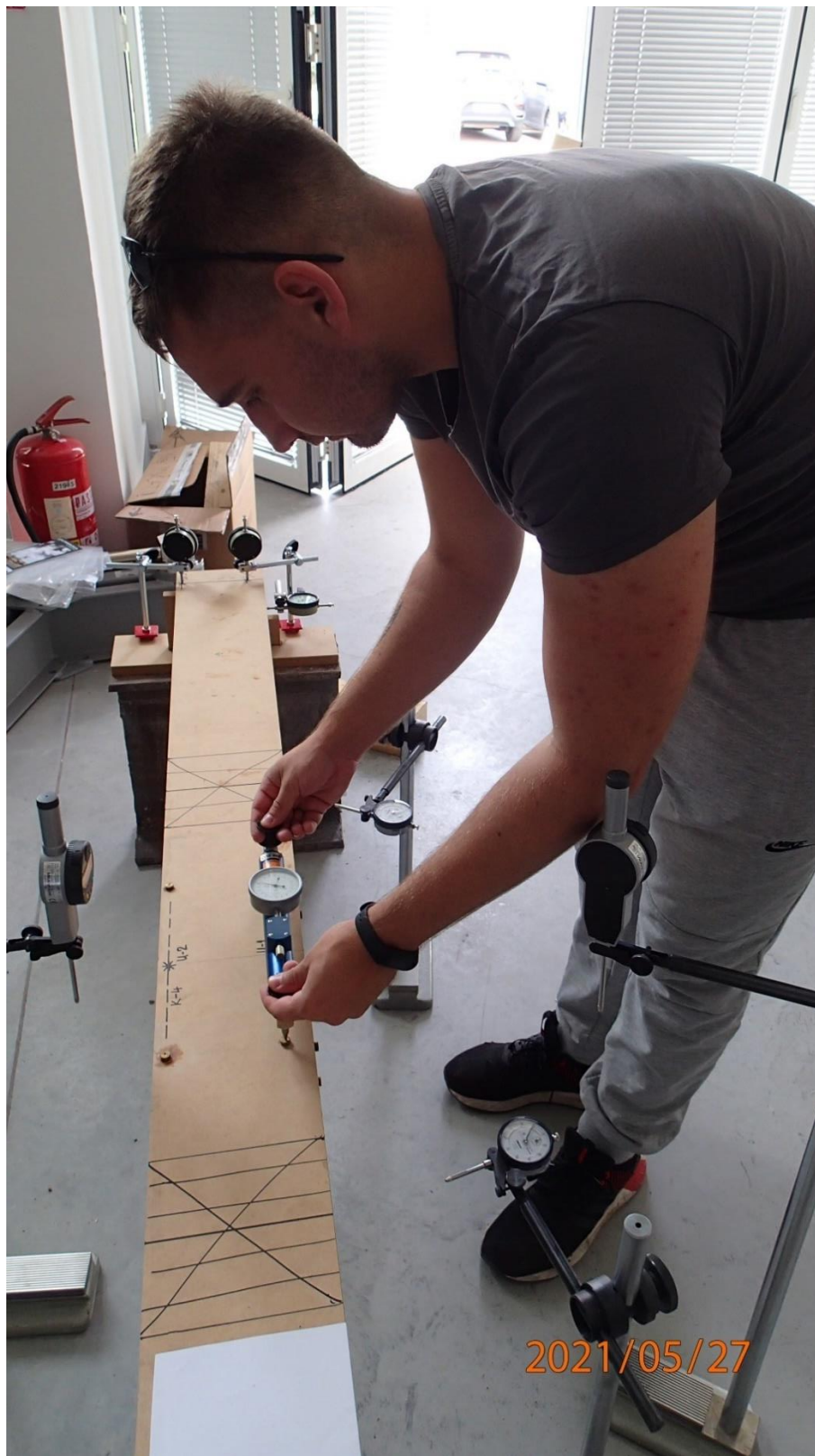
Slika 38: Mjerenje deformacija pomoću Barry-evog prijenosnog komparatora
