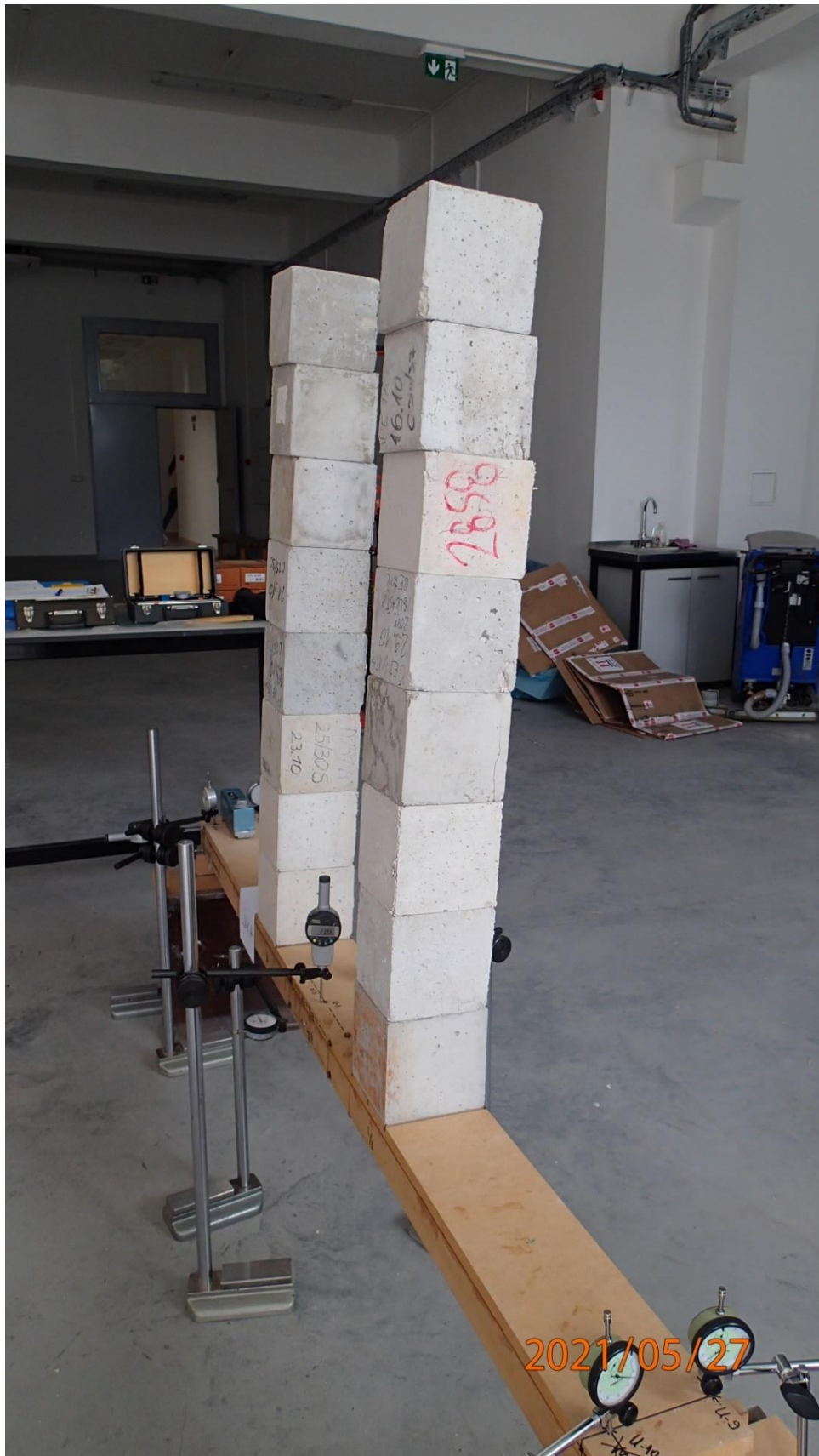
Slika 51: Prikaz uvijanja poprečnog presjeka nosača
