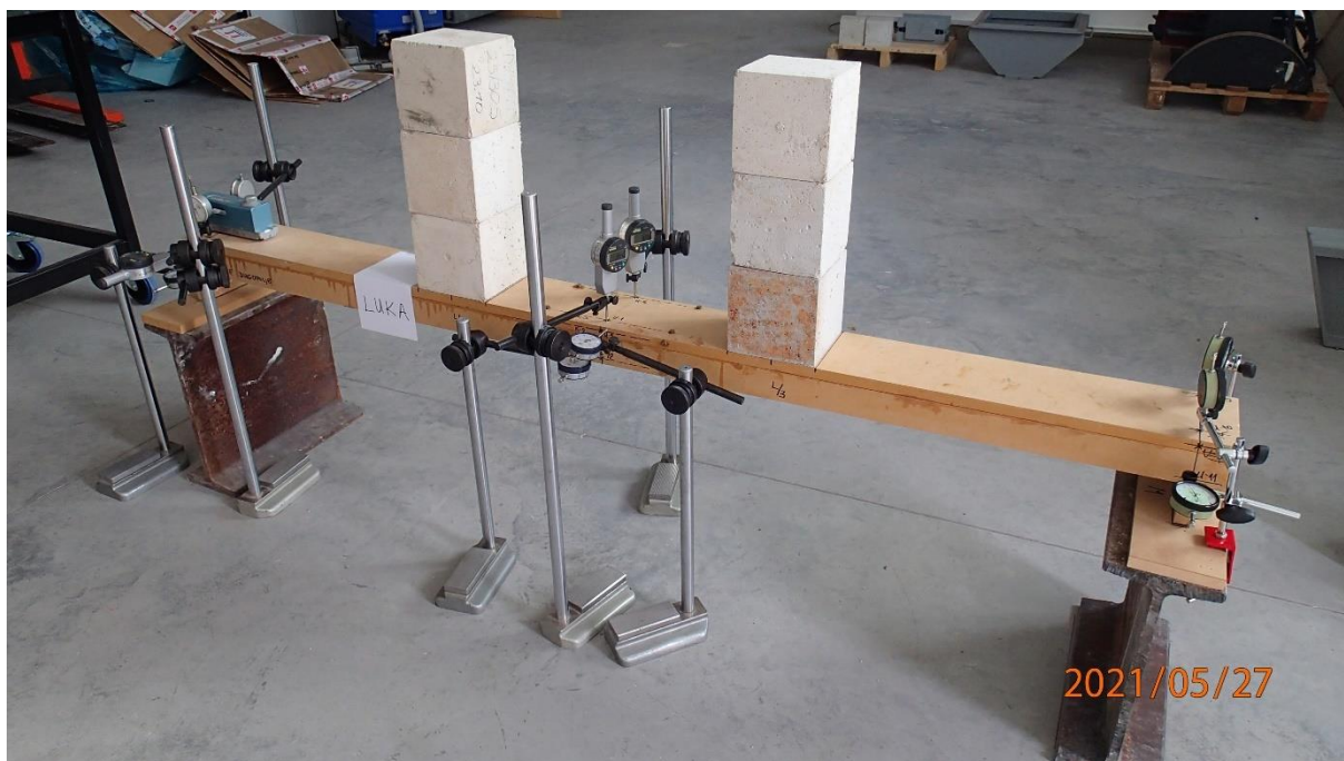
Slika 42: Nosač s tri reda opterećenja, F = 0,24 \text{ kN}
