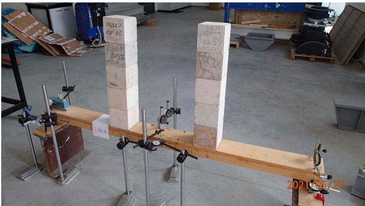
Slika 45: Nosač s pet redova opterećenja, F = 0,40 kN
