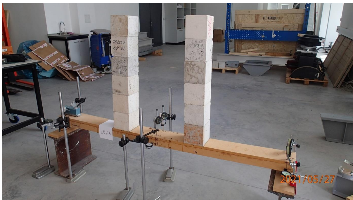
Slika 47: Nosač sa šest redova opterećenja, F = 0,48 \text{ kN}
