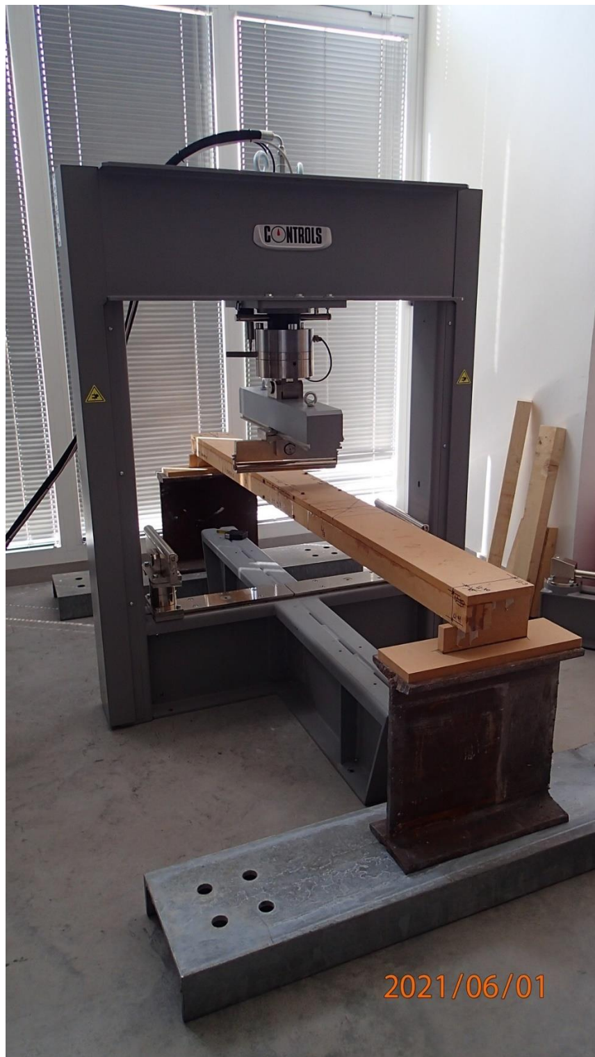
Slika 57: Priprema grednog nosača za ispitivanje na uređaju AUTOMAX MULTITEST Computerized Control Console
