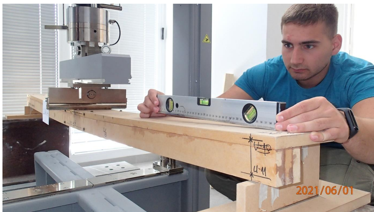
Slika 60: Vidljiva znatna promjena kuta nagiba nosača za silu F = 1,13 kN
