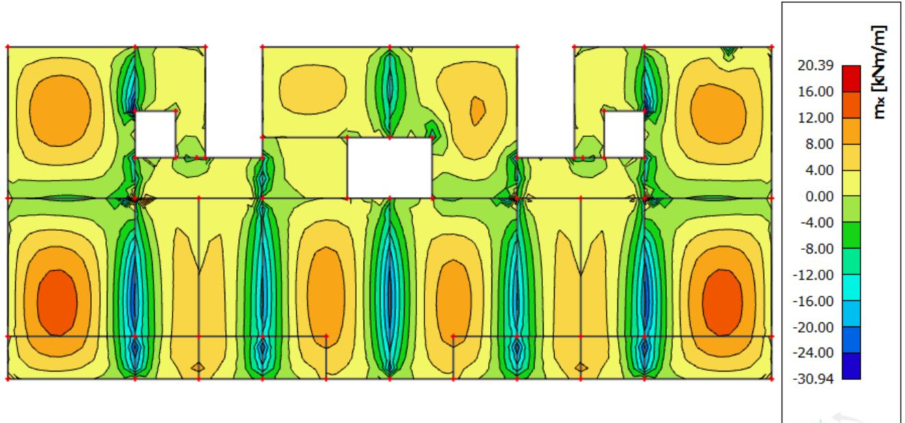
Slika 7.19 Moment savijanja  $M_{Ed,x}$  (kNm/m) za GSU-1
