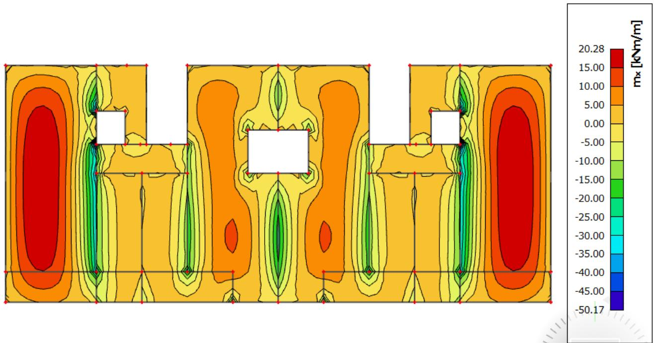
Slika 7.17 Moment savijanja  $M_{Ed,x}$  (kNm/m) za GSU-1
