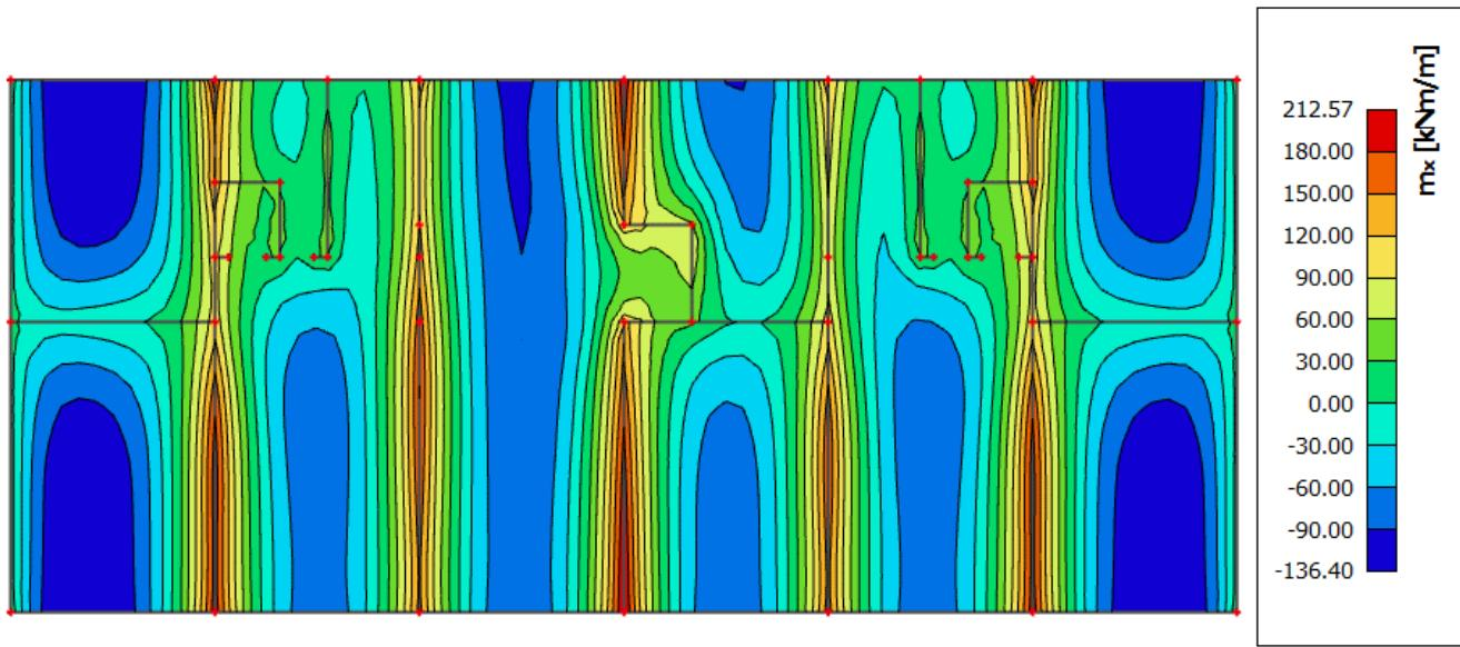
Slika 8.13 Moment savijanja  $M_{Ed,x}$  (kNm/m) za GSU-1
