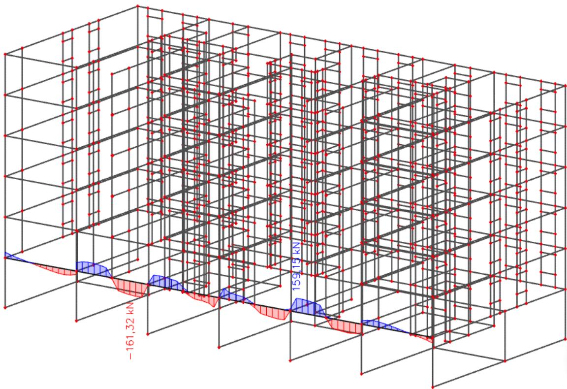
Slika 9.8 Poprečne sile  $V_{Ed,z}$  (kN) za GSN-1
