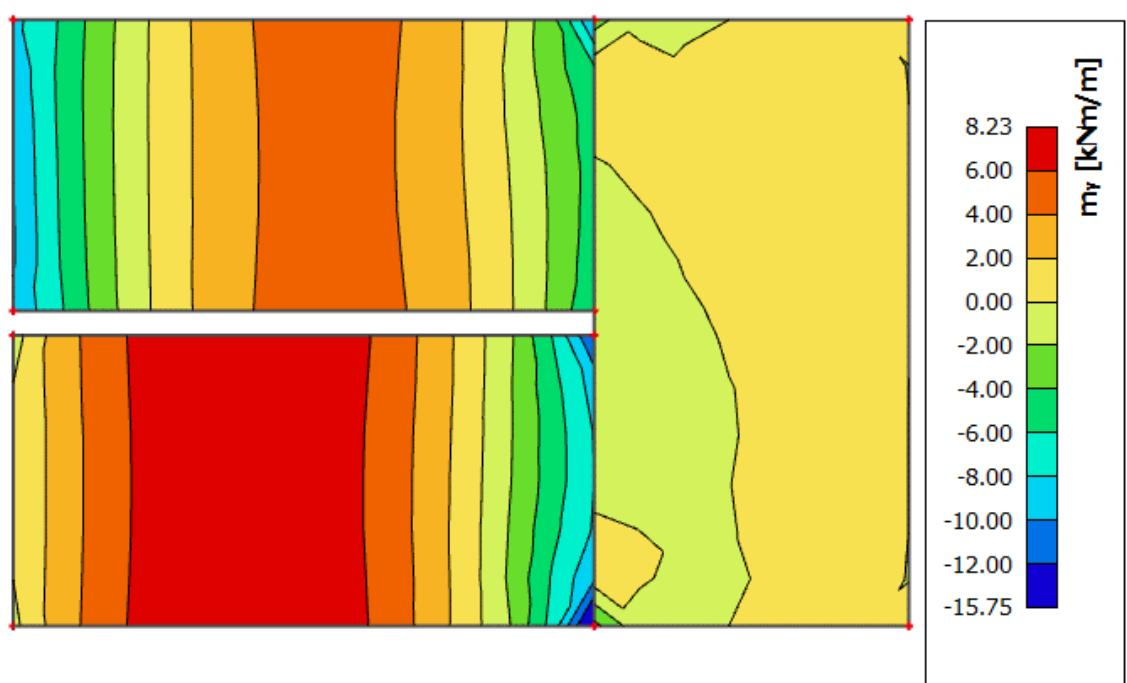
Slika 12.3 Moment savijanja  $M_{Ed,y}$  ( $\text{kNm}/\text{m}$ ) za GSN-1
