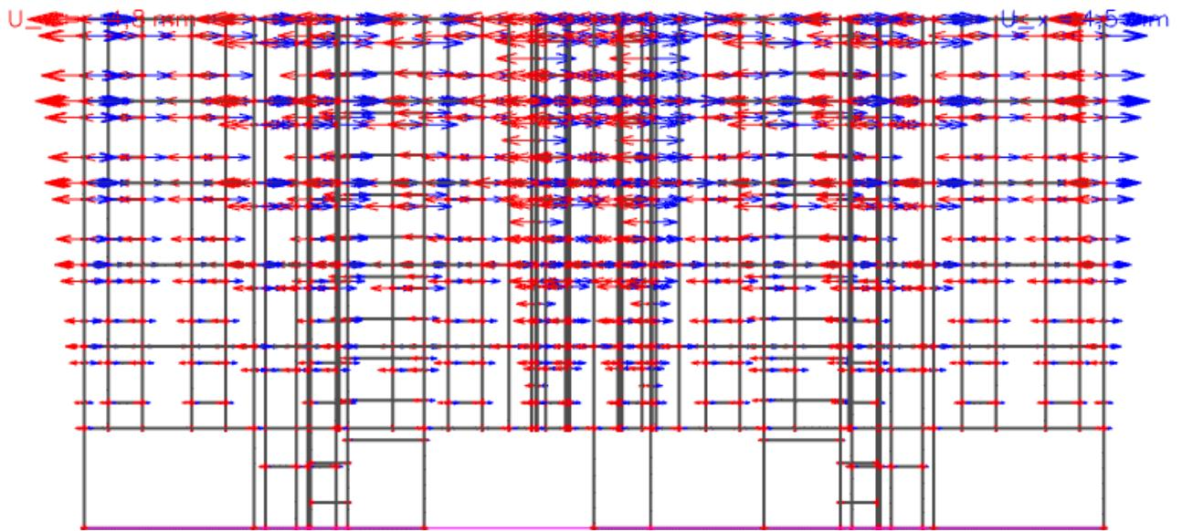
Slika 11.2 Prikaz pomaka konstrukcije (mm) u smjeru x od potresne kombinacije GSN<sub>Sx</sub>
