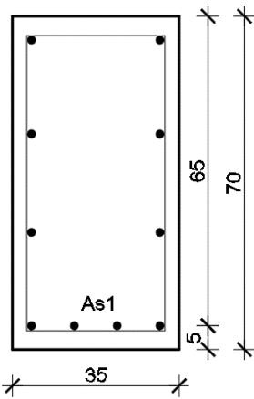
Slika 9.9 Poprečni presjek grede
