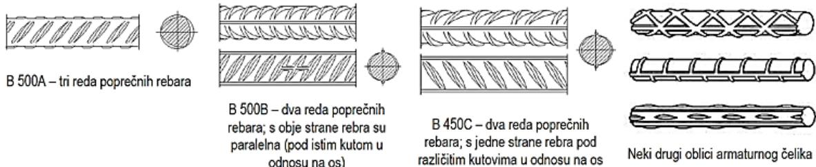
Slika 2.2 Oblici čelika za armiranje
