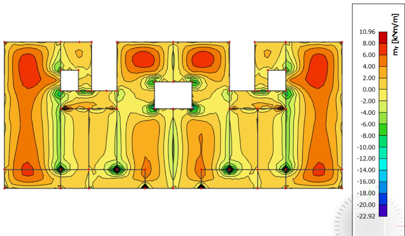
Slika 7.18 Moment savijanja  $M_{Ed,y}$  (kNm/m) za GSU-1
