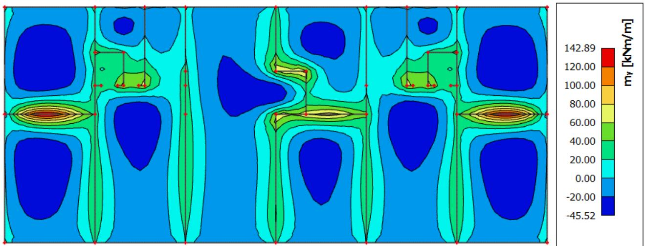
Slika 8.14 Moment savijanja  $M_{Ed,y}$  (kNm/m) za GSU-1
