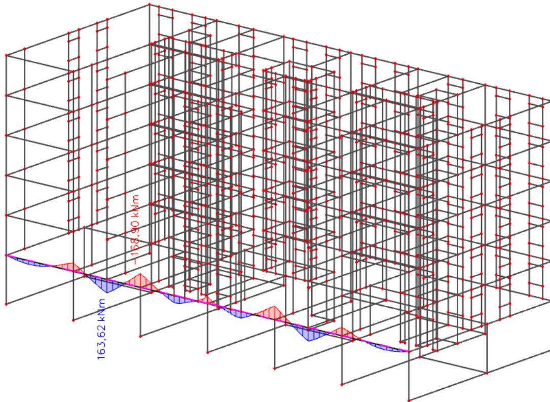
Slika 9.12 Moment savijanja  $M_{Ed,y}$  (kNm) za GSU-1
