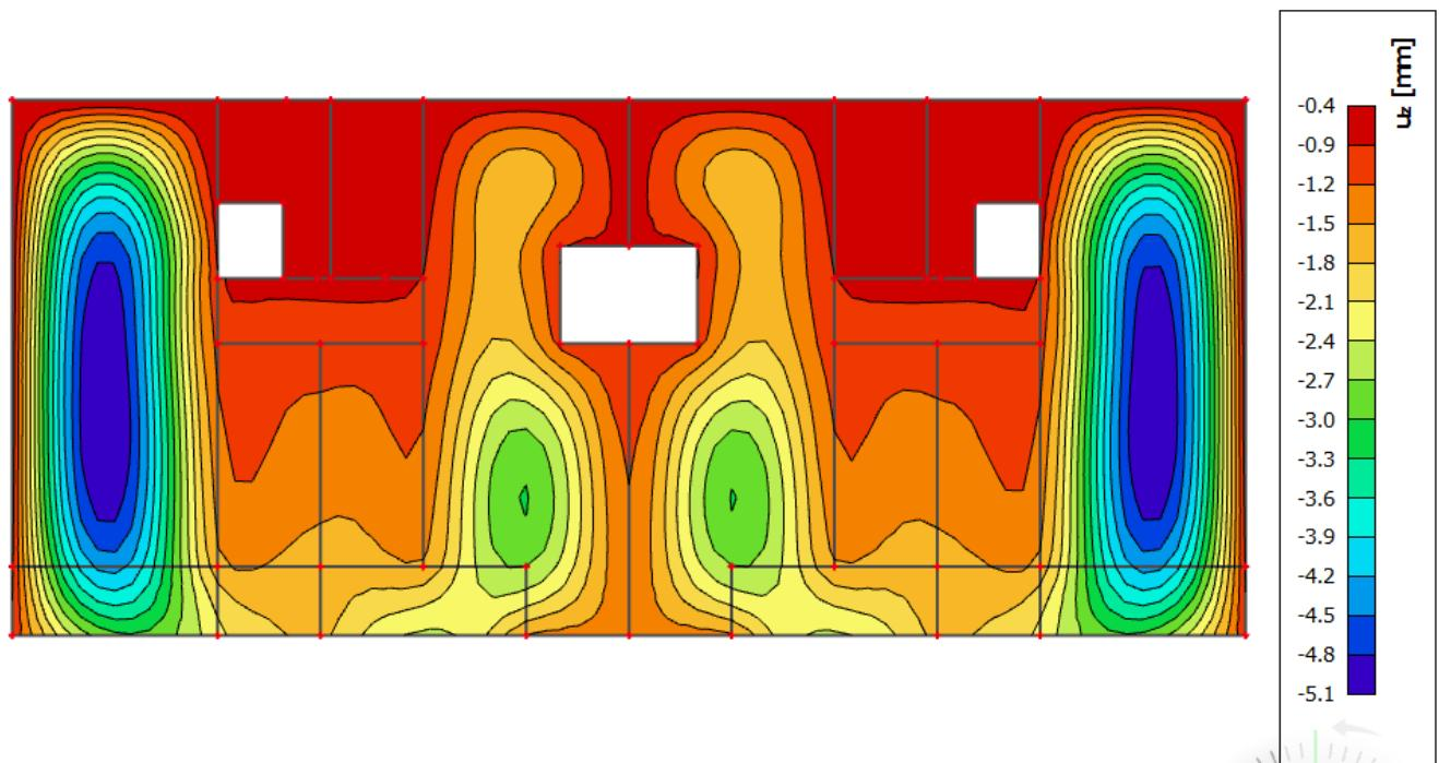
Slika 6.8 Progib krovne ploče (mm) za kombinaciju GSU-1
