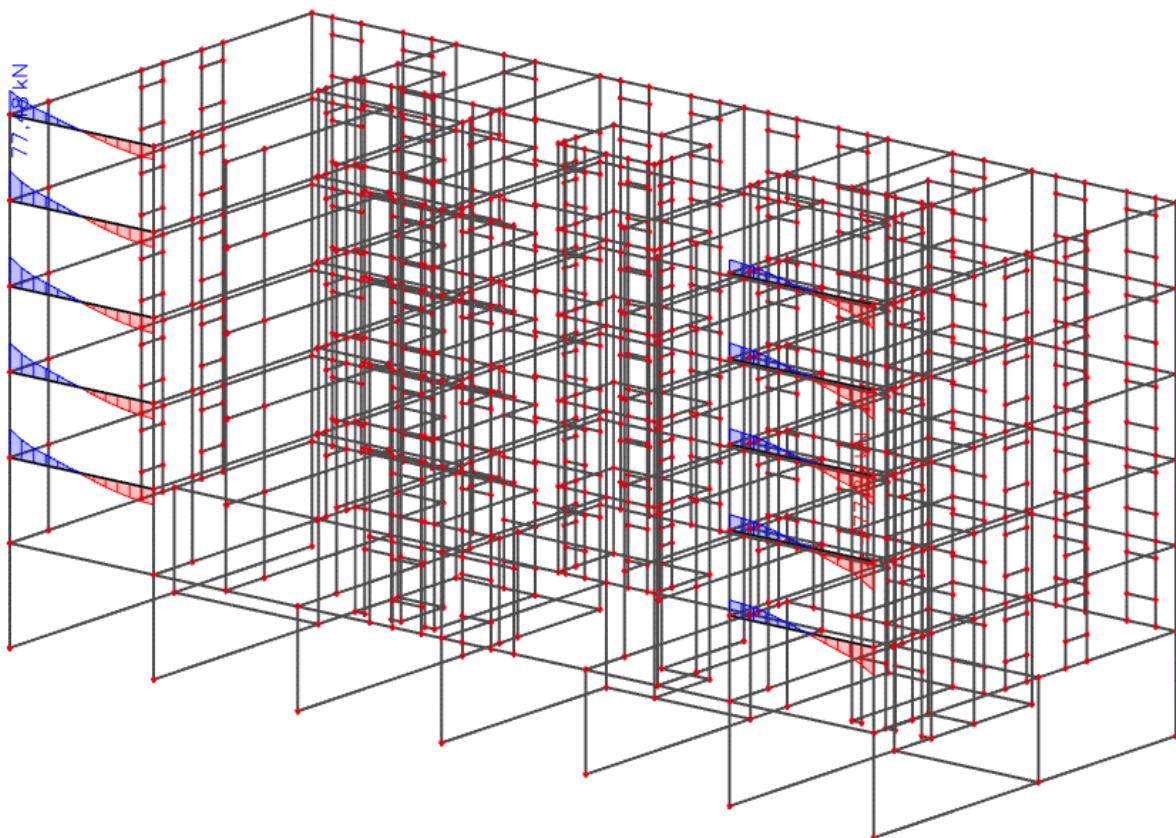
Slika 9.2 Poprečne sile  $V_{Ed,z}$  (kN) za GSN-1
