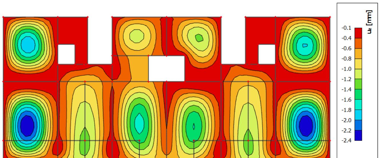
Slika 7.16 Progib međukatne ploče 1. etaže (mm) za kombinaciju GSU-2
