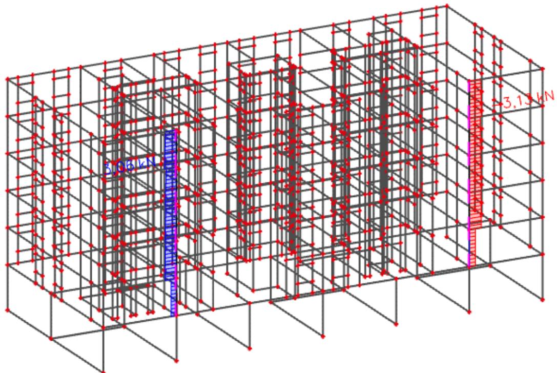
Slika 10.9 Poprečna sila  $V_{Ed}$  (kN) za GSN-Sy
