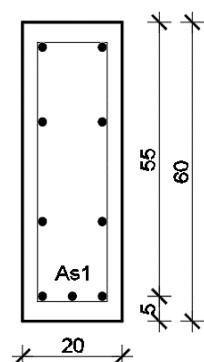
Slika 9.3 Poprečni presjek grede
