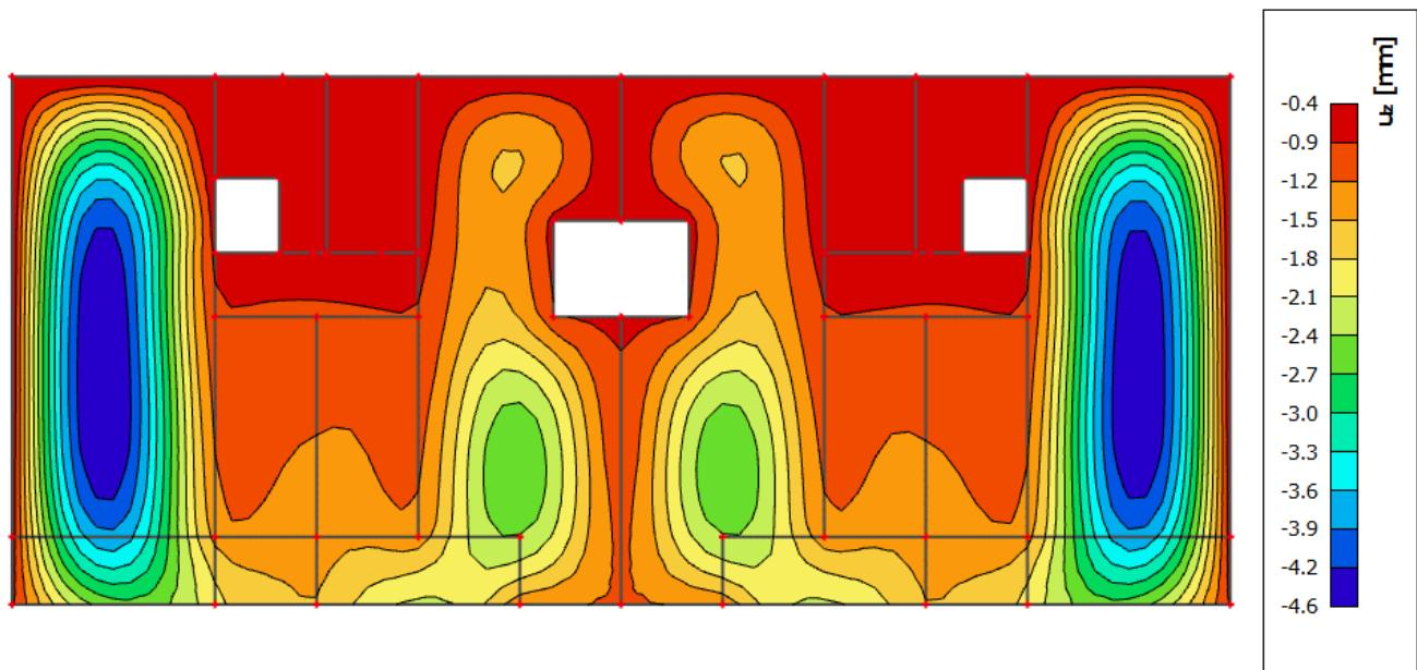
Slika 6.9 Progib krovne ploče (mm) za kombinaciju GSU-2
