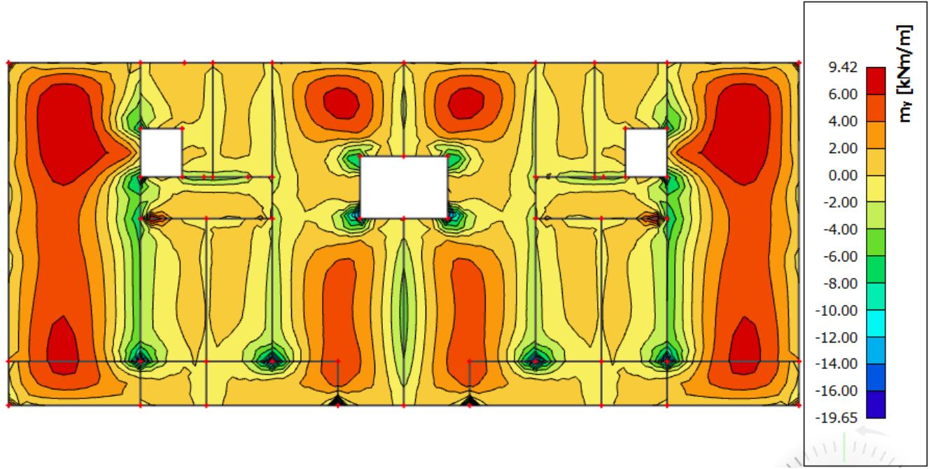
Slika 6.11 Moment savijanja  $M_{Ed,y}$  (kNm/m) za GSU-1
