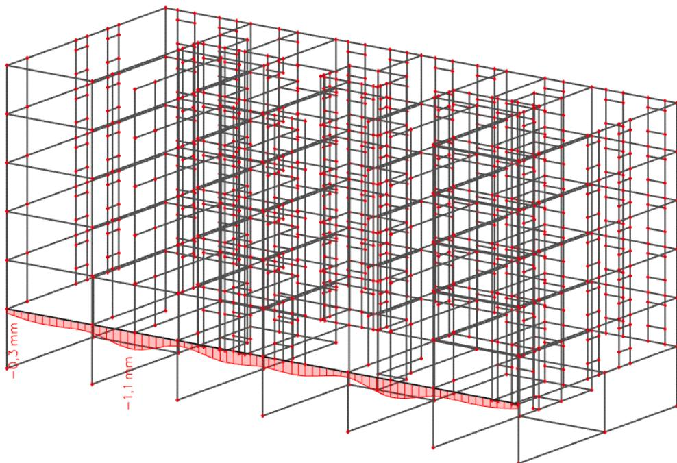
Slika 9.11 Progib ab grede (mm) za kombinaciju GSU-2
