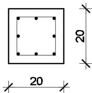
Slika 10.10 Poprečni presjek stupa
