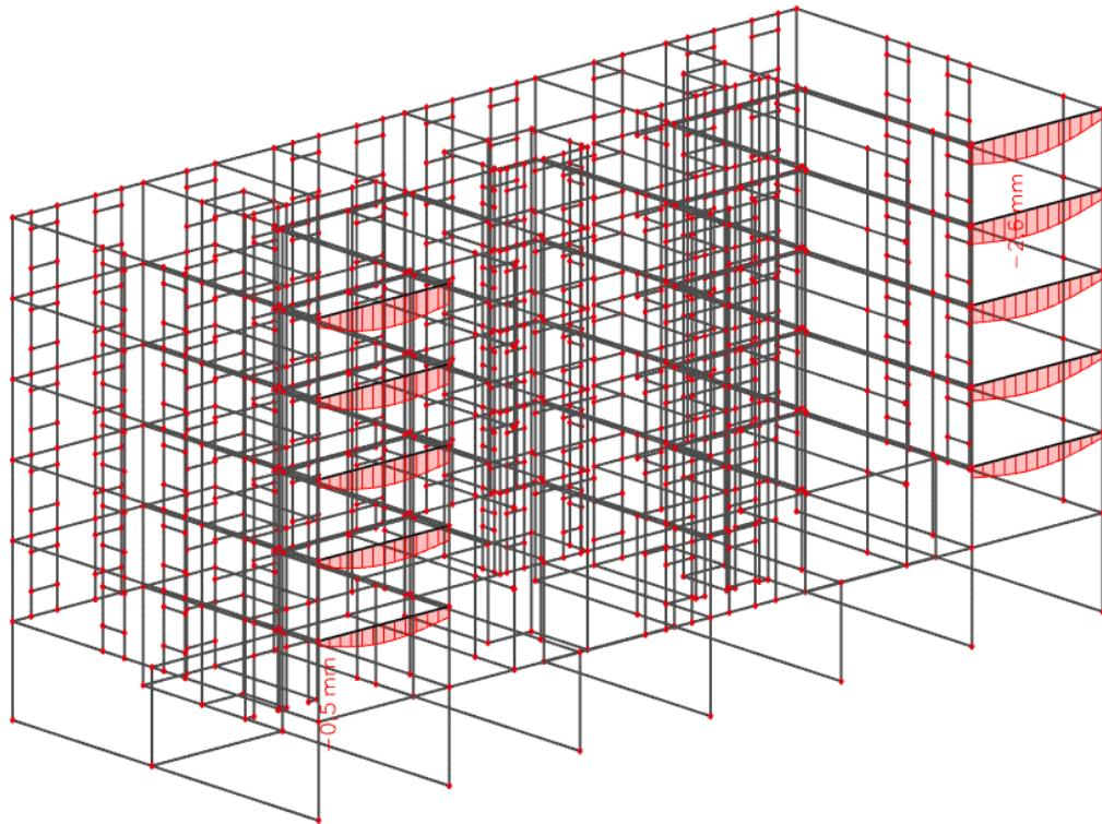
Slika 9.5 Progib ab grede (mm) za kombinaciju GSU-2
