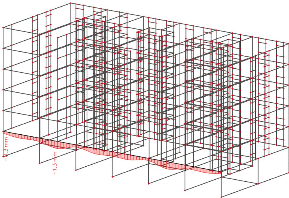
Slika 9.10 Progib ab grede (mm) za kombinaciju GSU-1
