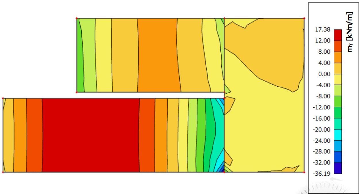
Slika 12.11 Moment savijanja  $M_{Ed,y}$  ( $\text{kNm}/\text{m}$ ) za GSN-1
