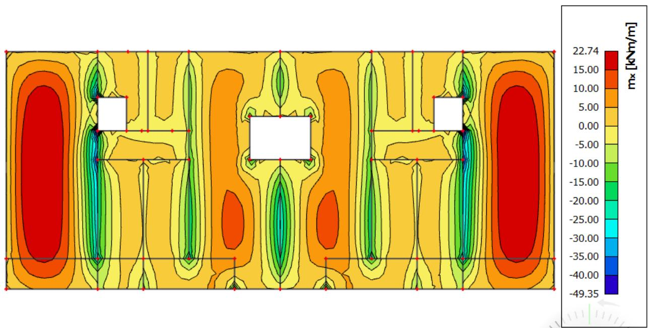
Slika 6.10 Moment savijanja  $M_{Ed,x}$  (kNm/m) za GSU-1
