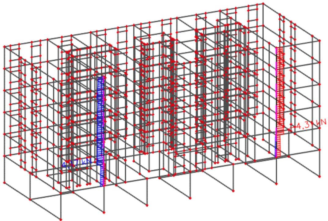
Slika 10.6 Poprečna sila  $V_{Ed}$  (kN) za GSN-Sx
