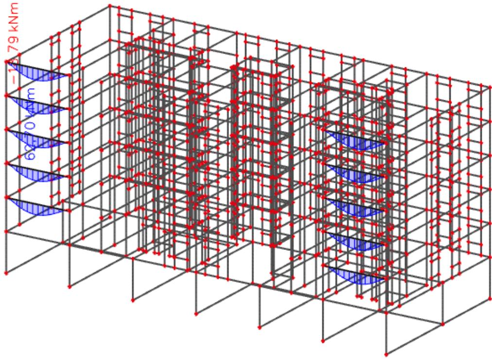
Slika 9.6 Moment savijanja  $M_{Ed,y}$  (kNm) za GSU-1
