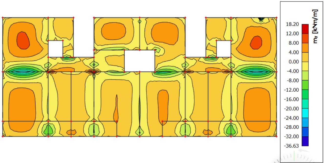
Slika 7.20 Moment savijanja  $M_{Ed,y}$  (kNm/m) za GSU-1
