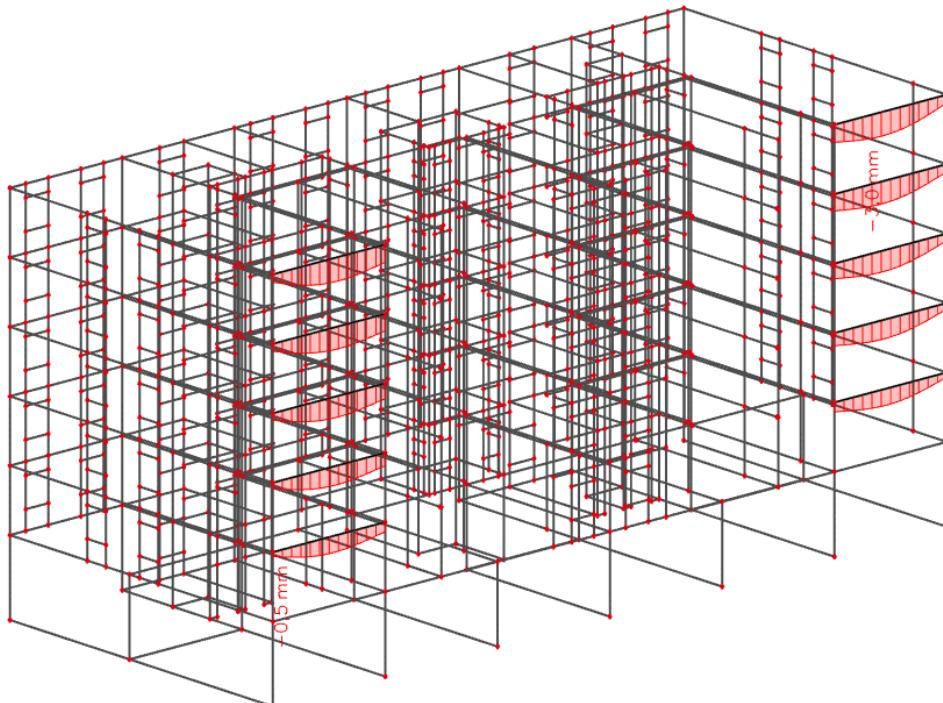
Slika 9.4 Progib ab grede (mm) za kombinaciju GSU-1
