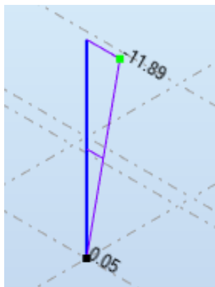
Slika 68. Maximalni moment savijanja M_z za proračun stupa, GSN_Sx
