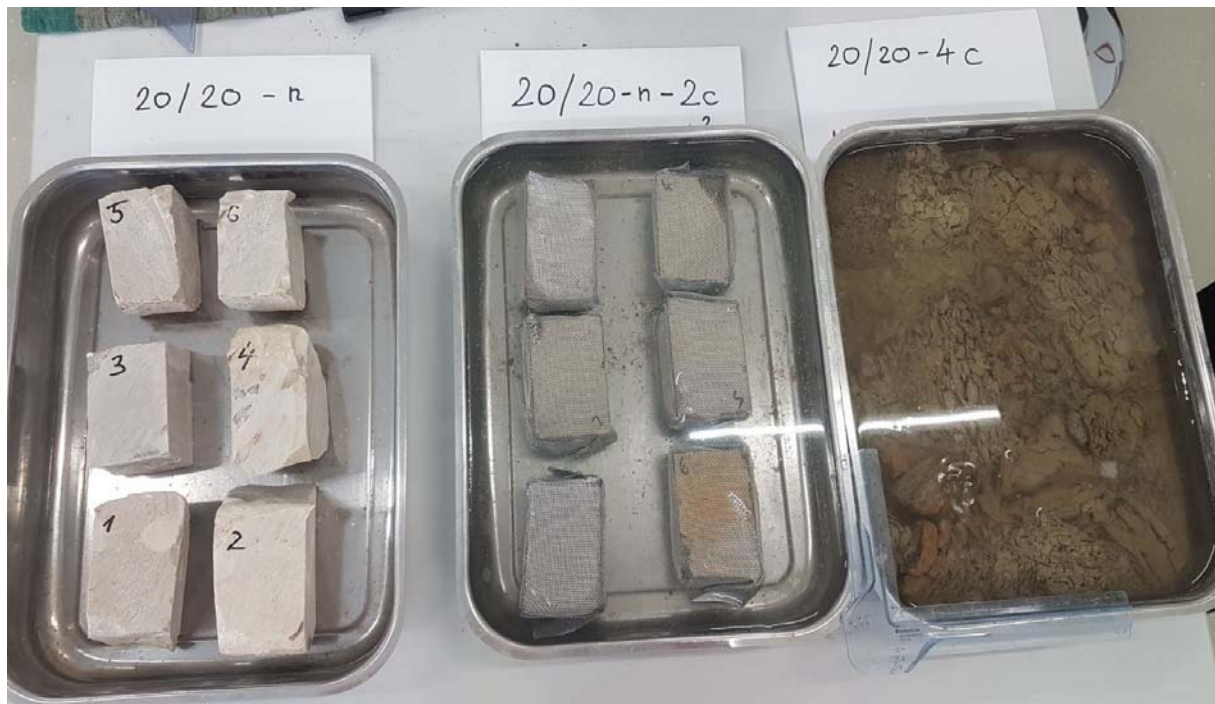
Slika 7. Prikaz tri faze rastrošbe u laboratoriju
