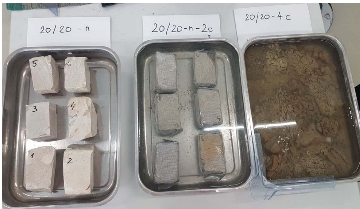
Slika 7. Prikaz tri faze rastrošbe u laboratoriju
