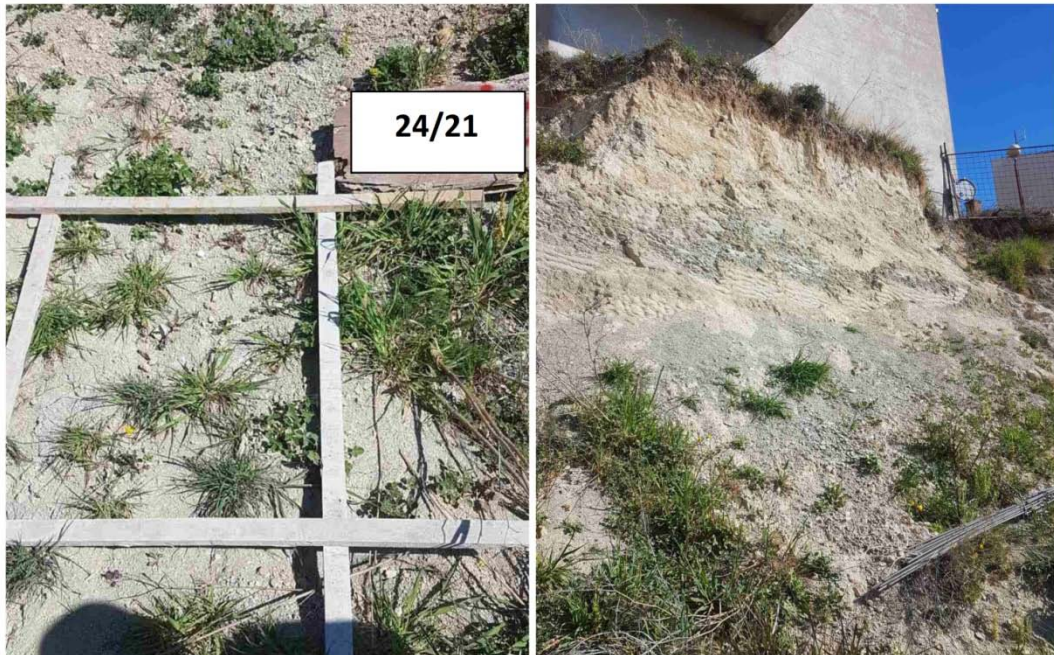
Slika 3. Uzimanje uzoraka s terena i prikaz kosine čija će se stabilnost analizirati
