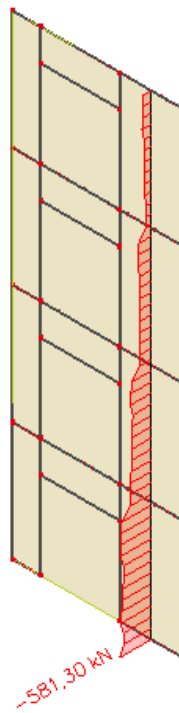
Slika 150. Uzdužne sile u zidu Zy1 (kN)
