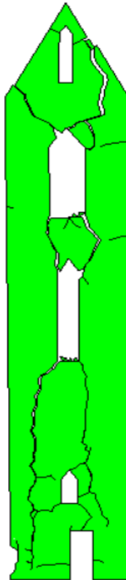
Slika 6.12. Prikaz trenutka urušavanja reprezentativnog modela zvonika.
