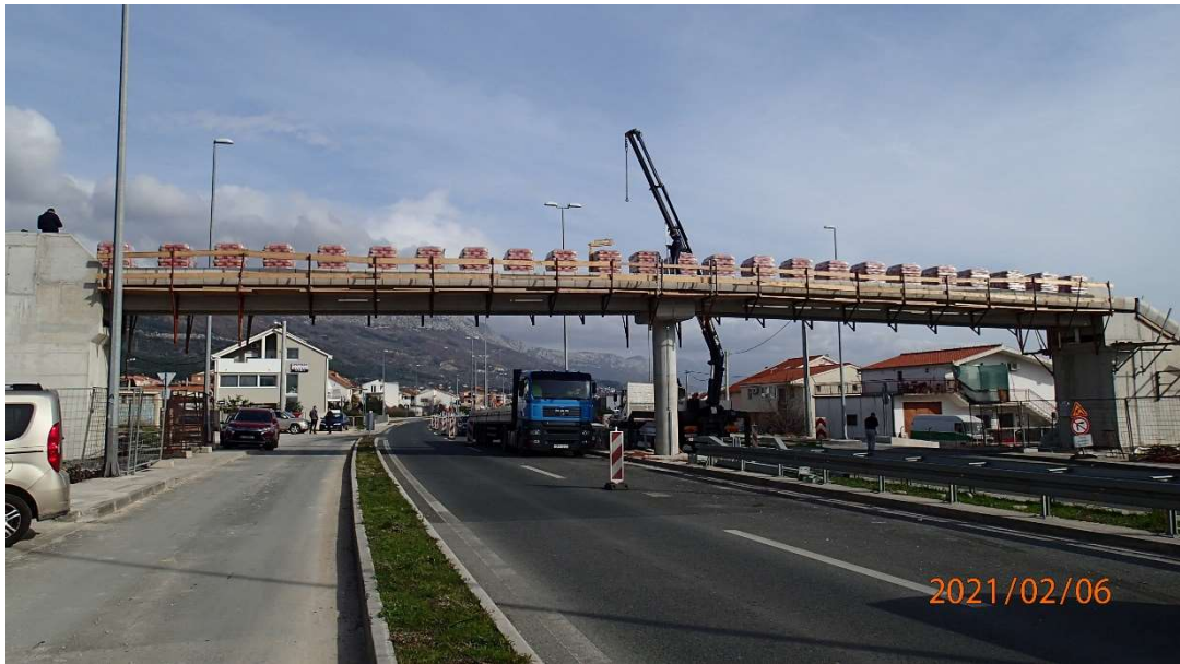
Slika 4.10. Faza 5 – opterećenje na oba raspona
