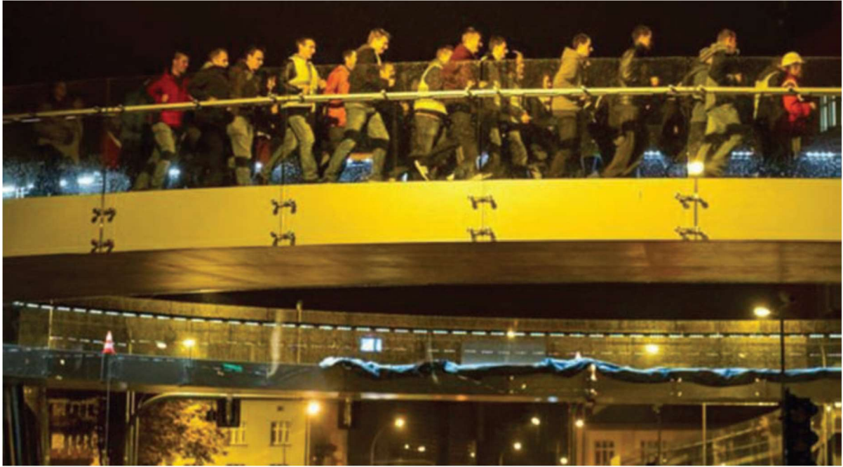
Slika 2.4. Dinamičko ispitivanje – ljudska navala-sporo trčanje [4]
