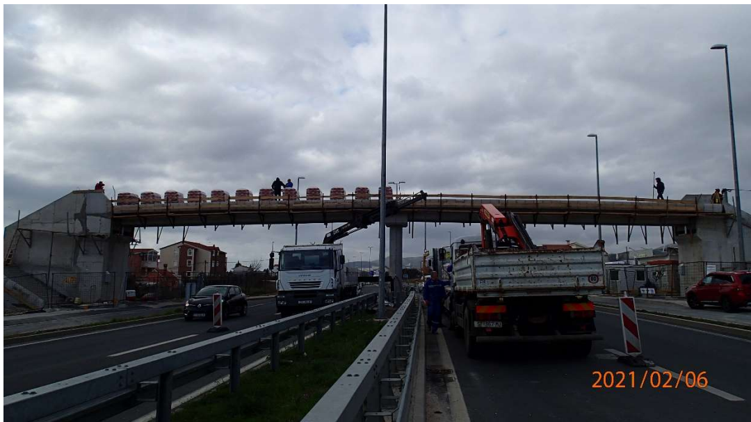
Slika 4.9. Faza 3 – opterećenje na južnom rasponu
