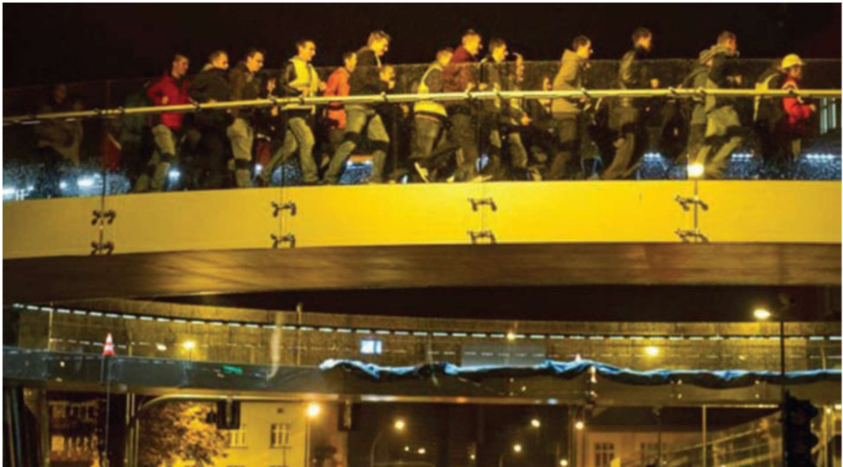
Slika 2.4. Dinamičko ispitivanje – ljudska navala-sporo trčanje [4]
