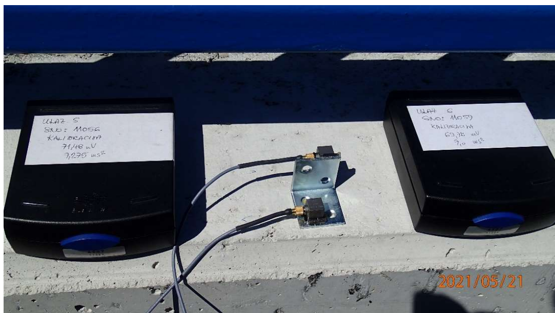
Slika 4.14. Jednoosni akcelometri za mjerenje dinamičkih veličina
