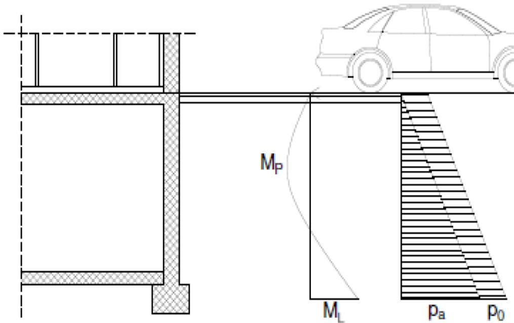
Slika 8.1. Prikaz opterećenja na obodni zid garaže
