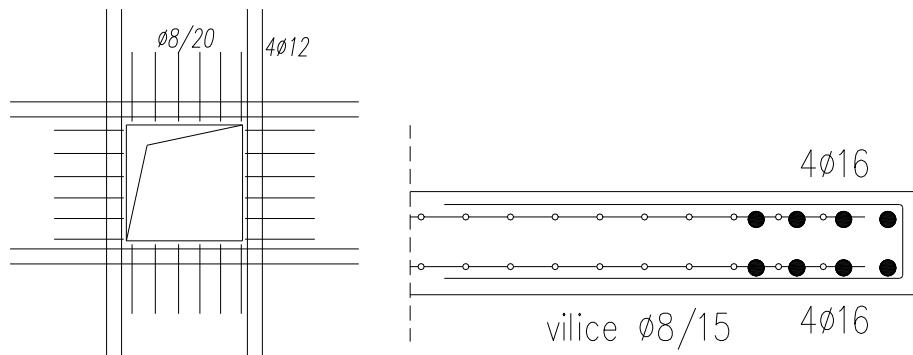
Slika 6.32. Desno: Skica armiranja slobodnog ruba ploče; Lijevo: Skica armirnja otvora većih od  $50 \times 50 \text{ cm}$
