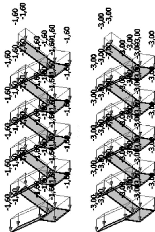
Slika 9.1. Dodatno stalno i pokretno opterećenje ( $\text{kN}/\text{m}^2$ )
