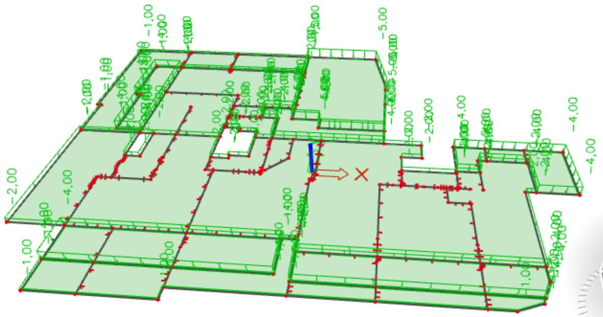
Slika 6.50. Pokretno opterećenje ( $\text{kN}/\text{m}^2$ )
