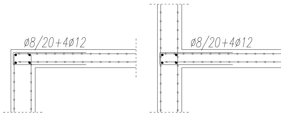
Slika 6.48. Detalj armiranja spoja ploča/vanjski zid
