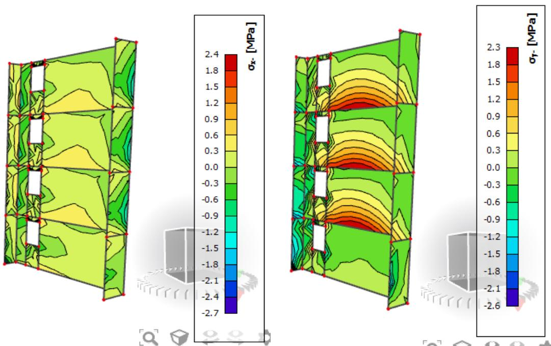
Slika 7.9. Naprezanja u x i y smjeru
