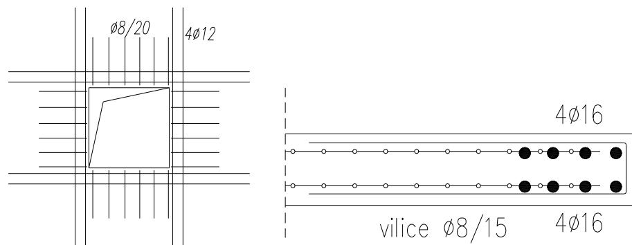
Slika 6.47. Desno: Skica armiranja slobodnog ruba ploče; Lijevo: Skica armiranja otvora većih od 50x50 cm
