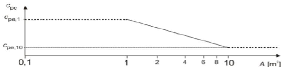
Ako je površina na koju vjetar djeluje manja od  $10 m^2$ , uzima se  $c_{pe,1}$ , a ako je veća od  $10 m^2$ , uzima se  $c_{pe,10}$ .
