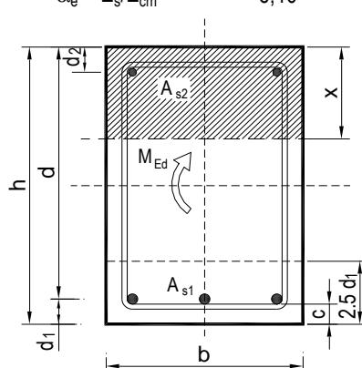
**Poziciju G202, b/h = 20/45:** Admirati sa  $3\varnothing 14$  u donjoj i  $3\varnothing 14$  u gornjoj zoni. Razdjelna armatura  $4\varnothing 12$ . Vilice  $\varnothing 10/25$ , iznad ležaja vilice progustiti na  $\varnothing 10/20$ .
