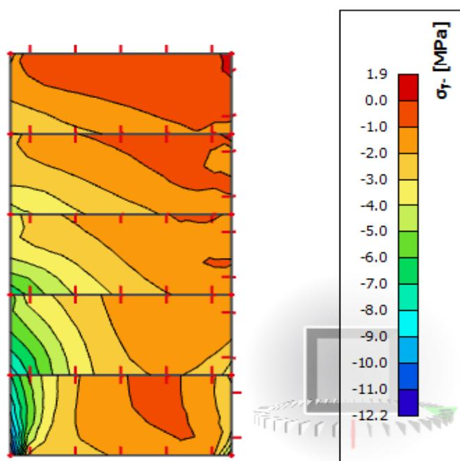
Slika 7.6. Naprezanja u y smjeru
