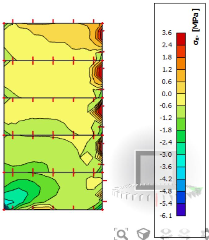
Slika 7.5. Naprezanja u x smjeru
