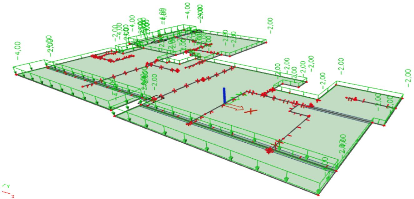
Slika 6.35. Pokretno opterećenje ( $\text{kN}/\text{m}^2$ )
