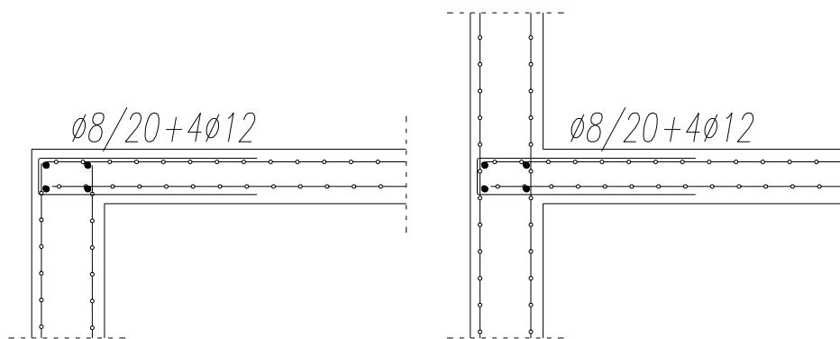
*Slika 6.17. Detalj armiranja spoja ploča/vanjski zid*
