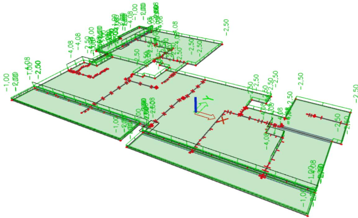
Slika 6.34. Dodatno stalno opterećenje ( $\text{kN}/\text{m}^2$ )
