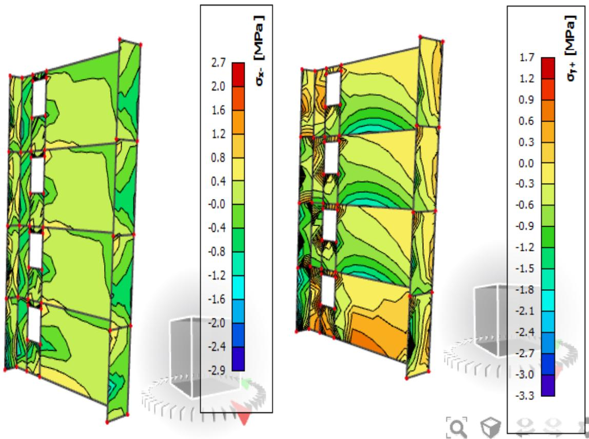
Slika 7.10. Naprezanja u  $x$  i  $y$  smjeru
