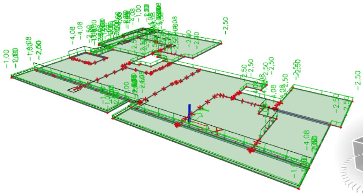
Slika 6.18. Dodatno stalno opterećenje ( $\text{kN}/\text{m}^2$ )
