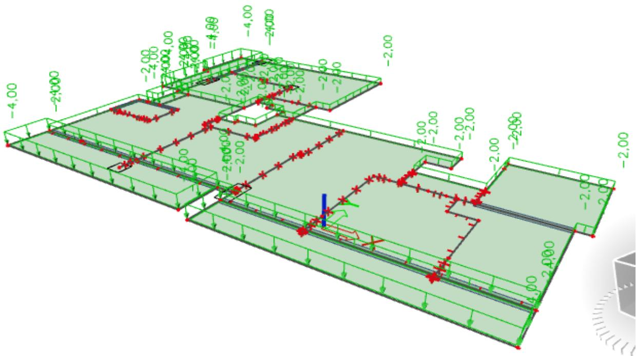
Slika 6.19. Pokretno opterećenje ( $\text{kN}/\text{m}^2$ )
