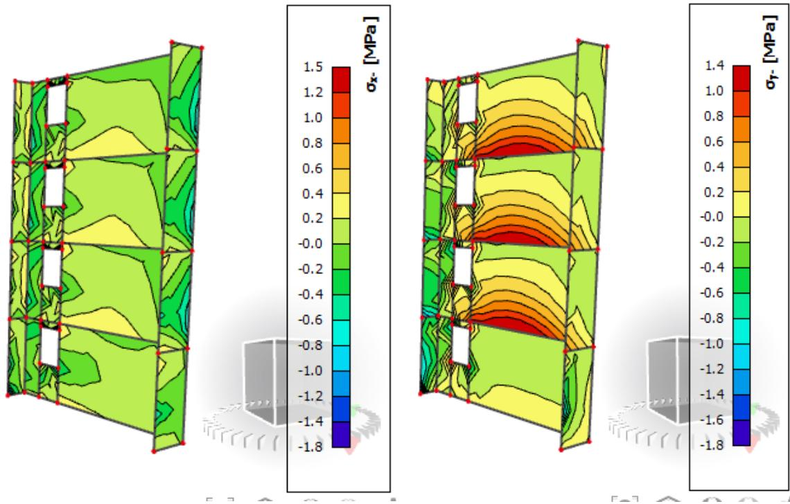
Slika 7.8. Naprezanja u x i y smjeru
