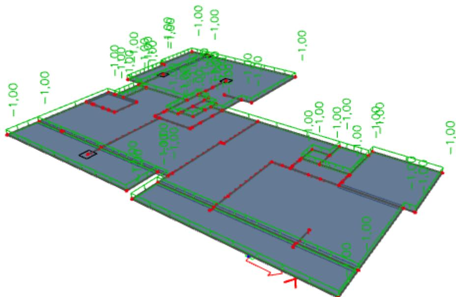
Slika 6.2. Pokretno opterećenje ( $\text{kN}/\text{m}^2$ )
