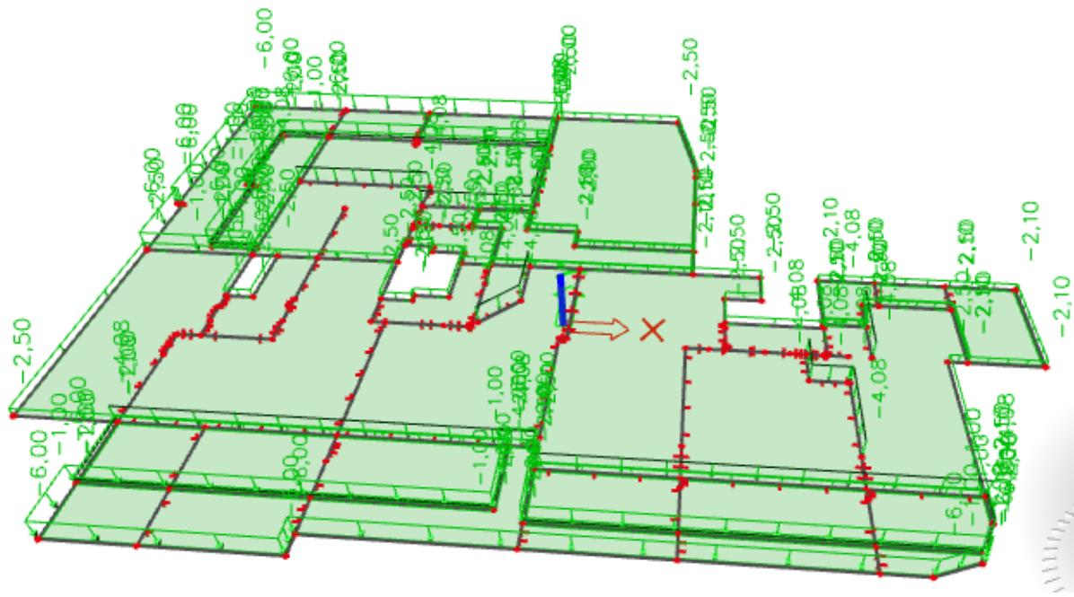
Slika 6.49. Dodatno stalno opterećenje ( $\text{kN}/\text{m}^2$ )
