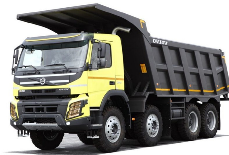
Slika 2.3 Kamion kiper Volvo FMX 460 8X4 [13]
